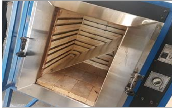
Figura 54. Horno para tratamiento térmico.
