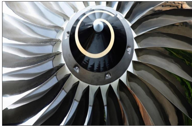
Figura 5. Alabes forjados con níquel y titanio.
