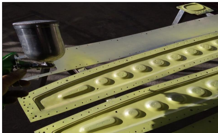
Figura 55. Aplicación de capa anticorrosiva.
