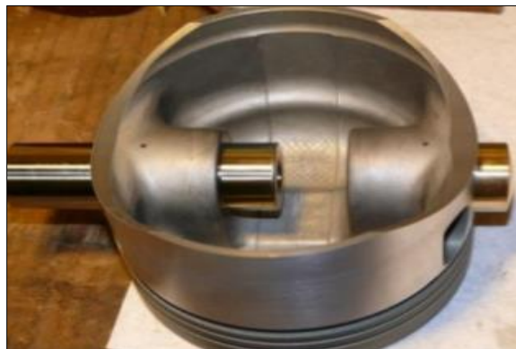
Figura 10. Vista interior de un pistón
