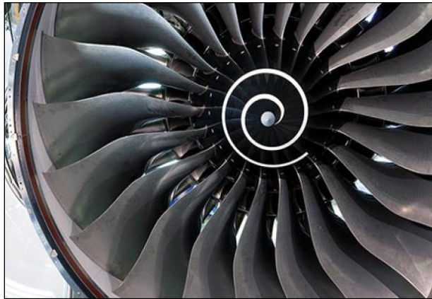
Figura 14. Uso de titanio en motores.
