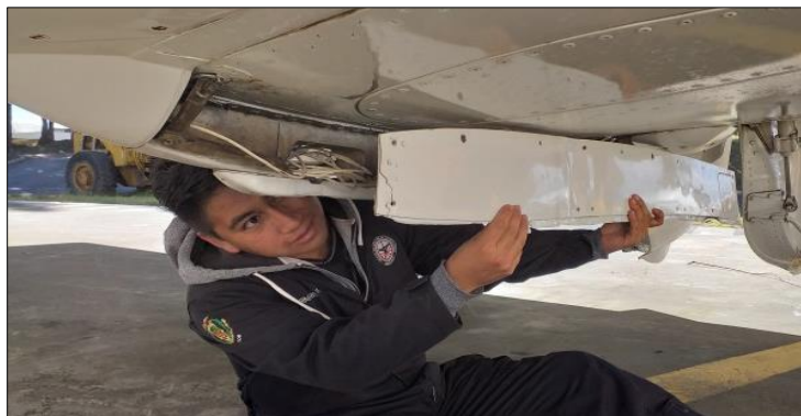
Figura 43. Remoción de las cubiertas inferiores.
