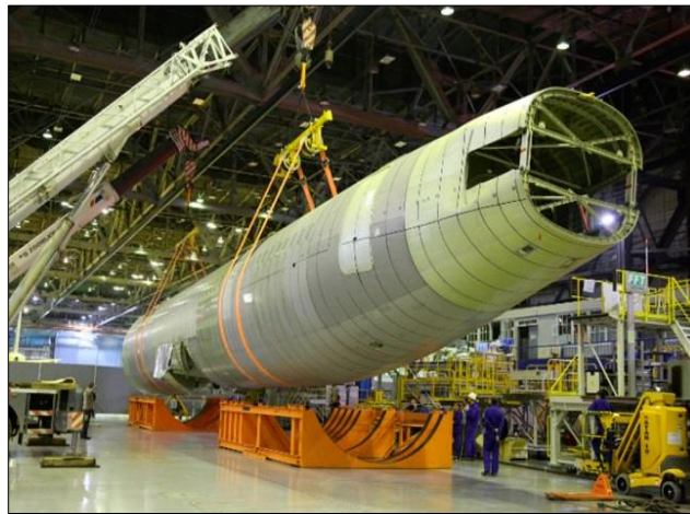
Figura 8. Ensamblaje del fuselaje.
