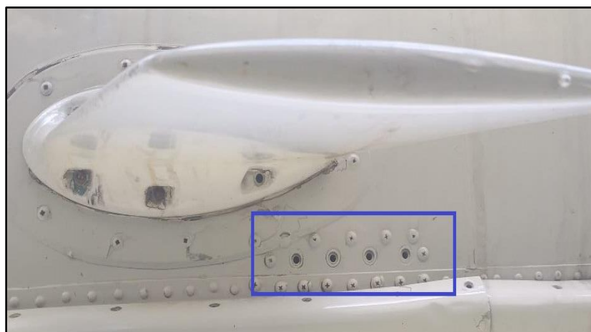
Figura 22. Puntos de drenaje libres
