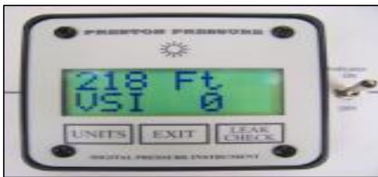
Figura 14. Pantalla de indicación PS 425 Fuente: (Preston Pressure, 2020)
