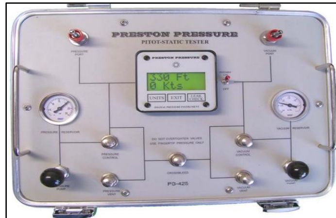
Figura 13. Test pitot estático PS 425 Fuente: (Preston Pressure, 2020)
