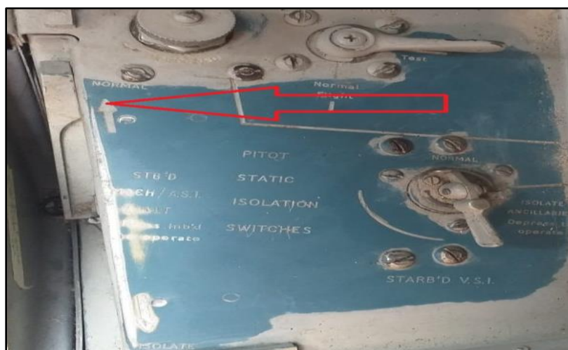
Figura 28. Válvula de aislamiento en posición normal
