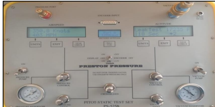
Figura 32. Final test succión al sistema estático
