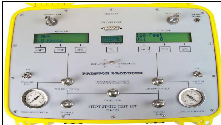
Figura 15. Test para pitot estático PS 525 A Fuente: (Preston Pressure, 2020)
