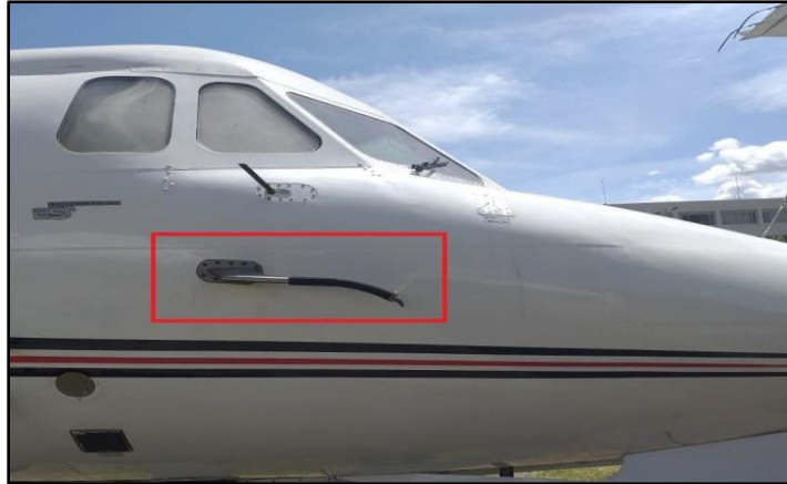
Figura 23. Adaptadores de pitot conectados
