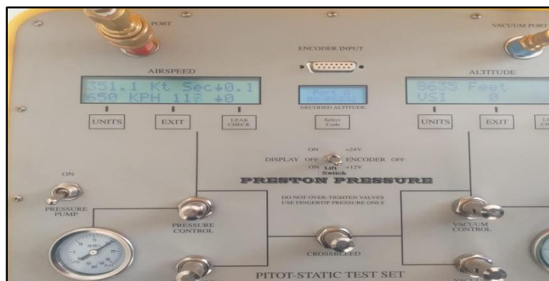
Figura 25. Configurar test de fugas sistema pitot
