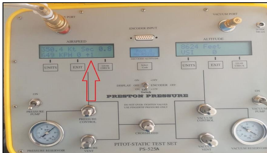
Figura 27. Prueba de fugas por presión completa
