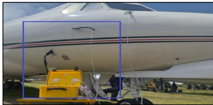
Figura 24. Conexión de cañería de presión
