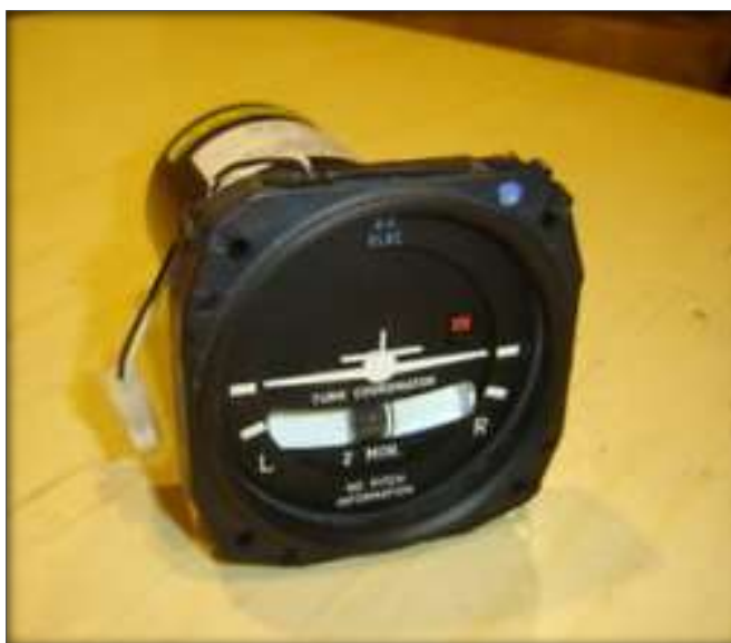
Figura 36 Inspección visual del Coordinador de giro
