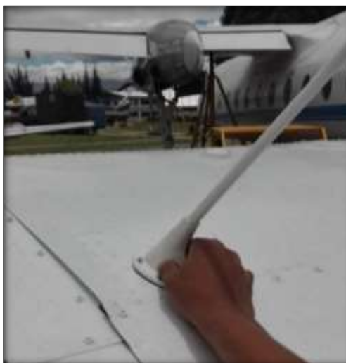
Figura 41 Inspección de la antena VHF
