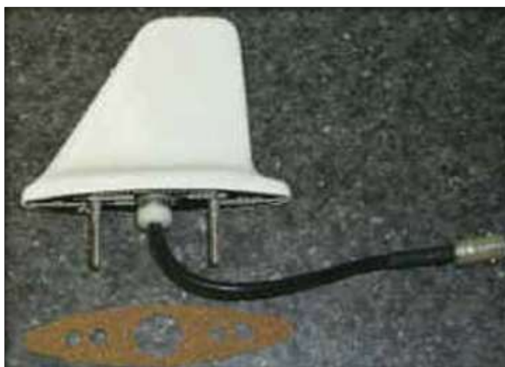
Figura 38 Inspección de los terminales y cable de la Antena
