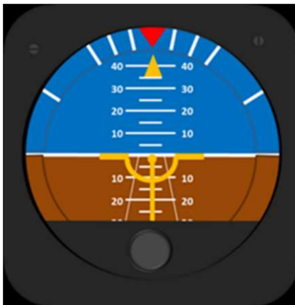
Figura 17 Horizonte artificial Fuente: (Handbook-Airframe, 2012)
