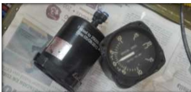
Figura 34 Inspección visual del Indicador de velocidad vertical
