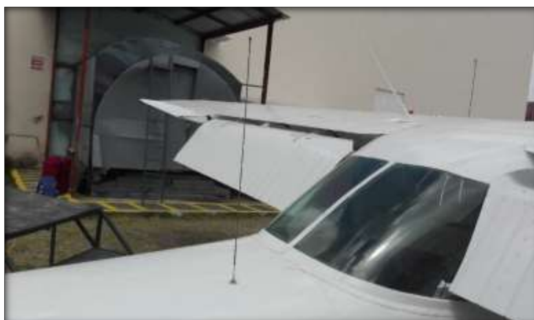
Figura 48 Instalación de la Antena del ELT
