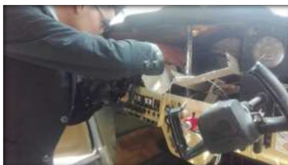
Figura 27 Desinstalación de los instrumentos
