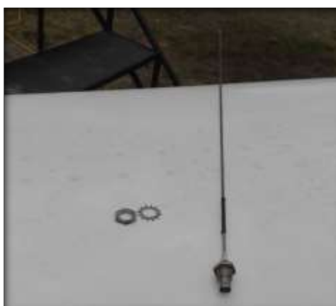
Figura 44 Inspección visual de la antena del ELT
