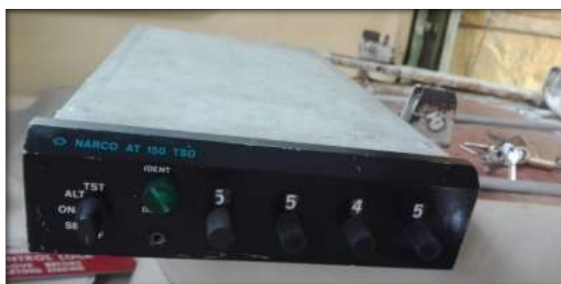
Figura 40 Inspección visual del Transponder
