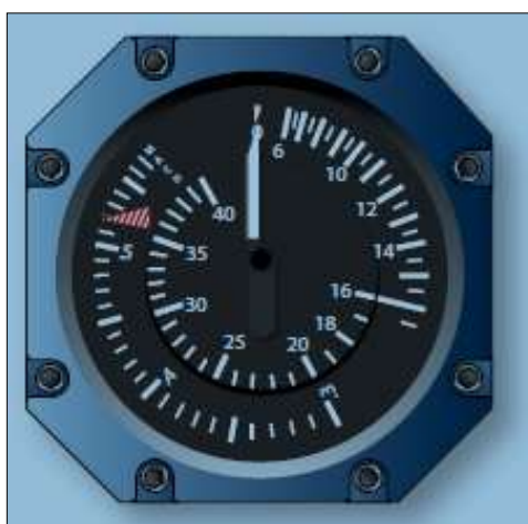
Figura 14 Indicador de velocidad Fuente: (Handbook-Airframe, 2012)
