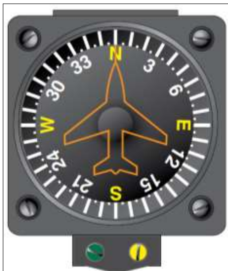
Figura 19 Brújula magnética vertical Fuente: (Handbook-Airframe, 2012)
