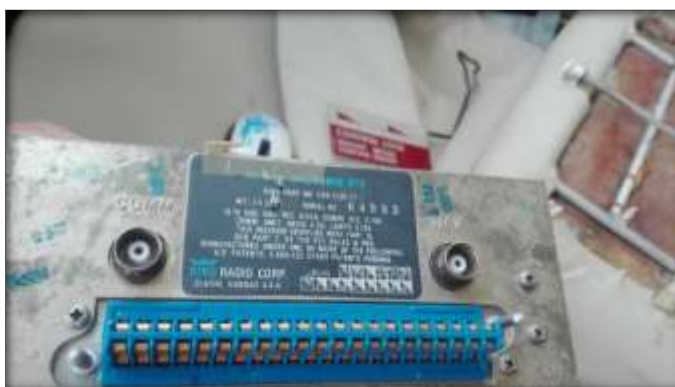
Figura 42 Inspección visual del Nav/Comm
