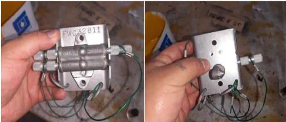
Una vez realizado este procedimiento, prosiga a colocar el último conducto en el inyector para luego empezar con la prueba de flujo, se debe tener en cuenta que el reservorio soporta una presión de aire de 100 psi, sin embargo, para la verificación de flujo se necesita una presión de 60 psi.
