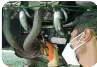
Mangueras de aire frío y caliente
