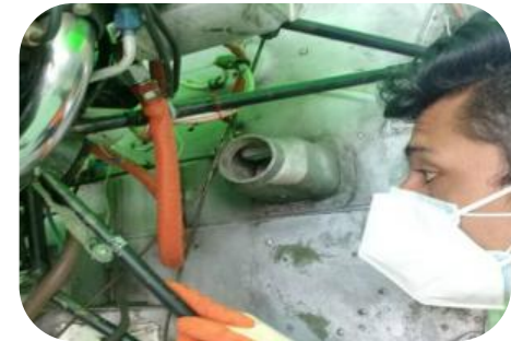
Montantes de choque, estructura montante del motor y correas a tierra
