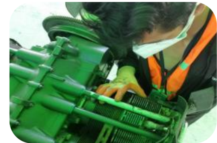
Cilindros, cubierta de la caja de balancines y carcasa de varillas de empuje
