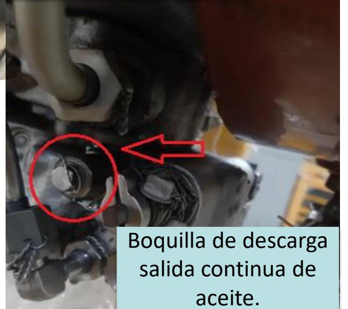
Boquilla de descarga salida continua de aceite.
