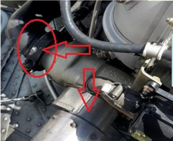
Obturador en la manguera de aire hacia los motores
