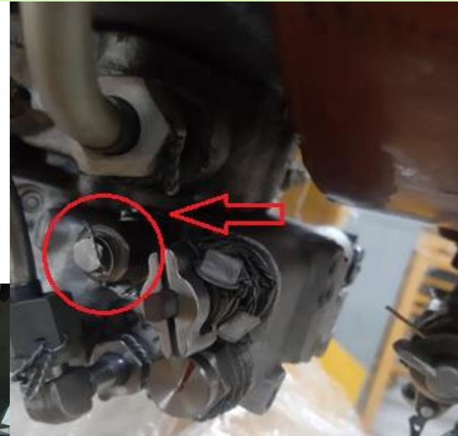
Boquilla de descarga de aire del sistema combustible
