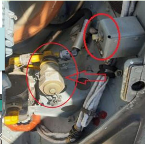
Desacopló el depósito de aceite de la boquilla.
