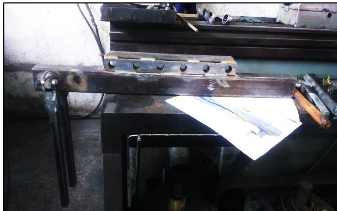
Figura 26 Estructura del power plant sling
