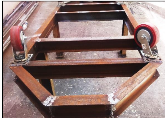
Figura 19 Ensamblaje de las garruchas a la estructura
