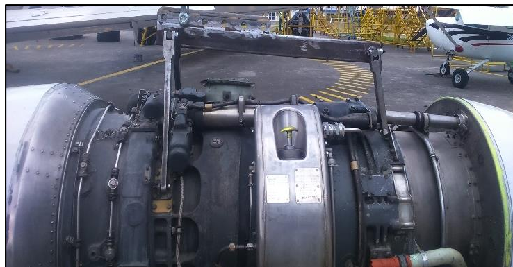
Figura 38 Instalación del power plant sling
