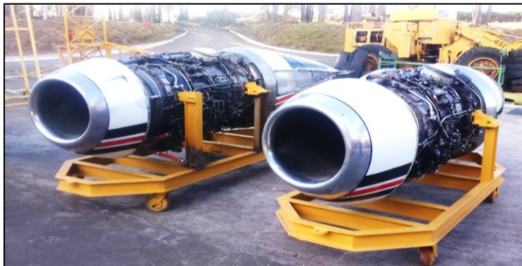
Figura 22 Posicionamiento de los motores Viper 522
