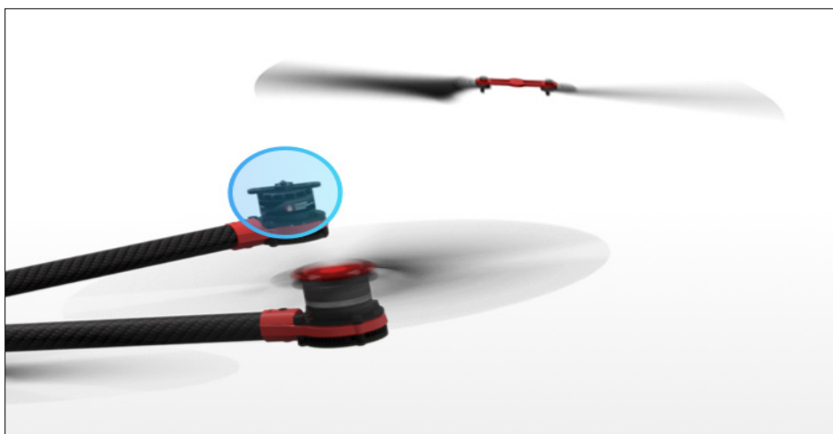
Figura 9 Control de actitud ante el desprendimiento de un rotor
