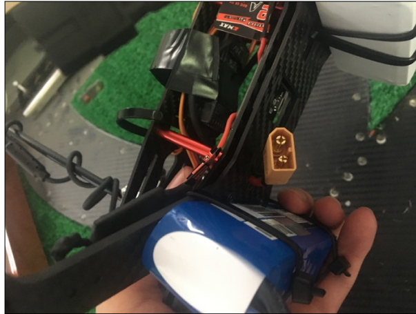
Figura 24. Conexión de la batería a la PBD
