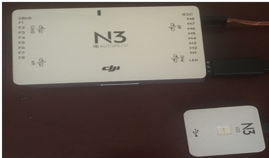
Figura 16. Conexión del Módulo Led al controlador de vuelo N3
