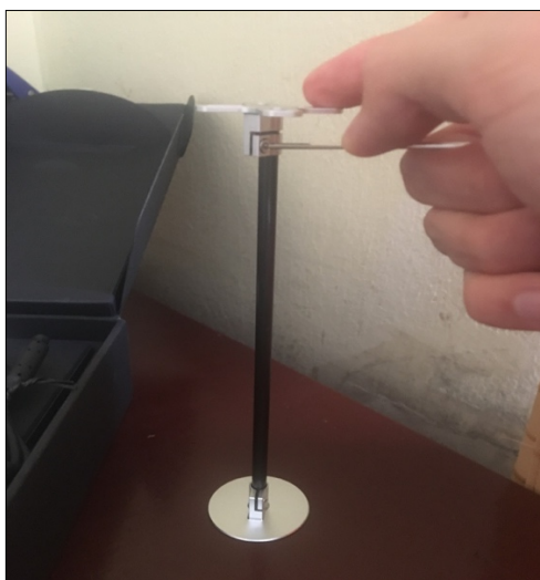
Figura 18. Ensamblaje del soporte del GNSS-Compass
