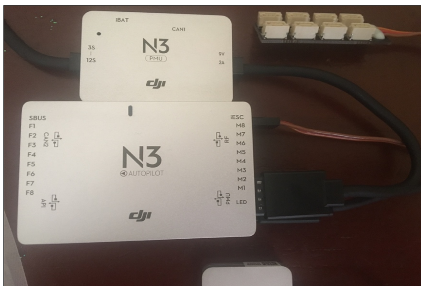
Figura 17. Conexión del Módulo PMU al controlador de vuelo N3
