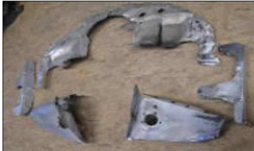
Figura 30 Remoción de los deflectores deteriorados
