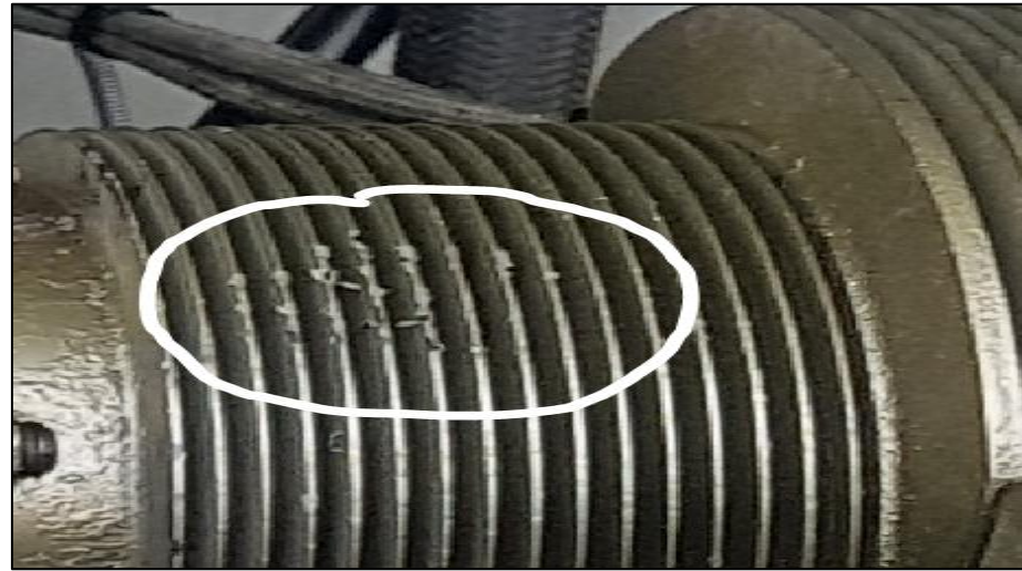
Figura 27 Daños permisibles de las aletas de refrigeración
