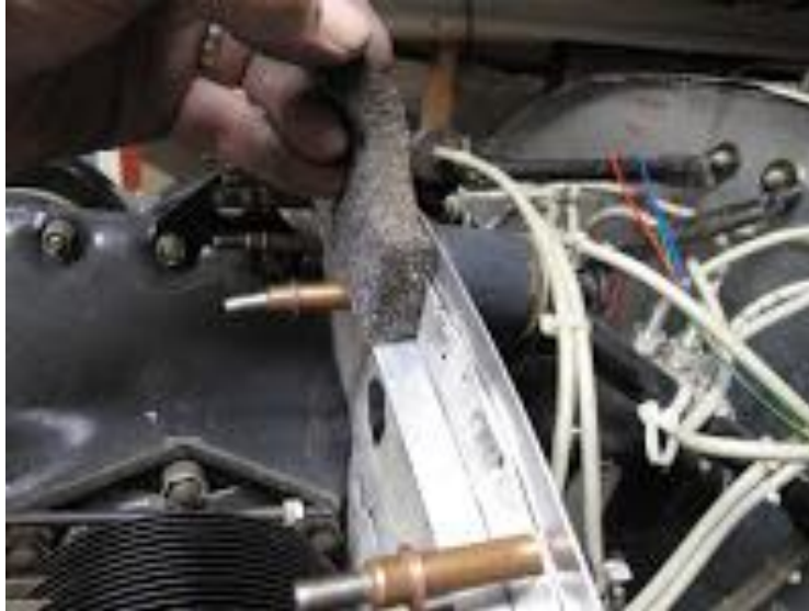
Figura 31 Reparación del deflector posterior superior del motor
