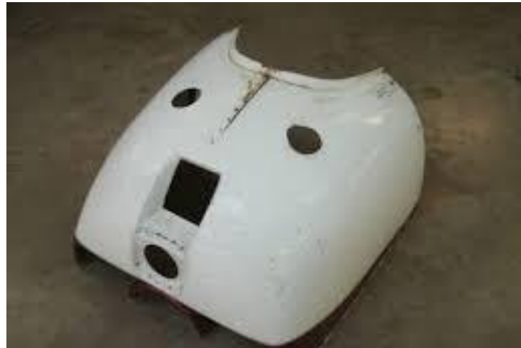
Figura 24 Carenado del motor inferior removido
