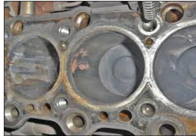
Figura 9 Síntomas de un motor gripado
