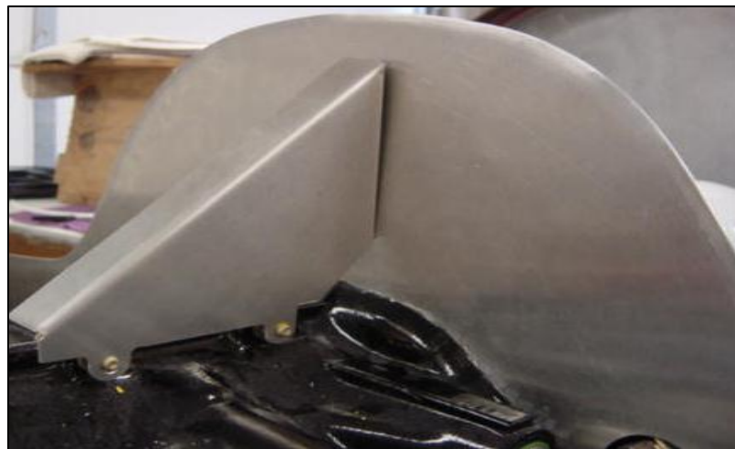
Figura 50.- Deflectores de apoyo trasero del deflector posterior superior del motor
