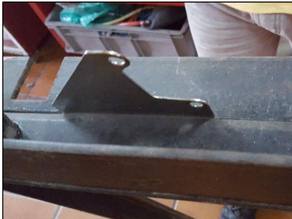
Figura 37.- Deflector de soporte en la prensa
