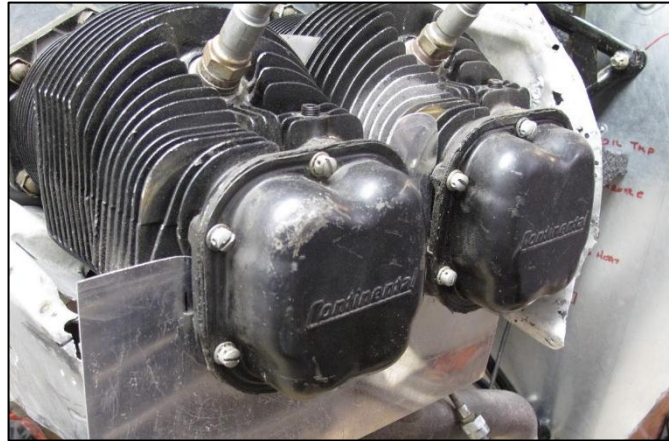
Figura 45.- Deflectores internos instalados
