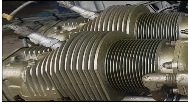
Figura 22.- Aletas de refrigeración de los cilindros izquierdos (1 y 3)
