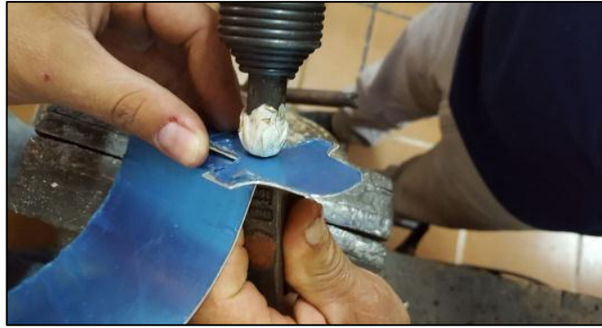
Figura 39 Doblado del deflector central
