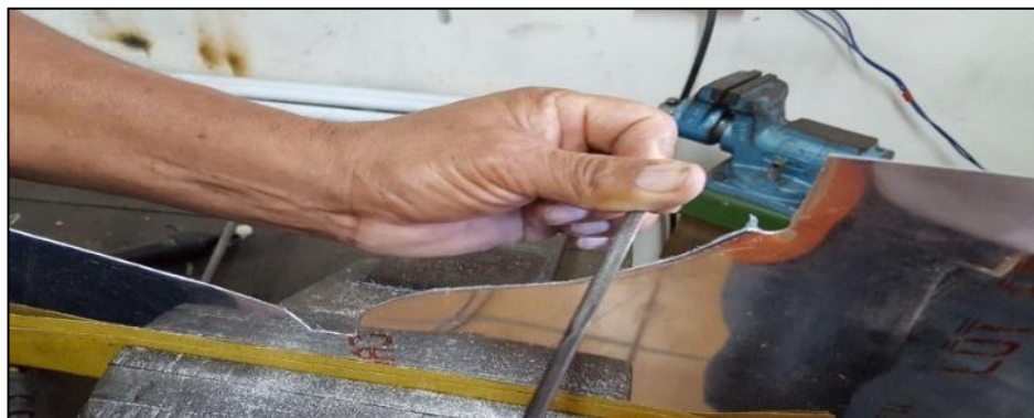
Figura 35.- Limado de los bordes del deflector central
