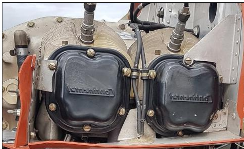
Figura 46.- Deflectores laterales instalados con sus baffles
