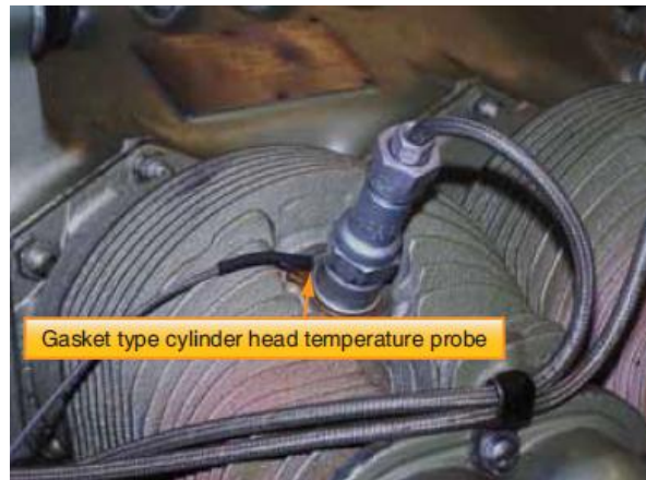
Figura 20.- Tipo de junta sonda CHT
