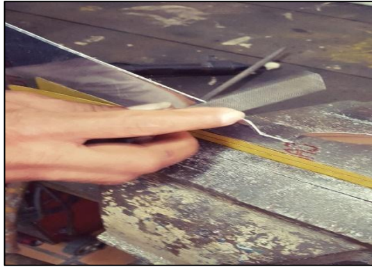
Figura 36.- Limado del borde del deflector lateral
