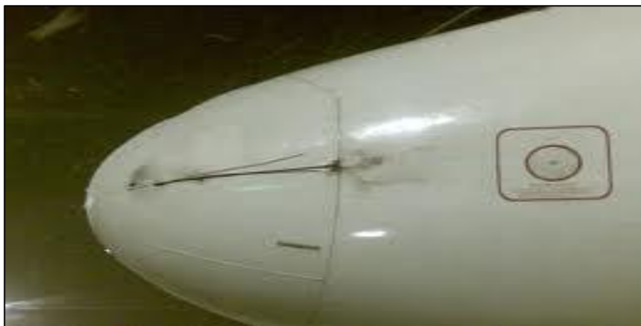
Figura 15 Daños de un rayo
