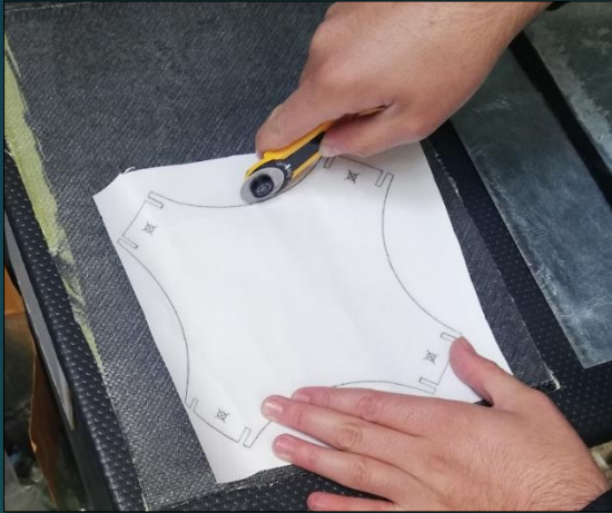
Molde del refuerzo central
