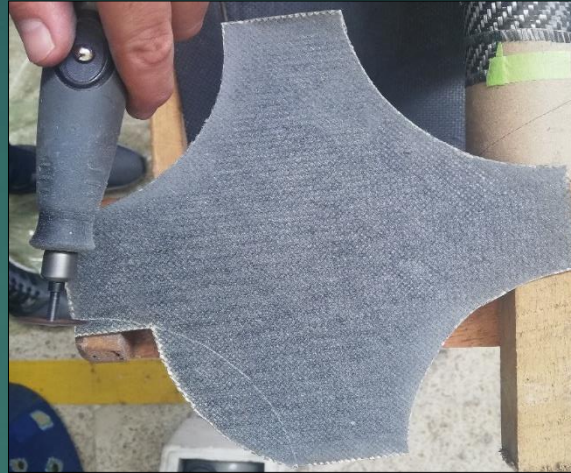
Corte del refuerzo central
