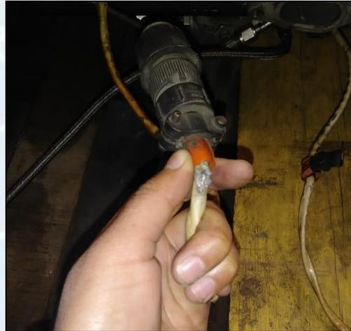
Corrección del cables de señales, según su condición el arnés ya que se encontraba deteriorado, se realizó las respectivas correcciones según el SWPM y HANBOOK
