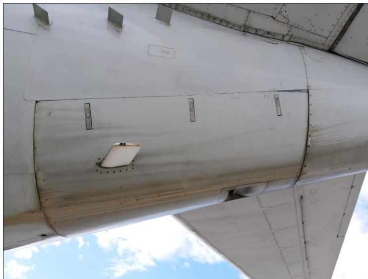
Figura 67 Puertas de acceso del APU cerradas
