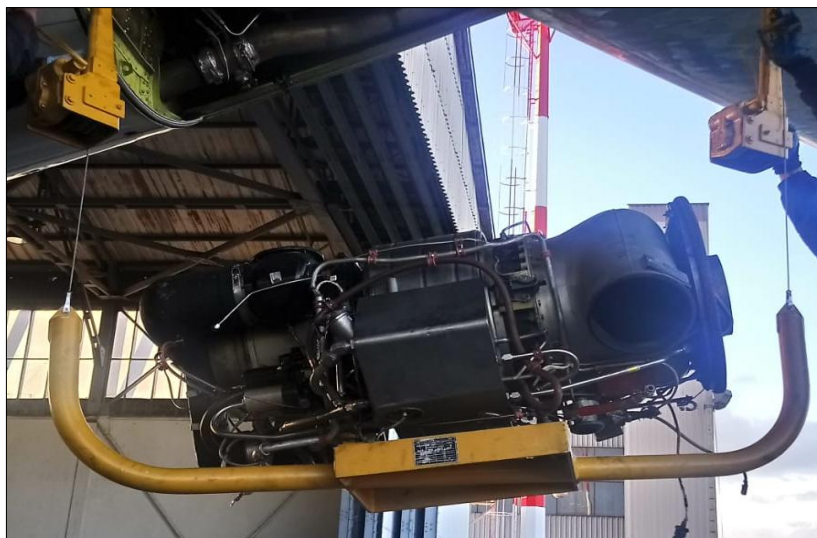
Figura 62 Levantamiento de la planta de energía
