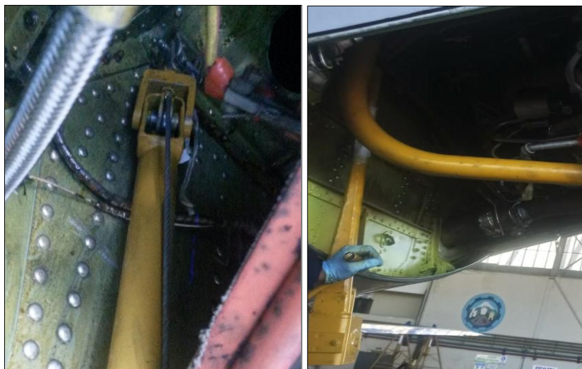
Figura 43 Instalación del Hoist
