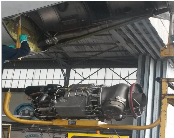
Figura 61 Levantamiento de la planta de energía
