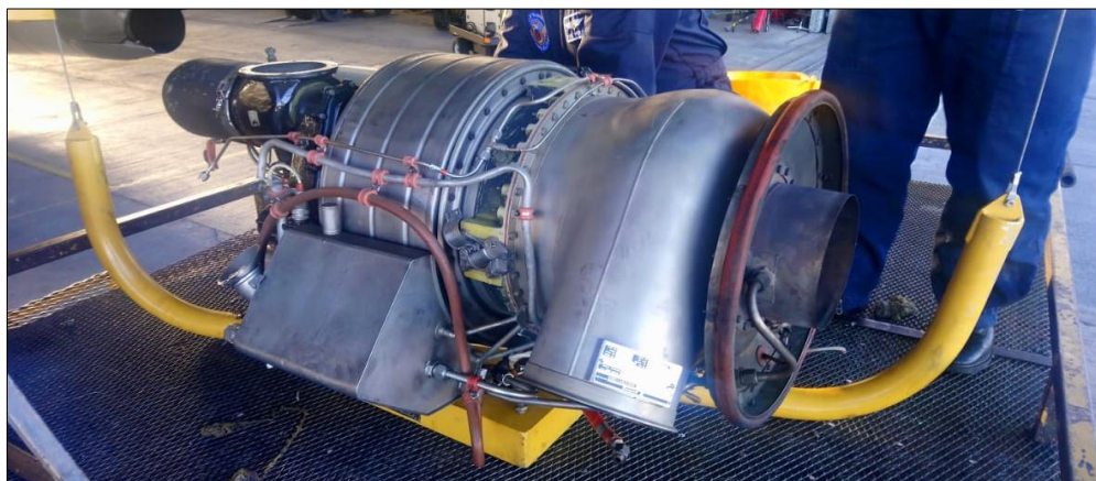
Figura 59 Instalación de la herramienta Hoisting Cradle Assembly
