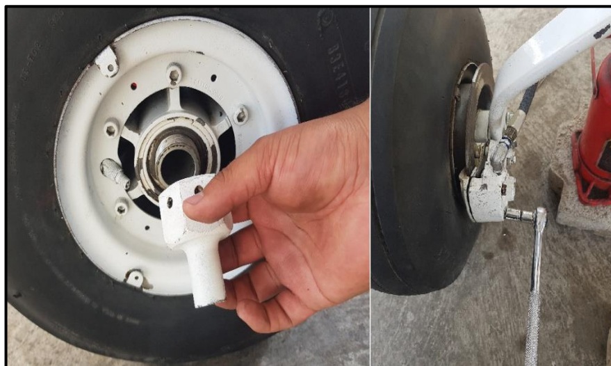
Figura 44 Desmontajes de pernos del tren principal
