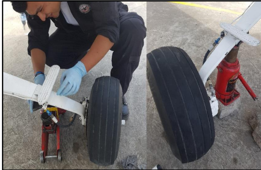
Figura 43 Colocación de una gata hidráulica
