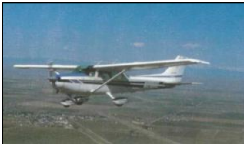
Figura 3 Tren de aterrizaje tipo triciclo
