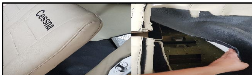
Figura 55 Remoción de accesorios de cabina
