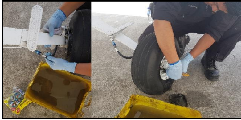
Figura 41 Limpieza externa del tren de aterrizaje
