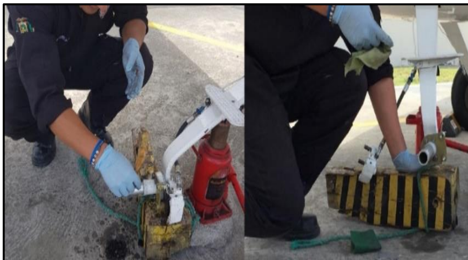
Figura 51 Limpieza del resorte tubular
