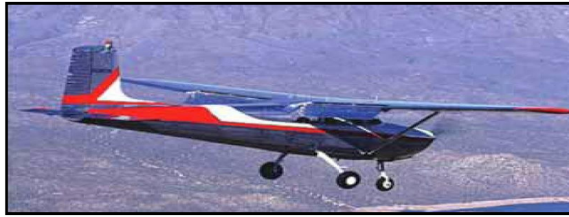
Figura 19 Tren de articulación fija
