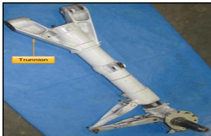
Figura 33 Apoyo del tren de aterrizaje
