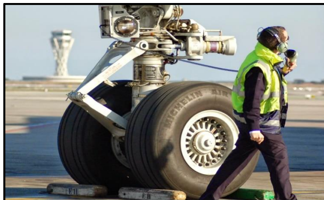
Figura 29 Amortiguador oleo neumático
