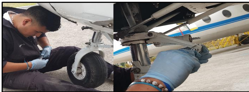
Figura 59 Inspección visual del enlace te torsión
