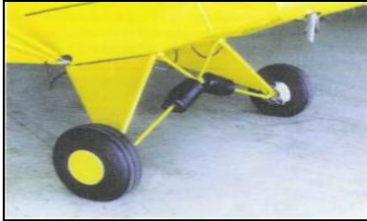
Figura 7 Conjuntos del tren de aterrizaje
