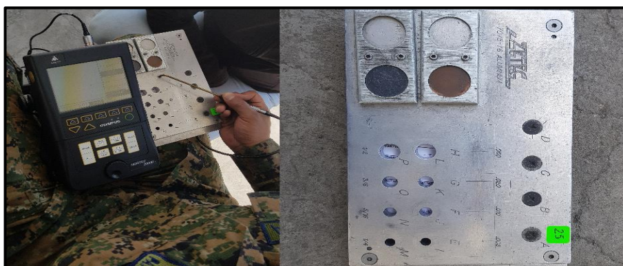
Figura 60 Calibración del equipo de corrientes inducidas
