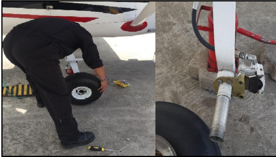
Figura 50 Desmontaje de la rueda del tren
