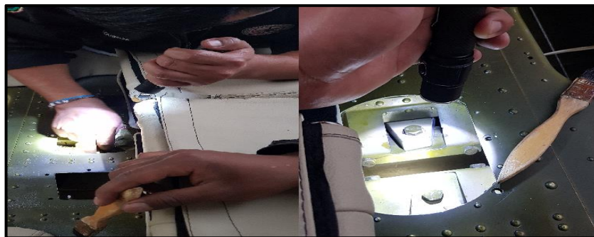
Figura 56 Limpieza de los soportes del tren principal
