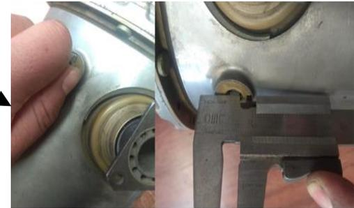
Reborde de la soldadura del conducto de salida
