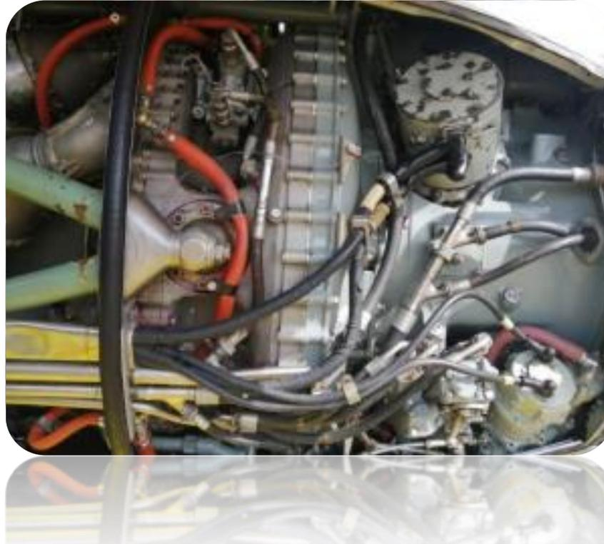
Finalización de la inspección de las carcasas de la sección compresora
