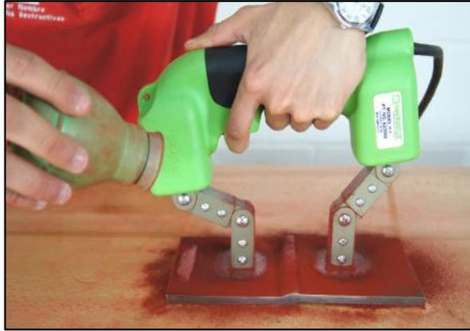
Nota. En el gráfico se muestra una inspección mediante partículas magnéticas. (destruivas, 2011)
