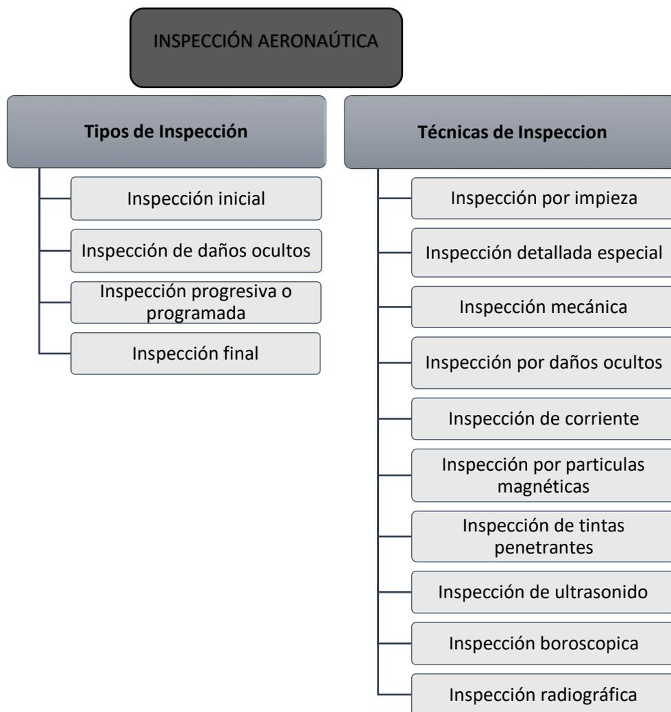
Nota. El gráfico muestra las diferentes inspecciones que se aplican en tareas de mantenimiento.
