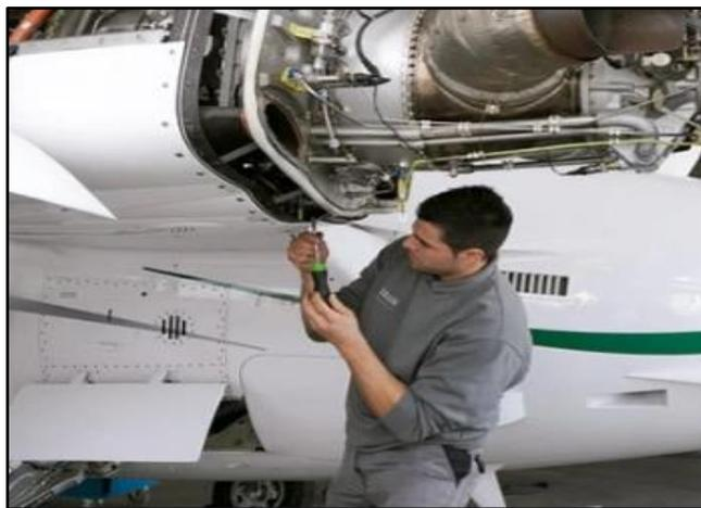
Nota. El gráfico muestra una inspección de los pernos de la capota del motor mediante fuerza manual.
