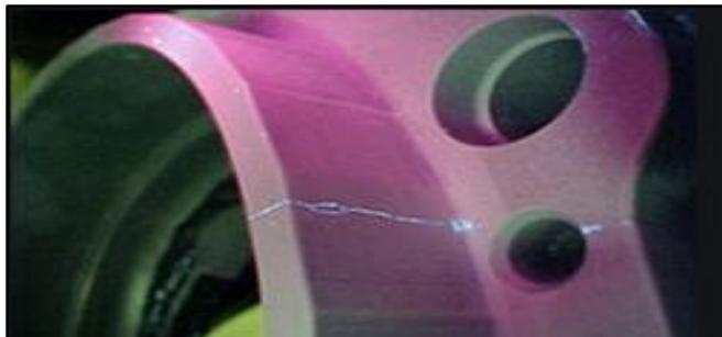
Nota. En el gráfico se muestra la inspección la luz violeta aplicada después de la aplicación de líquidos penetrantes. (Inspección, 2018)
