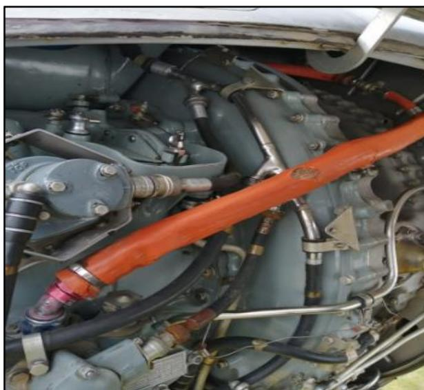
A continuación se inició una inspección visual en general a los dos motores Rolls Royce Dart con la ayuda de las herramientas y equipo ya mencionados, siguiendo las instrucciones del AMM 72-30-00 de la sección del compresor verificando la limpieza ya realizada y que ningún objeto obstruya la visibilidad de la carcasa de salida del compresor.
