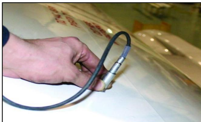
Nota. En el gráfico se muestra una inspección con corrientes inducidas a la estructura. (Ferrepro, 2016)
