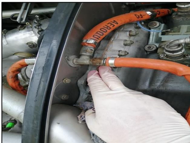
En el lado izquierdo de la salida en la carcasa no presentó ninguna grieta que cumpla los parámetros de la tabla de inspección visual de grietas, además ningún daño estructural como abolladura o levantamiento de pintura para lo cual se aplicó la respectiva limpieza por motivos de presencia de FOD y la carcasa se encontraba en condiciones aptas para su operación según las condiciones de la tabla emitidas por el fabricante.
