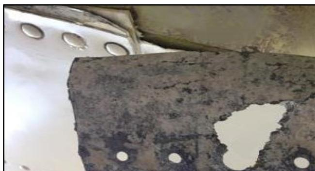
Nota. En el gráfico se muestra el levantamiento de pintura en la estructura. (Corrosión Aeronáutica, 2018)
