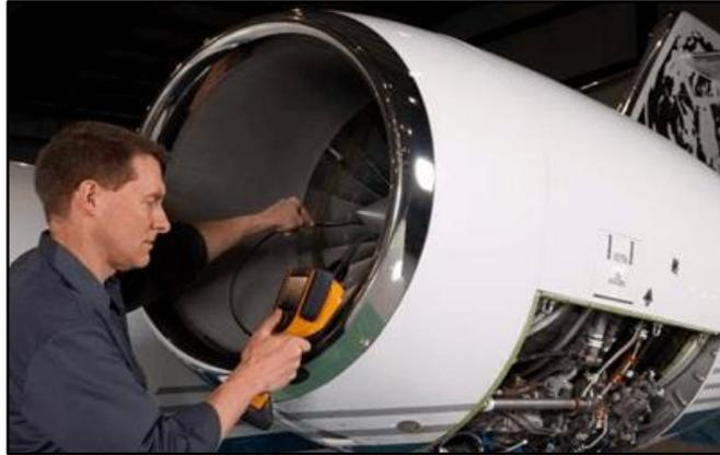
Nota. En el gráfico se muestra una inspección boroscópica en un motor Turbina. (TMA, 2019)
