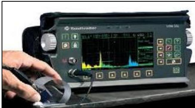
Nota. En el gráfico se muestra el resultado de una inspección de ultrasonido en estructuras. (Reyes, 2013)
