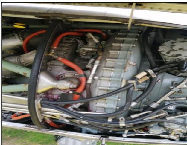
En el motor número dos en la parte intermedia del lado superior derecho de montaje y la válvula de aire caliente no se encontró ninguna grieta en la estructura de la carcasa, adjunto a la misma se encontró con indicios de corrosión de tipo picadura, la que era causada por fugas de líquido hidráulico, además de encontrar cubierta esta zona de FOD, las que tendría como consecuencia esforzar la estructura de la carcasa y a futuro provocar su rotura.
