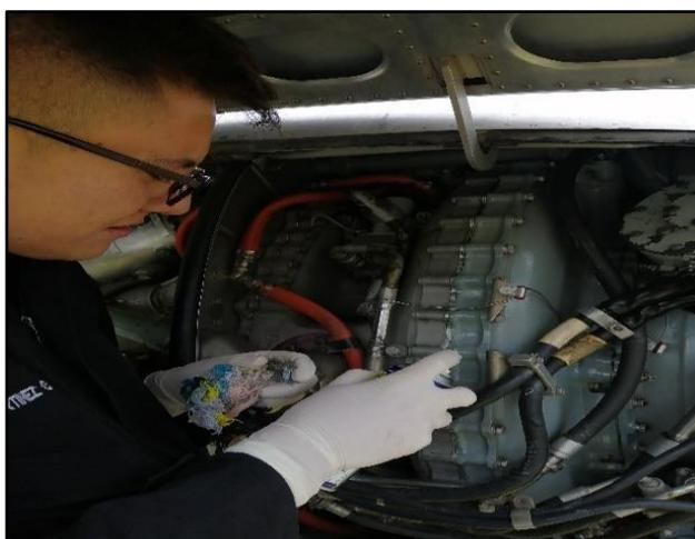
En lado izquierdo del motor número dos de la parte intermedia de montaje no se encontró ninguna grieta o la presencia de algún daño en su estructura estaba en condiciones aptas, al continuar con la verificación se notó que existían con cañerías en malas condiciones que podrían producir fugas de líquido hidráulico afectando a la estructura de la carcasa del compresor.
