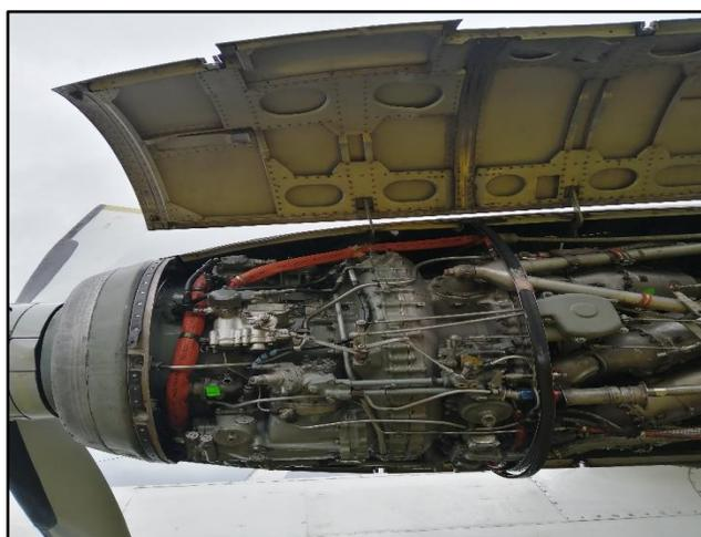
Para cada una de las carcasas de la sección compresora a inspeccionar se mostrará la tabla de inspección visual de grietas del manual de mantenimiento AMM 72-30-00, la cual nos indicará la aceptabilidad de su estructura.
