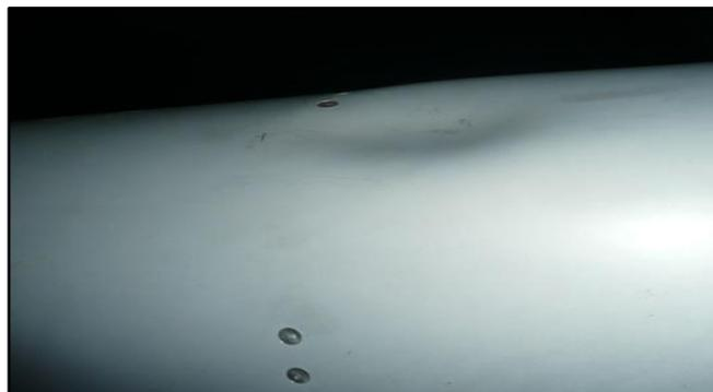
Nota. En el gráfico se muestra una abolladura en la estructura de la aeronave. (Berzal, 2012)
