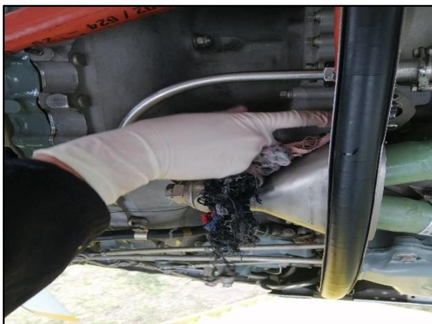
En la parte superior e inferior de la salida en la carcasa, realizada su inspección visual de grietas, no se presentó ninguna grieta en la estructura, adicional se encontró gran cantidad de FOD, no se visualizó abolladuras presencia de corrosión para lo cual también estaba en condiciones aptas.
