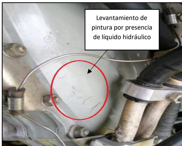
En el lado izquierdo del motor número uno basado en la inspección visual de grietas circunferenciales de más de 8 pulgadas y no excedan las 12 pulgadas no se encontró ninguna grieta, adicional tampoco se mostró levantamientos de la capa de protección de pintura para lo cual se procedió a dar la respectiva limpieza de la parte trasera y radio de la voluta por presencia de líquido hidráulico y FOD.
