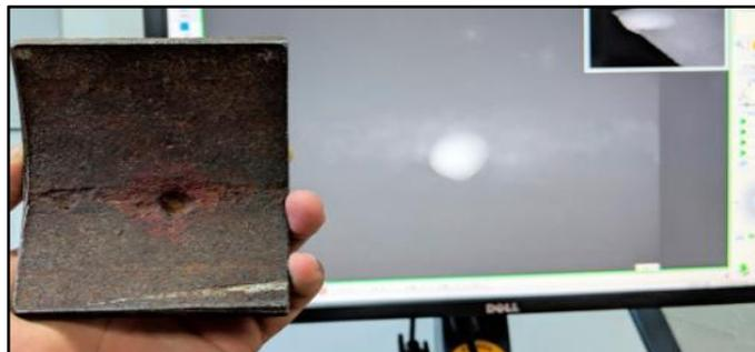
Nota. En el gráfico de muestra una inspección radiográfica aplicada a una estructura. (Mercadotécnia, 2018)
