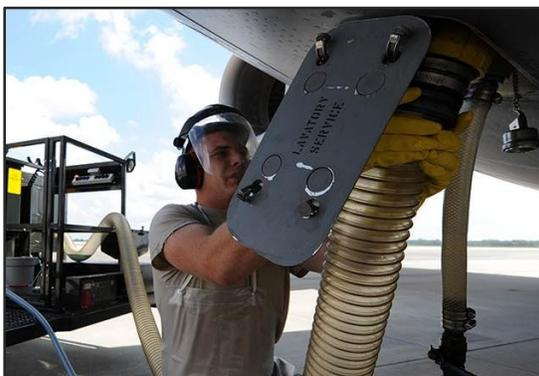
*Nota:* En esta imagen podemos apreciar la conexión del acople de drenaje que mide 4 pulgadas y del acople de abastecimiento para el enjuague del tanque de desechos.
