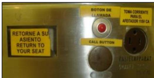
*Nota:* Se muestra la ubicación de los componentes del LSU como la indicación de retorno a su asiento, botón de llamada y tomacorriente de 115 v / 400 Hz.
