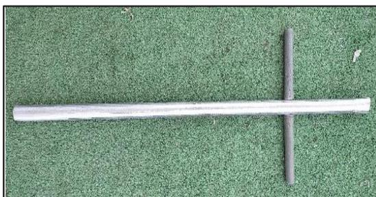
*Nota:* En esta imagen podemos ver los cortes con los que formamos la barra remolcadora, ocupando un tubo de 1 metro y 1 pulgada y los dos pequeños son de  $\frac{1}{2}$  pulgada y 15 centímetros, tomando la forma de una cruz.
