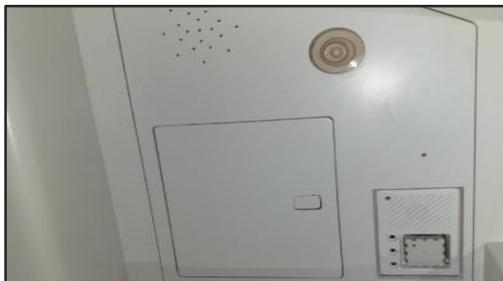
*Nota:* Se puede ver la bocina por la que se escucharán los anuncios de tripulación, el sensor de humo y la cubierta para dos mascarillas de oxígeno en caso de emergencia.
