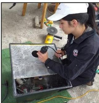
*Nota:* La imagen nos señala como se realizó el proceso de corte y desgaste de la lámina de acrílico donde va colocada la brida y sus respectivos pernos.
