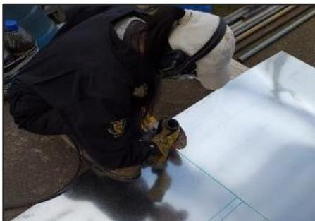
*Nota:* La imagen muestra la posición y forma en la que se realizaron los cortes en la lámina galvanizada. Con los equipos de protección personal. Elaboración propia.
