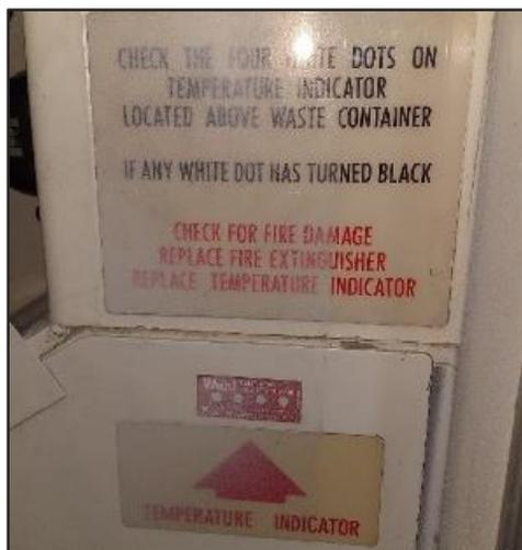
*Nota:* Se muestra una placa con su señalética, esta placa es térmica a base de puntas fusible, en el que se fusiona y manda una indicación para que descargue la botella extintora.
