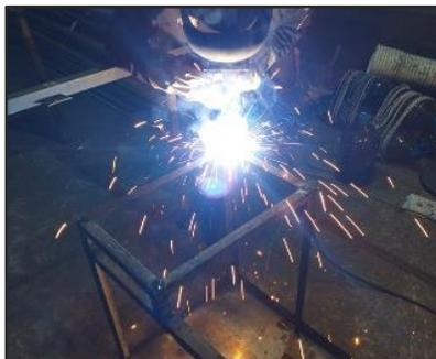
Nota: La figura muestra cómo se realizó los puntos de suelda en las bases para las láminas exteriores con todos los equipos de protección personal.
