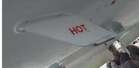
*Nota:* En la imagen se puede ver el drenaje del sistema de aguas usadas de los lavabos y cocinas. Este es un mástil de drenaje que evacua el agua al exterior mediante sus cañerías, además tiene un sistema anti hielo en la punta del mástil que está construido de cobre para que se caliente y no se forme hielo durante el vuelo.
