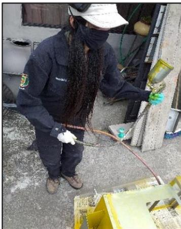
Nota: En la imagen se muestra como se efectuó el ajuste de presión de la pistola de pintura ya que es importante para el acabado que deseamos obtener y de cuanto material se utilizará.
