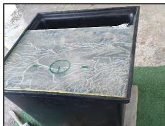
*Nota:* La imagen exhibe cuales fueron las marcas que se hicieron en la lámina de acrílico para proceder con los cortes y distribución de espacio para seguir con los diseños del carro de servicio.
