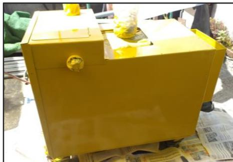
*Nota:* En la figura se puede apreciar el brillo que obtiene esta capa de pintura y de las partes que se van pintando y las que están cubiertas hasta esperar a que se sequen totalmente en el lapso de 8 a 12 horas.
