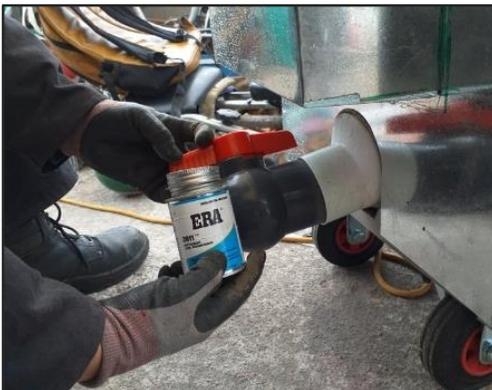
*Nota:* La imagen nos enseña cual fue el material con el que se pegaron y aislaron las conexiones de drenaje del depósito de desechos o aguas negras.
