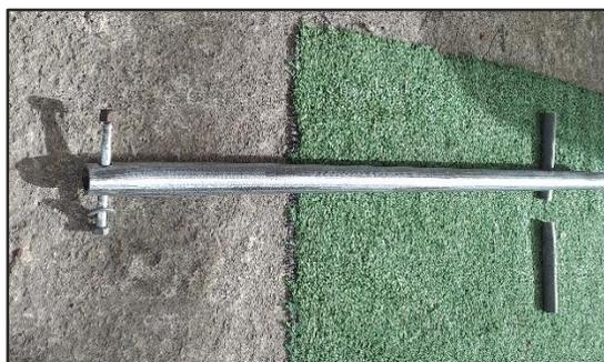
*Nota:* La imagen expresa gráficamente cual fue la posición en la que esta doblada ligeramente la barra remolcadora y en donde se colocó el perno para asegurar en la estructura.
