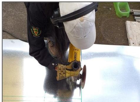
*Nota:* En esta figura se puede apreciar cómo se realizaron los cortes en las láminas, con la ayuda de una amoladora eléctrica y un disco de corte para metal. Apreciando que se debe utilizar los equipos de protección personal.
