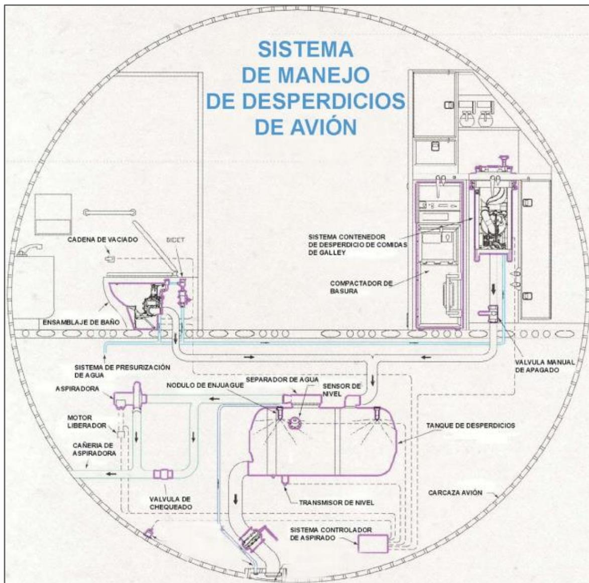
*Nota:* En la imagen se puede apreciar el funcionamiento interno del sistema para drenaje de desperdicios en el que se reúnen aguas negras del inodoro y el recolector de desperdicios de los galleys, y como son llevados por las cañerías hacia el panel de servicio. Tomado de (Ormeño, 2004)
