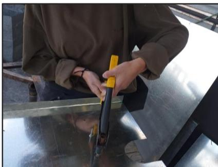
*Nota:* La figura muestra cómo se remacharán las juntas con la ayuda de una remachadora manual y los remaches en la colocación de las láminas exteriores del carro de servicio.
