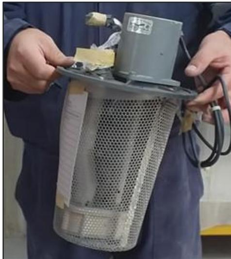
*Nota:* En la imagen podemos apreciar el motor que se encuentra dentro de la malla filtradora, son unas aspas que tienen un eje eléctrico, en el que ingresan las aguas negras junto con el líquido desodorante del inodoro.
