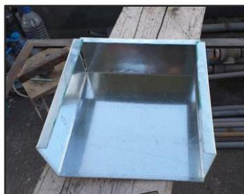
*Nota:* La imagen muestra cual es la forma del bolsillo que se construyó con una lámina galvanizada y doblecetes en los lados, donde se pondrán los remaches.
