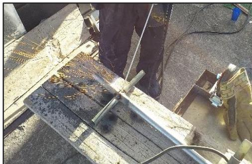
*Nota:* Se muestra en la figura como se realizaron los puntos de suelda en la barra remolcadora.
