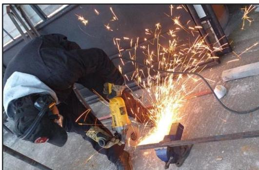
*Nota:* En la imagen se muestra como se realizaron los cortes de los ángulos para poner puntos de suelda en la base para llantas como se requiere en la construcción.
