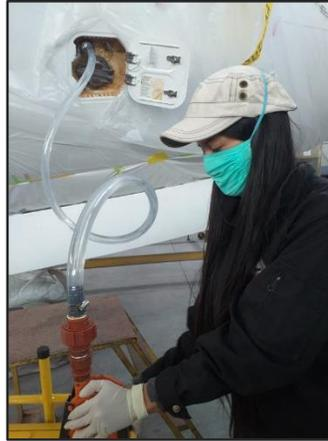
*Nota:* La figura exhibe cual fue el procedimiento a seguir para abastecer de agua al depósito del inodoro de la aeronave. Ocupando la bomba manual para mandar el agua mediante la conexión de un acople y la manguera.
