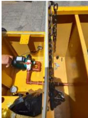
*Nota. Montaje de las tuberías que van desde el tanque de agua hasta la bomba.*
