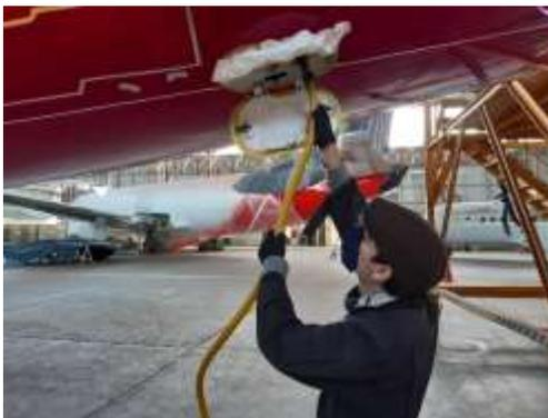
*Nota. Aseguración de la conexión de la manguera para evitar la existencia de fugas.*
