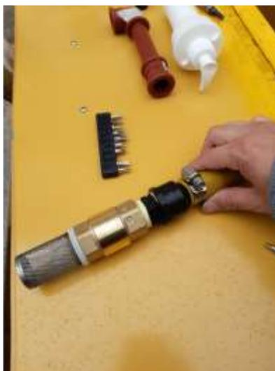
*Nota. Instalación de la válvula pie de tigre con la manguera. Creación propia.*
