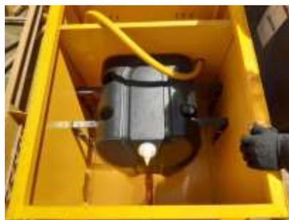
*Nota. Montaje del tanque de agua con las soportes de metal. Creación propia.*
