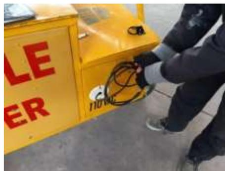
*Nota. Se envolvió el cableado con seguridad para evitar daños de la misma. Creación propia.*
