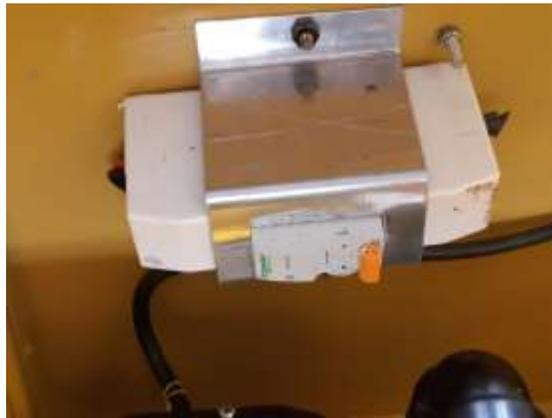
*Nota. Colocación de una placa metálica alrededor del disyuntor para fijar sobre el artefacto. Creación propia.*
