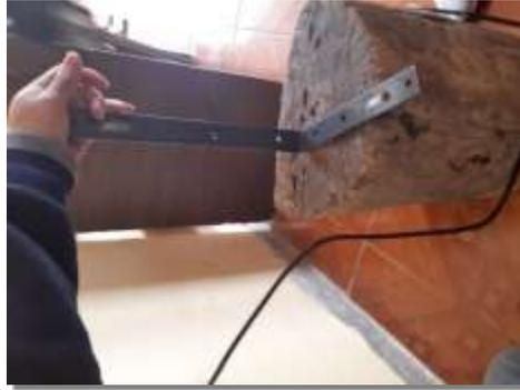
*Nota. Perforación de las soportes de metal para la fijación del tanque en el artefacto.*
