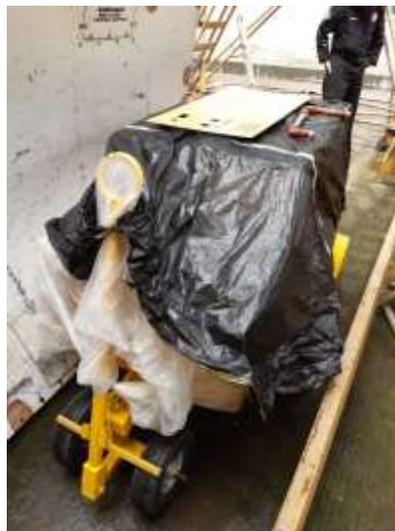
*Nota. De esta manera se guardaba al artefacto, con el fin de evitar que entre agua y dañe algún componente o pueda crear corrosión. Creación propia.*
