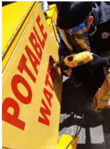
*Nota. Proceso de perforación de los laterales del artefacto para la colocación de las soportes de metal. Creación propia.*
