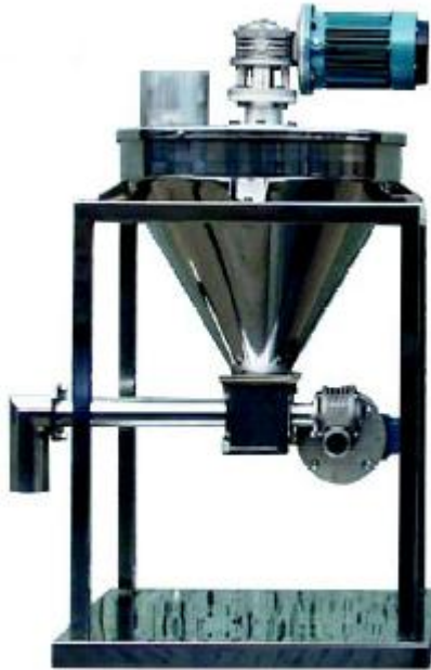
Figura 1-12: Dosificador de tornillo sin fin
