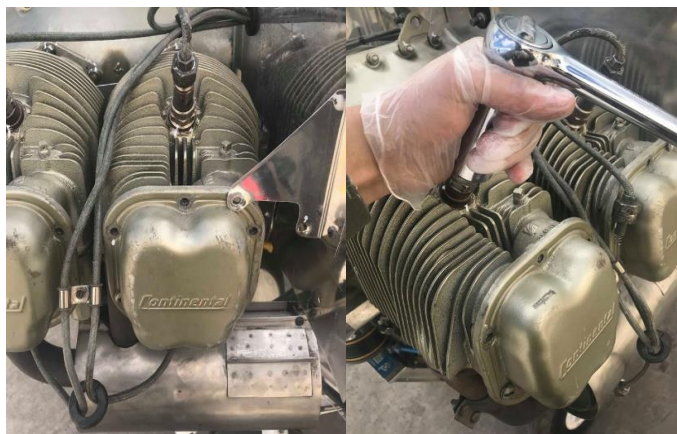
Figura 105 Instalación de las bujías
