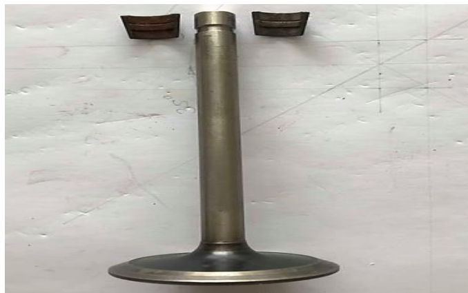
Figura 24 Válvulas de admisión y sus seguros
