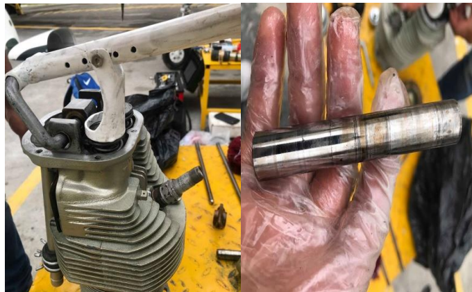
Figura 79 Desmontaje de los elementos del cilindro
