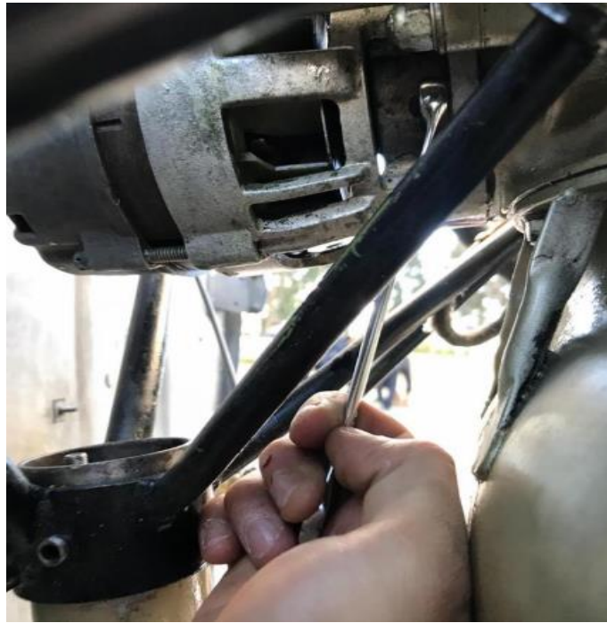
Figura 101 Ajuste del alternador tras inspección
