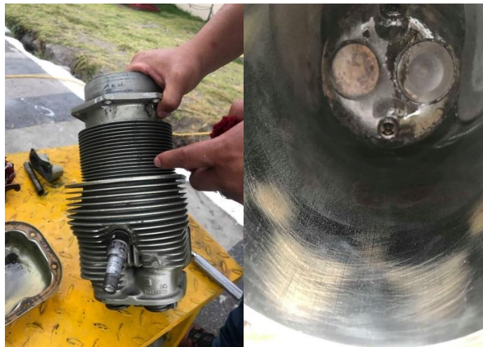
Figura 74 Inspección de los cilindros
