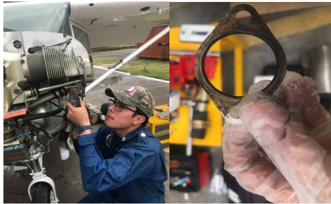
Figura 95 Montaje del sistema de escape
