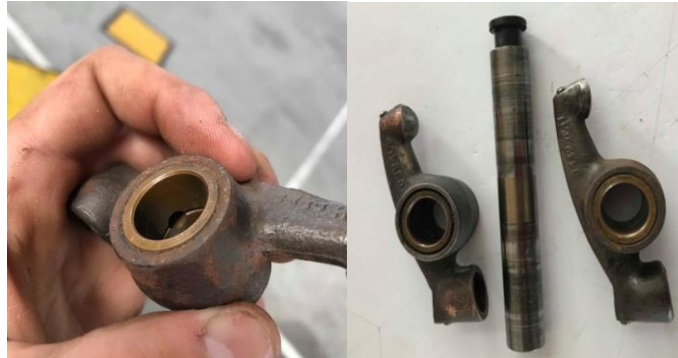
Figura 80 Inspección del balancín
