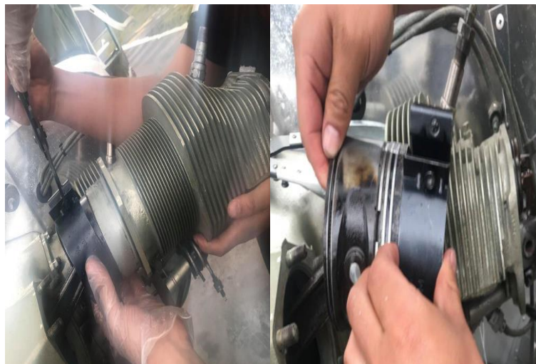
Figura 92 Colocación del ompresor de rines
