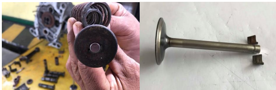
Figura 81 Inspección de las válvulas; Admisión y Escape
