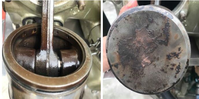
Figura 75 Inspección de la superficie del pistón
