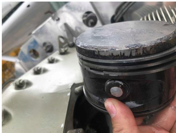
Figura 89 Instalación de los anillos de compresión
