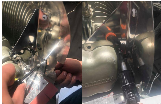
Figura 97 Instalación del conjunto de Baffles del motor
