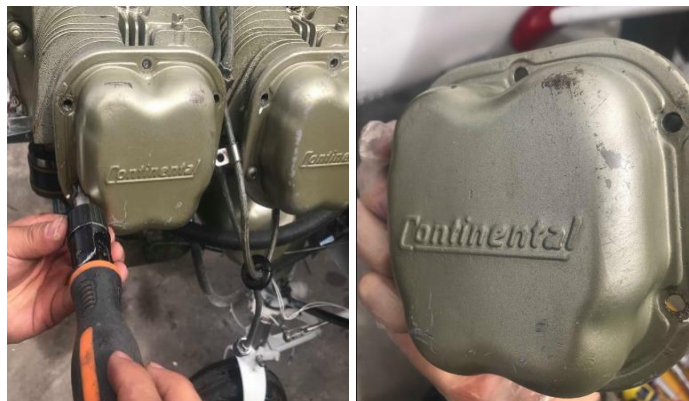
Figura 72 Remoción de la cubierta de los balancines
