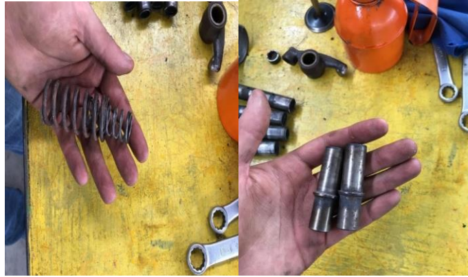
Figura 82 Inspección de los resortes y guías de válvula
