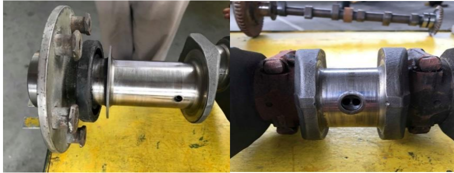
Figura 10 Nitrided Crankshaft; Orificio de lubricación del cigüeñal
