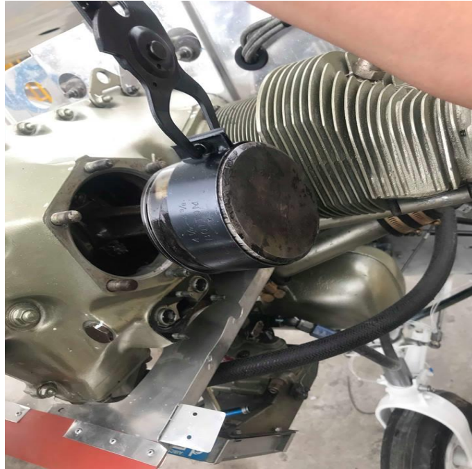
Figura 91 Preparación del Pistón para su montaje en el cilindro
