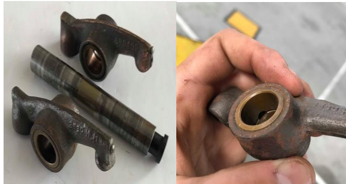
Figura 27 Balancines y eje; Orificio de lubricación del balancín
