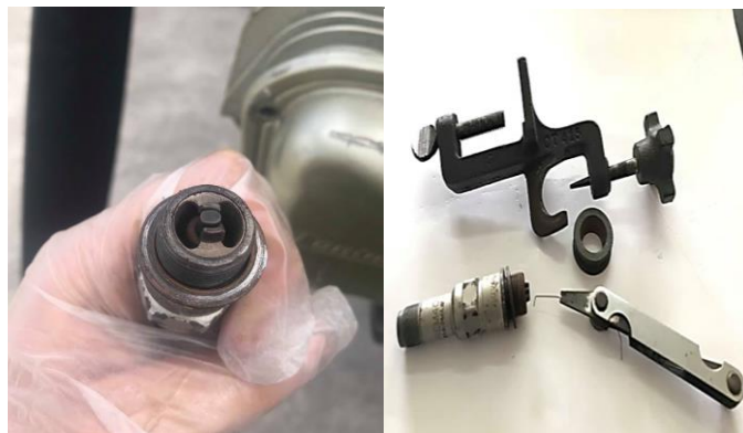
Figura 104 Verificación de la tolerancia de los electrodos de las bujías
