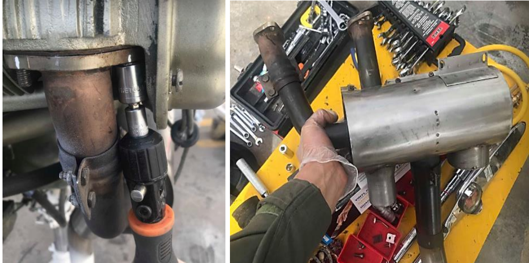
Figura 68 Desmontaje del sistema de escape
