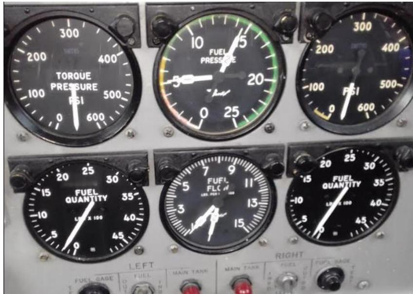
**Figura 16 Instrumentos de cantidad de combustible**
