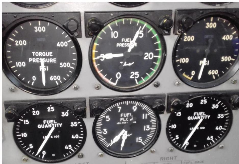
**Figura 19 Panel con los instrumentos de cantidad de combustible**
