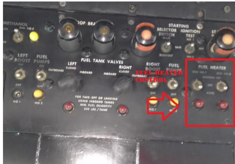
**Figura 10 Control de calentamiento de combustible**
