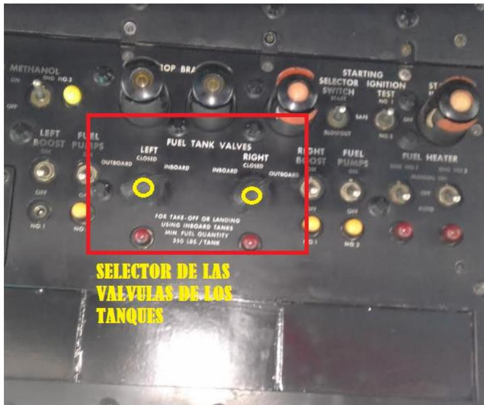
**Figura 14 Selector de tanques Fairchild FH-227**
