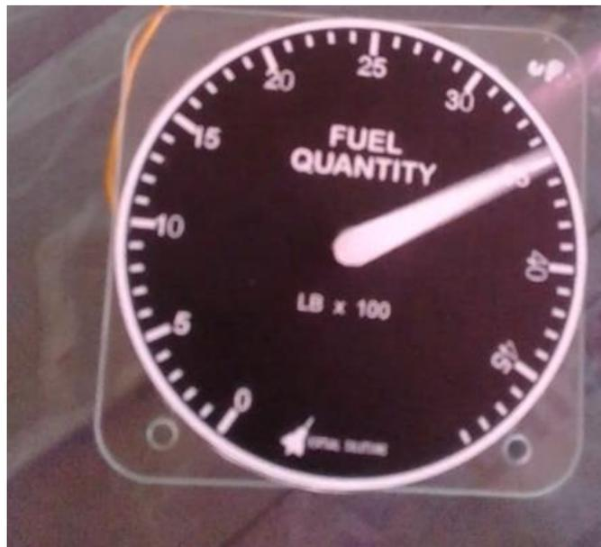
**Figura 31 Instrumento indicador con pluma**
