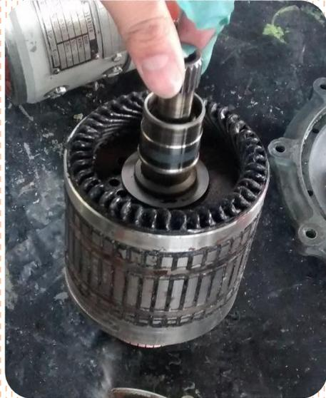
INSPECCIÓN DEL ROTOR DEL MOTOR DE ARRANQUE
