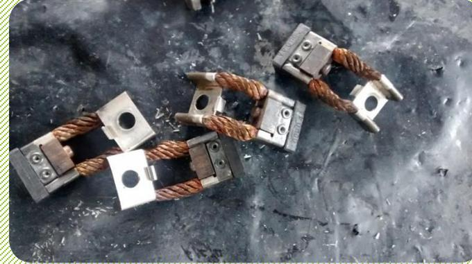
Inspección de escobillas y componentes asociados, las escobillas deben tener una longitud que no es menor a 0.6875 pulgadas
