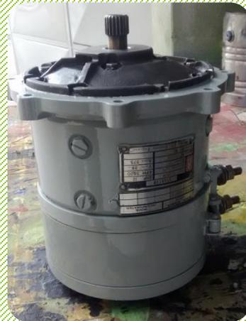
Ensamblaje del motor de arranque y pruebas operacionales previo a la instalación en el motor del avión.
