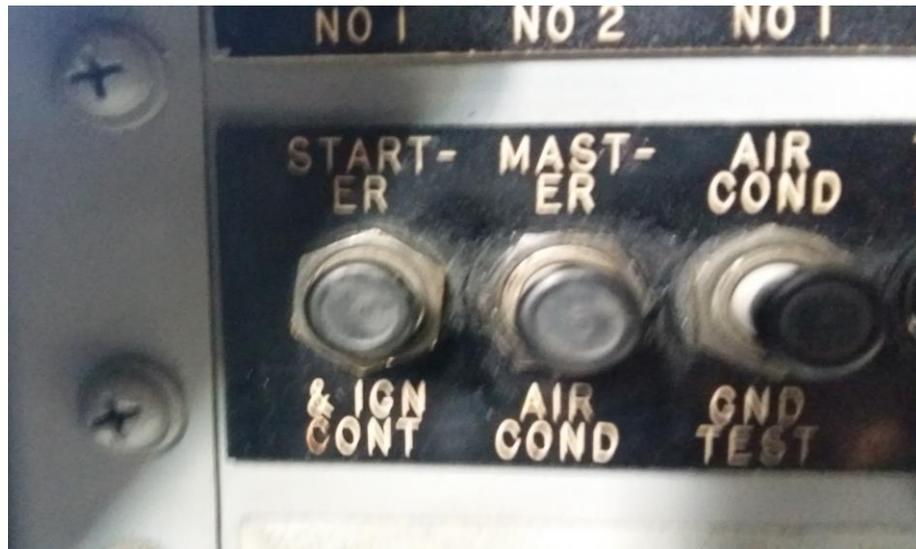
**Figura 9 Interruptor de circuito de arranque**
