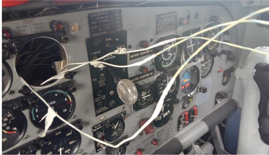
**Figura 10 Restauración cableado eléctrico**
