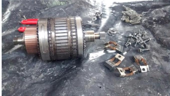
**Figura 7 Reemplazo escobillas**
