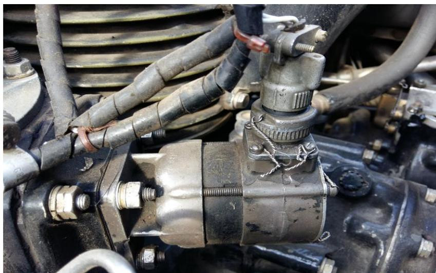
**Figura 12 Generador tacómetro (nacela del motor)**
