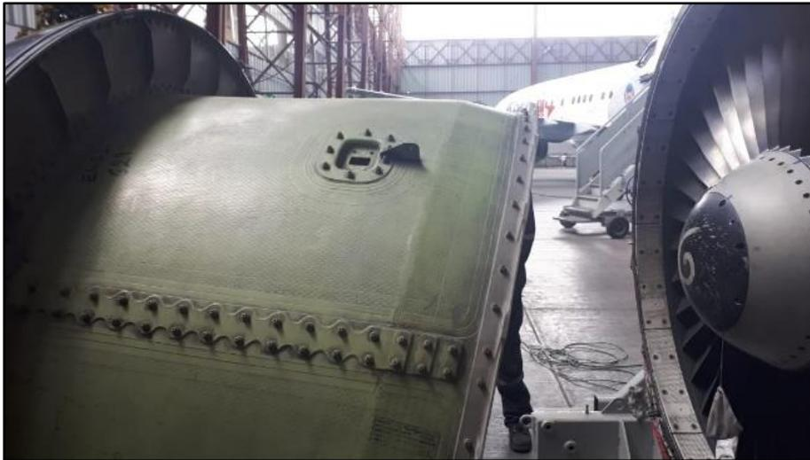
**Figura 43.** Desmontaje del cowling.
