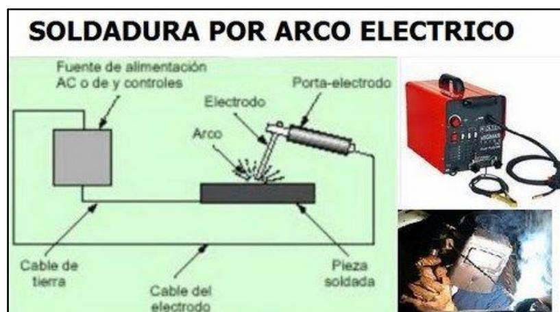
**Figura 18.** Soldadura por arco eléctrico
