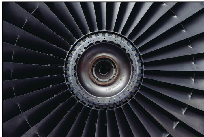
**Figura 3.** Fan del motor CFM56-3.
