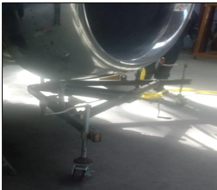
**Figura 35.** Colocación del inlet cowl.
