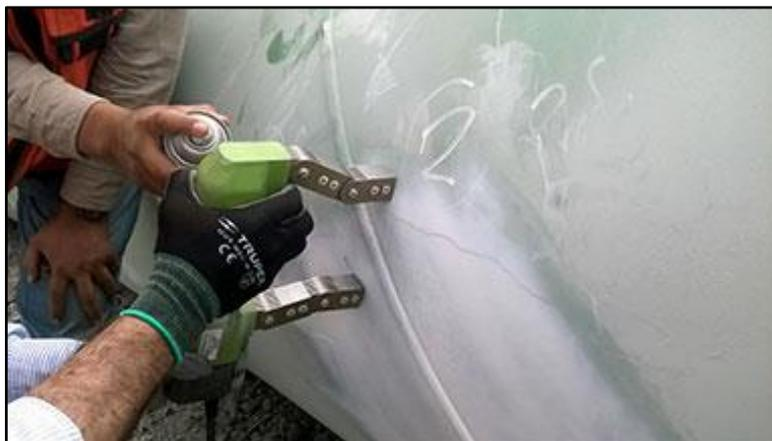
**Figura 23.** Ensayo por partículas magnéticas.
