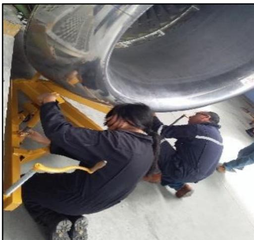
**Figura 42.** Verificación de los puntos de apoyo.
