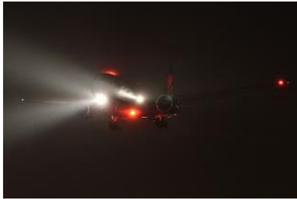
Figura 14. Luces de rodadura de una aeronave Fuente: (Oñate, 2019)
