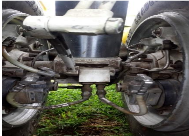
Figura 28. Estado inicial del shock strut.
