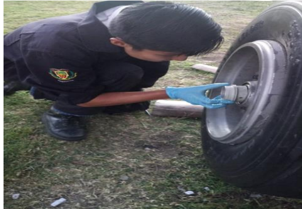
Figura 47. Instalación del collar.
