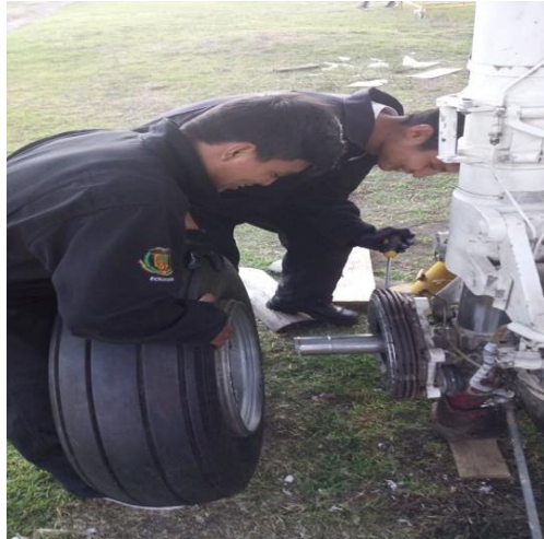
Figura 39. Extracción del collar.
