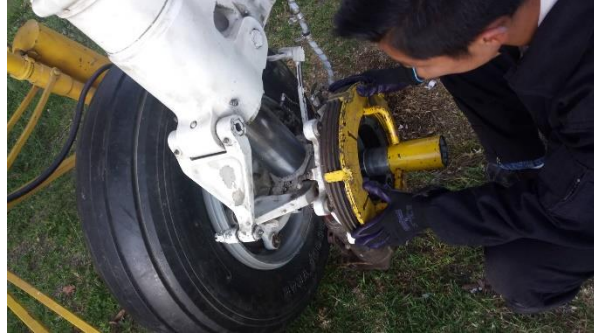
Figura 45. Alineación de los discos de freno.
