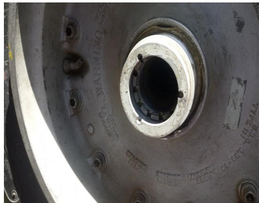
Figura 38. Extracción del collar.
