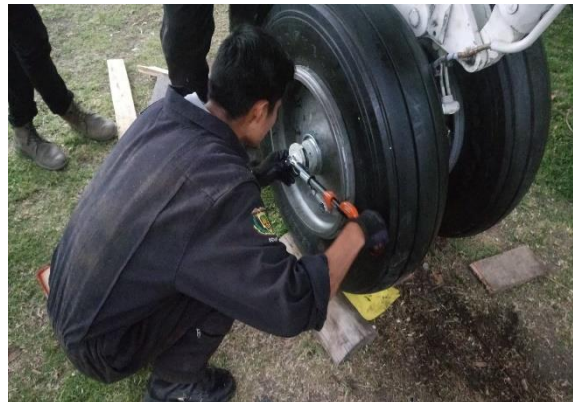
Figura 50. Colocación del torque.
