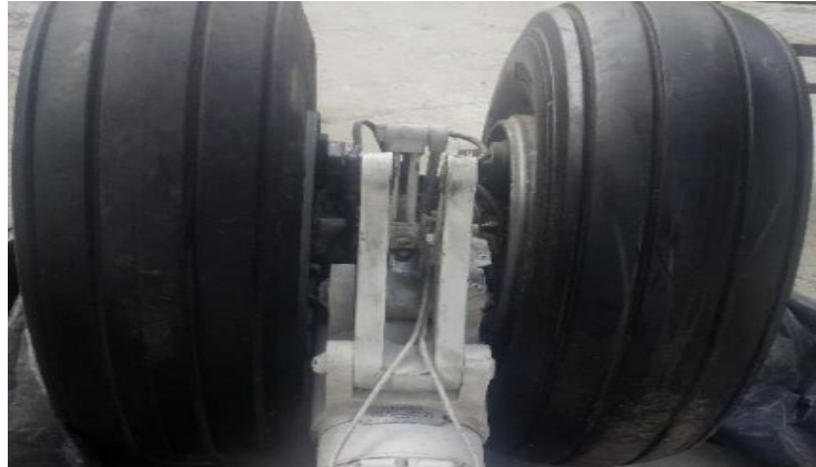
Figura 35. Inspección de las bandas de rodadura.
