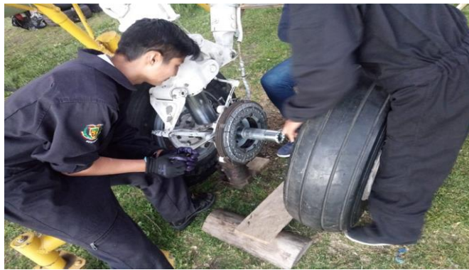
Figura 46. Instalación del neumático.
