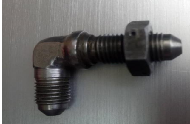
Figura 51. Instalación del nuevo fitting.
