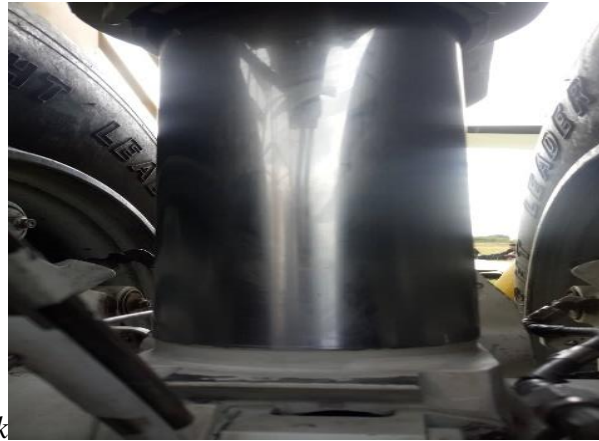
Figura 30. Shock strut libre de liqueos.
