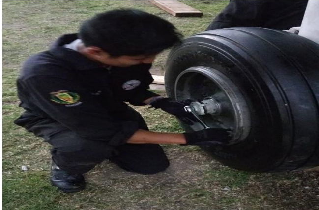
Figura 49. Ajuste de la tuerca de retención.
