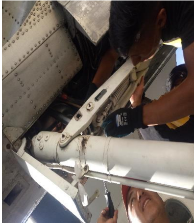
Figura 26. Desmontaje del puerto de engrase.
