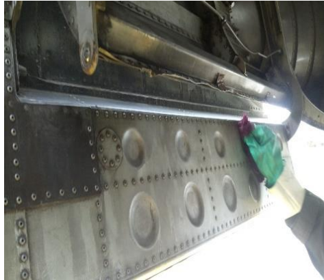
Figura 33. Limpieza de las compuertas.
