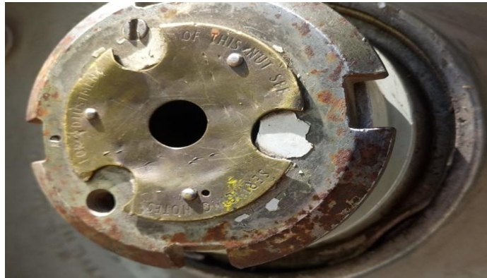
Figura 37. Extracción del perno de seguridad.
