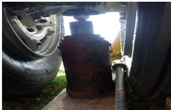
Figura 36. Levantamiento del shock strut.
