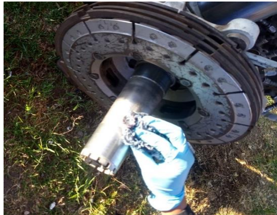
Figura 42. Limpieza del eje de la rueda.
