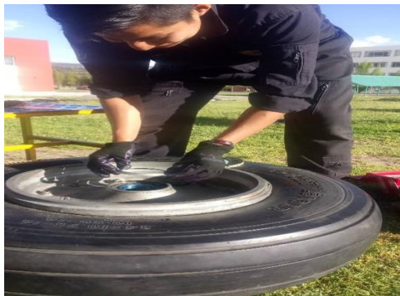
Figura 44. Instalación de los sellos.
