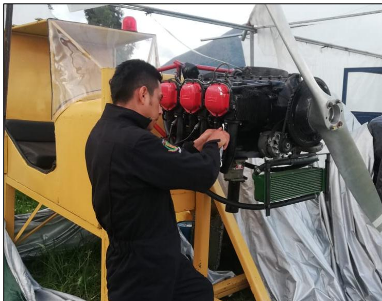
Figura 51. Remoción de la bujía del cilindro No. 1
