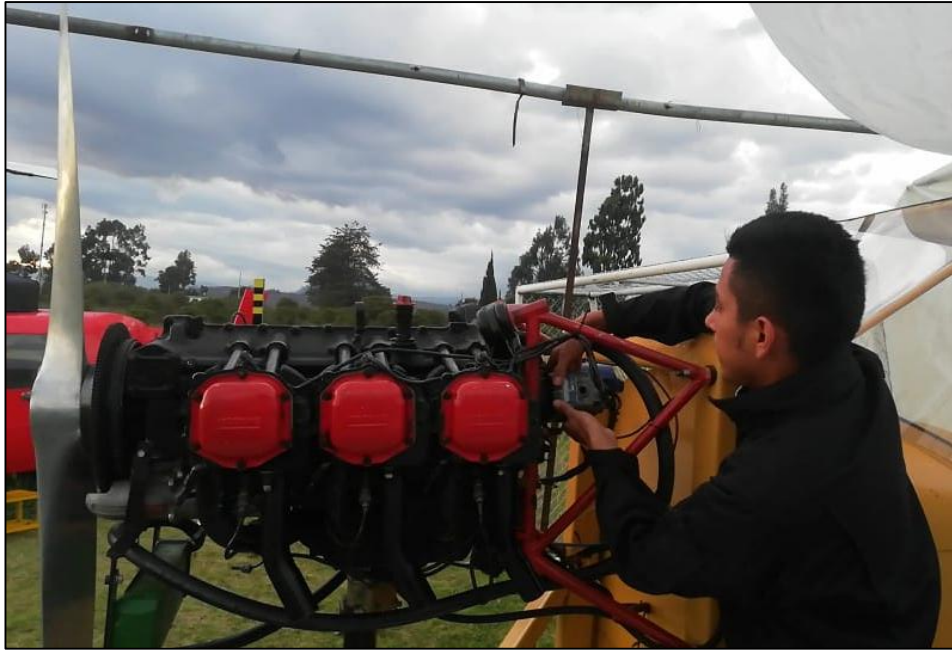
Figura 55. Instalación del magneto en el motor
