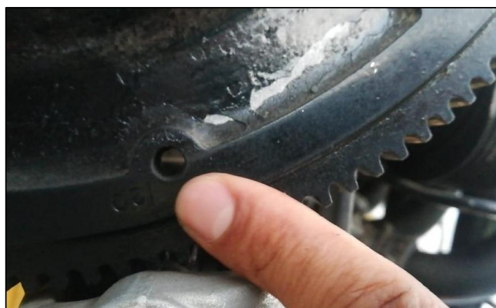
Figura 54. Marca de sincronización 20 grados.
