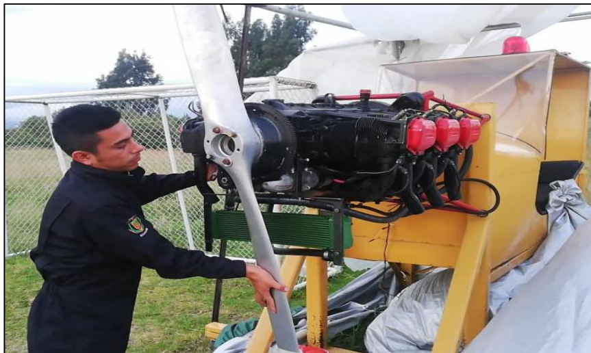
Figura 52. Colocar un tapón adecuado en el orificio de la bujía.
