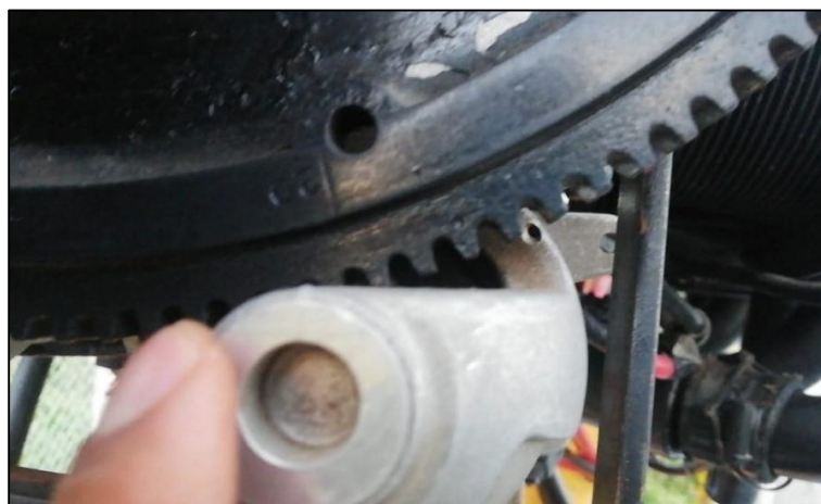
Figura 40. Marca de sincronización 20 grados.
