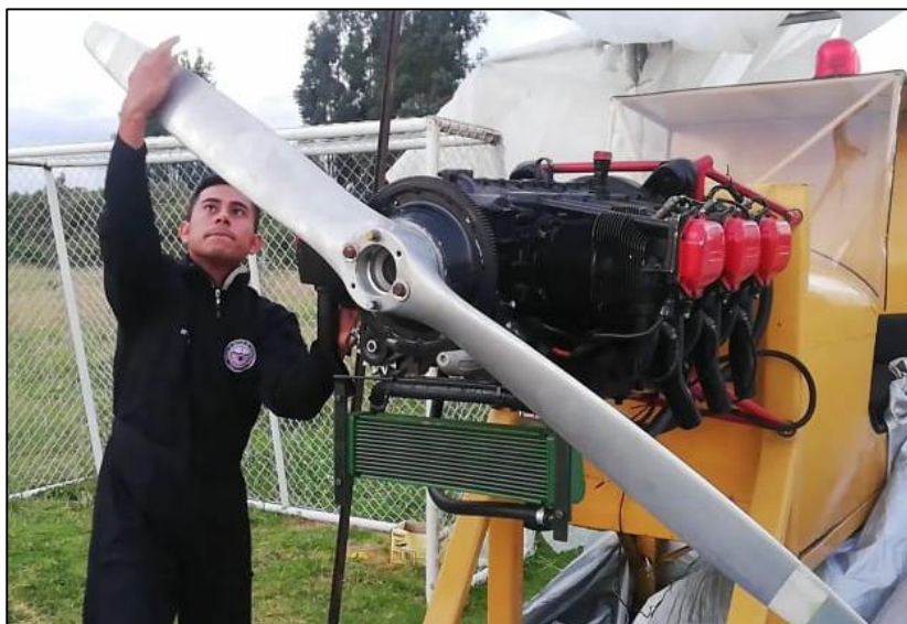
Figura 53. Girando el cigüeñal a través de la hélice.
