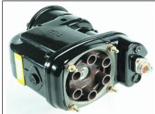
Figura 19. Magneto de alta tensión. Fuente: (Rick Durden, 2016)
