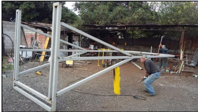
Figura 58. Procedimiento de soldadura de arco eléctrico 6011
