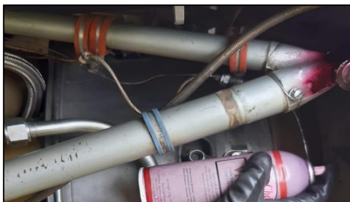
Figura 85. Tinte penetrante al montante superior derecho.
