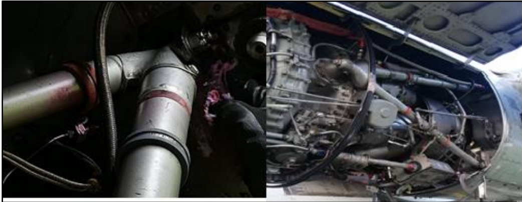
Figura 94. Limpieza y eliminación de tinta removedora.
