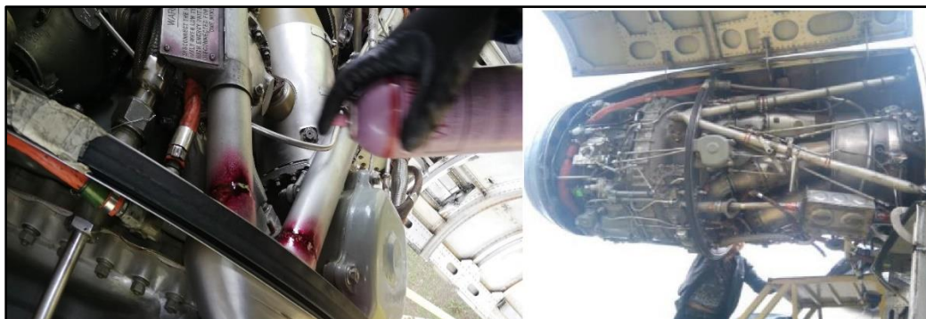
Figura 77. Tintes penetrantes en el tubo estructural.
