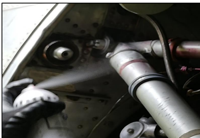
Figura 91. Tinte revelador montante superior izquierdo.
