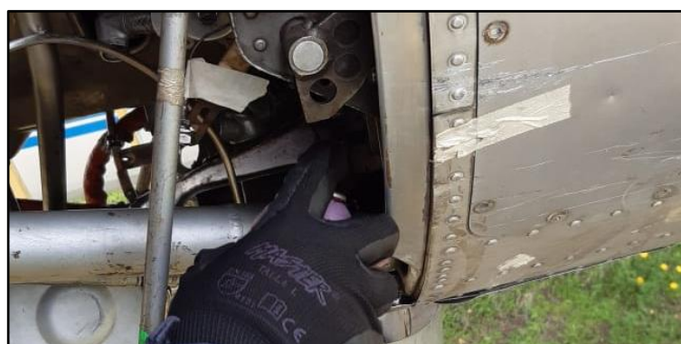
Figura 86. Tinte penetrante al montante inferior derecho.
