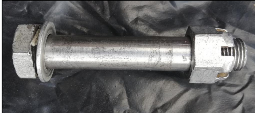
Figura 93. Perno de sujeción moderno a la pared de fuego de la aeronave.
