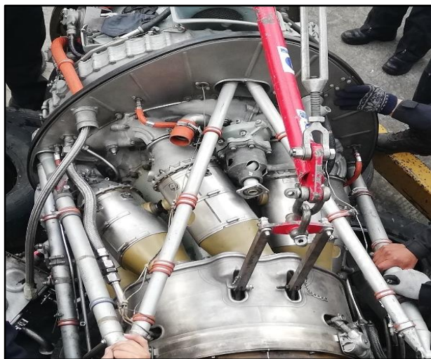
Figura 69. Limpieza e inspección visual al tubo estructural.
