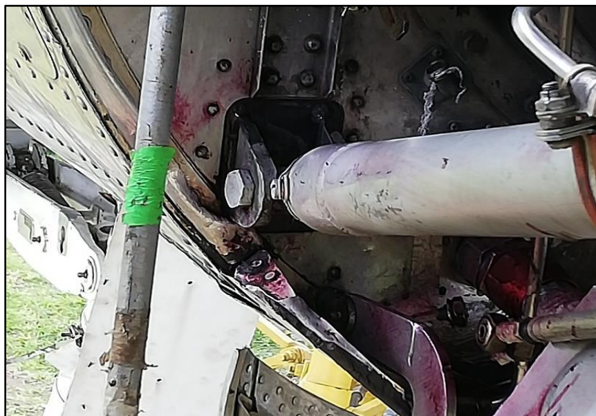
Figura 92. Tinte revelador montante inferior izquierdo.
