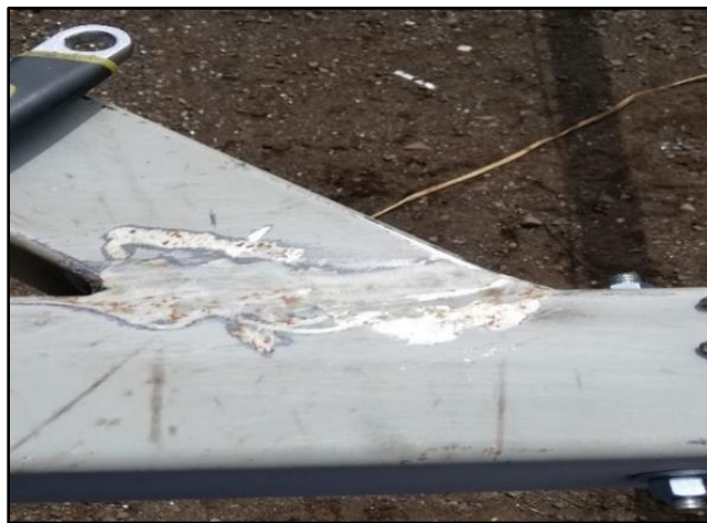
Figura 59. Inserción de la suelda, electrodos 7018
