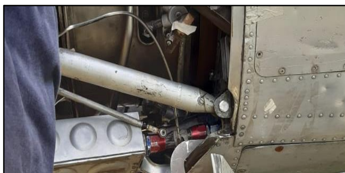
Figura 90. Tinte revelador montante inferior derecho.
