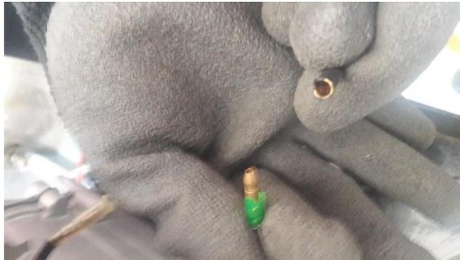
ADVERTENCIA: sujete siempre desde las bases de los acoples nunca hale del cable para evitar una ruptura de la conexión.
