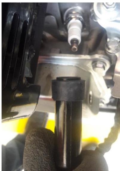
C. Desconecte la bujía del cabezote empleando la herramienta especial
