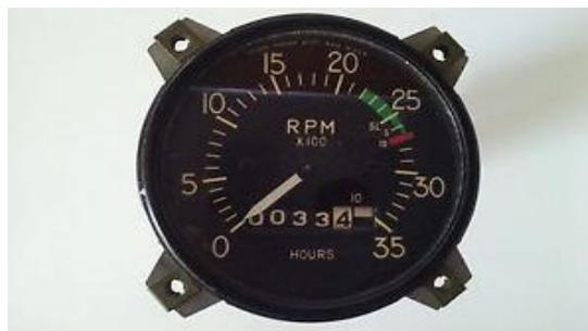
**Figura 46** Indicador Tacómetro.
