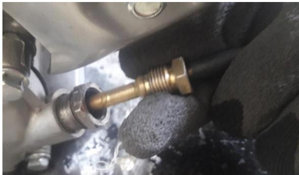
**Figura 79** Instalación de acople ajustable
