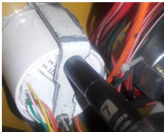
H. Verifique los instrumentos de cantidad de combustible y temperatura de aceite con una pinza de punta redonda.
