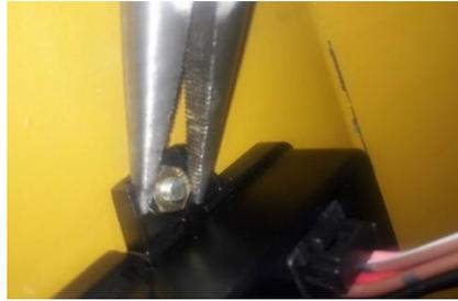
C. Ajuste las bases de caucho del panel empleando la llave número 11.
