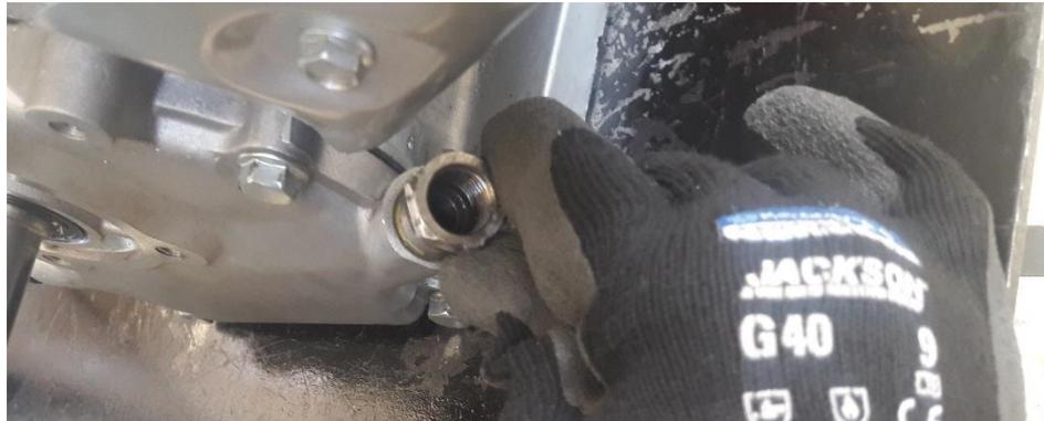
L. Enrosque el bulbo de temperatura en el adaptador.
