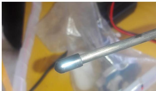
Extienda el cable de la termocupla en el hasta el escape del motor.
