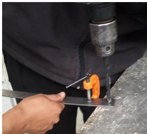
**Figura 82** Perforación de láminas de protección
