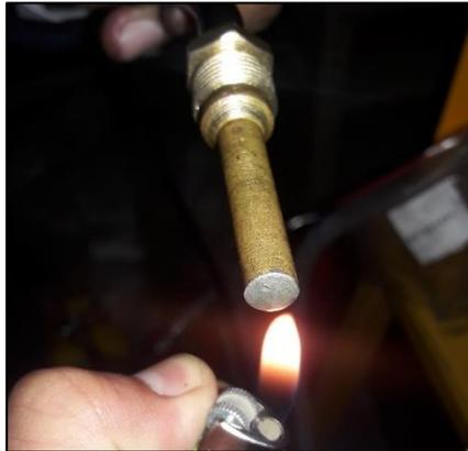
**Figura 56** Prueba de funcionamiento Oil Temp
