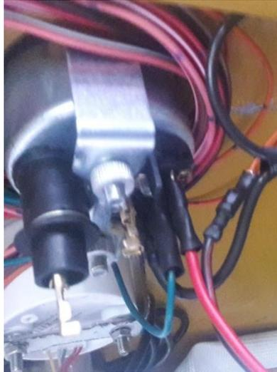
**Figura 85** Protección de cables eléctricos con espaguete.
