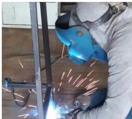
**Figura 68** Soldadura de tubos
