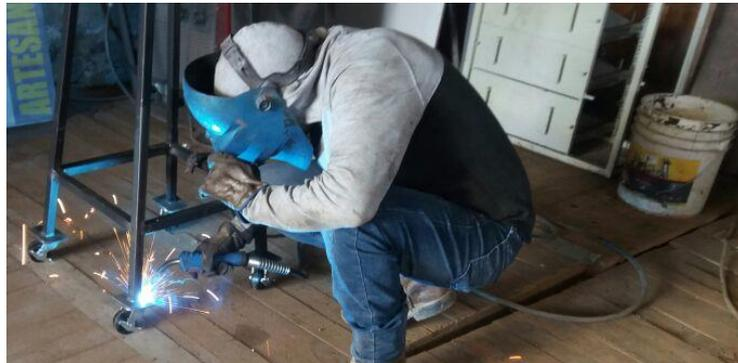
**Figura 69** Soldadura de ruedas
