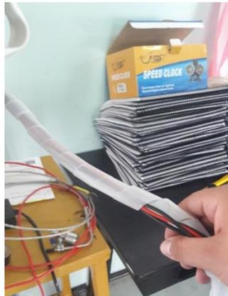
**Figura 84** Protección de cables eléctricos
