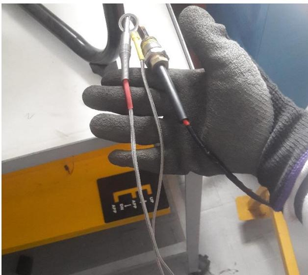
D. Cuando se valla a retirar las termocuplas del motor usar guantes de protección debido a las altas temperaturas del motor.
