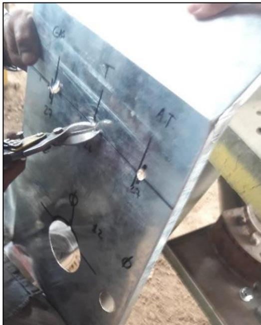
**Figura 72** Perforación del panel para colocación de instrumentos
