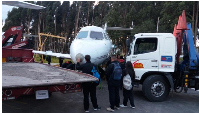
Figura 78: Elevación de las alas para su montaje
