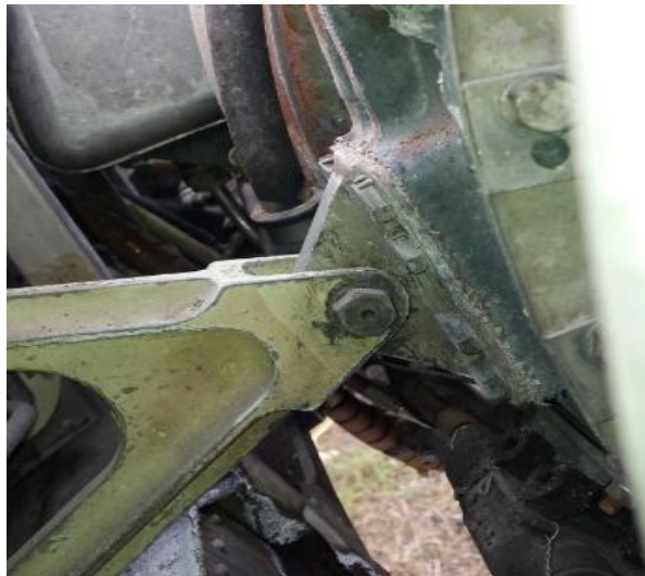
Figura 40: Perno principal inferior de montaje del motor
