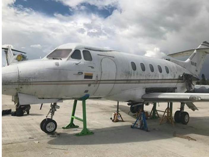
Figura 47: Avión colocado sobre los soportes
