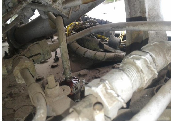
Figura 54:Desconexión de la cañería de combustible
