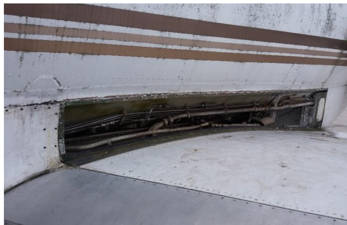
Figura 50:Desmontaje del fairing lateral
