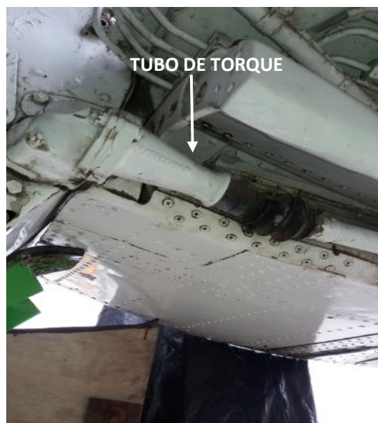
Figura 60:Tubo de torque de control del flap
