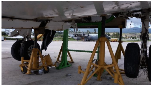
Figura 46: Colocación del soporte posterior del avión
