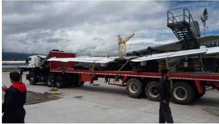
Figura 73:Alas sobre la plataforma cama alta para su traslado
