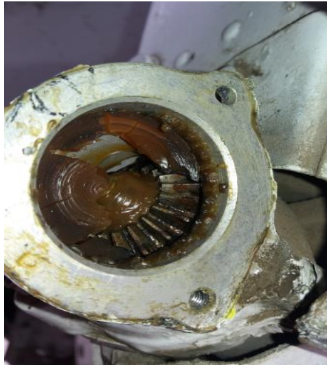
Figura 61: Engrane cónico del tubo de torque de control
