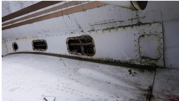
Figura 49:Desmontaje de los paneles de acceso del fairing lateral
