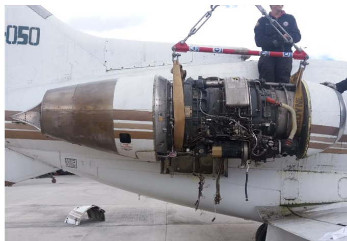
Figura 36: Colocación de la eslinga al motor
