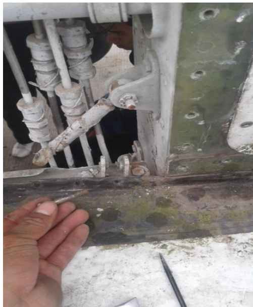
Figura 55:Desconexión del brazo de soporte del flap
