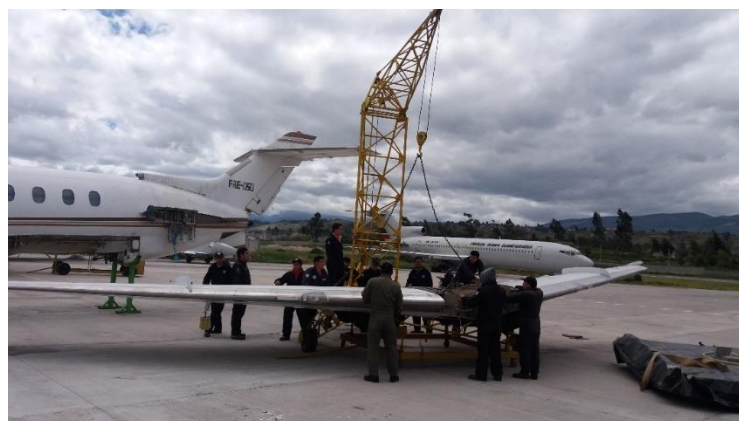
Figura 70: Elevación de las alas de la cama móvil
