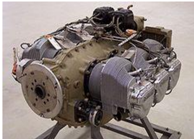
Figura 10:Motor de Cilindros Opuestos
