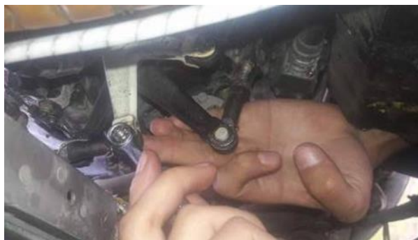
Figura 32: Desconexión de la palanca del acelerador
