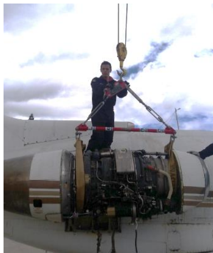
Figura 38:Acoplamiento del tecele a la eslinga
