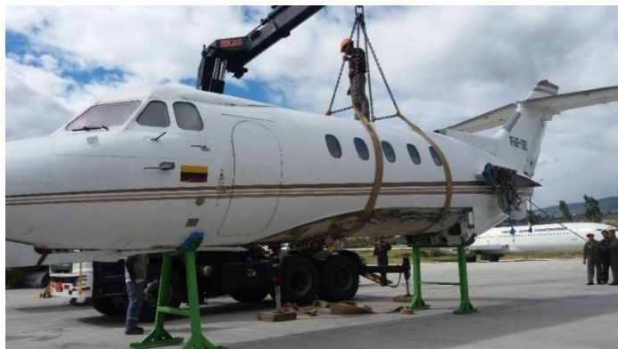
Figura 74:Levantamiento del fuselaje
