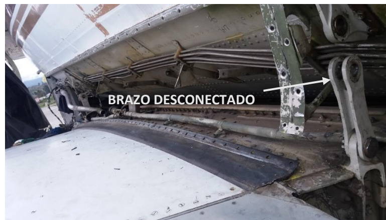
Figura 69: Brazo desconectado del fuselaje
