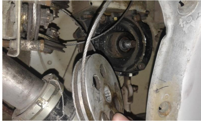
Figura 59:Desmontaje de la polea de los cables del flap
