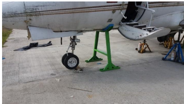
Figura 45: Colocación del soporte delantero del avión
