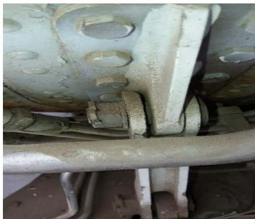
Figura 68:Brazo de sujeción del ala al fuselaje
