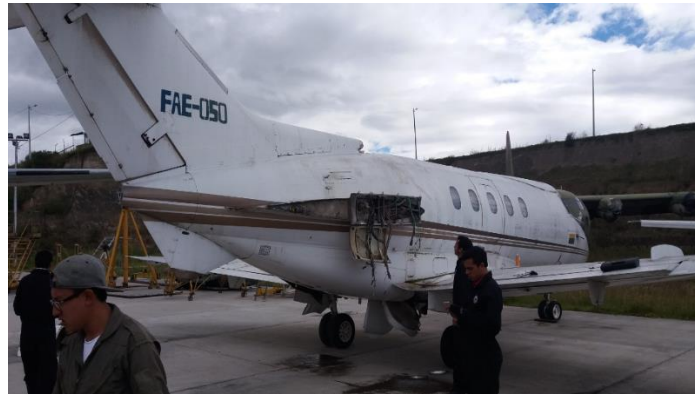
Figura 43:Desmontaje del motor
