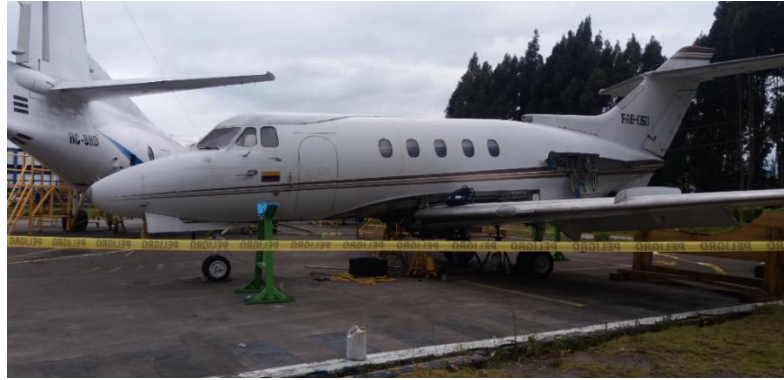
Figura 80: Avión con las ruedas frenadas y bloqueadas
