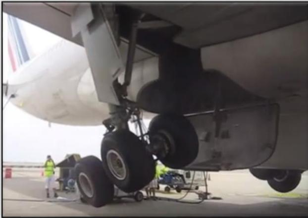
Con las puertas están abierta libera el retenedor de las patas del tren, y a su vez afloja la presión hidráulica del martinete de retracción, esto permite bajar por gravedad el tren, hasta quedar bloqueado en su posición para el aterrizaje
