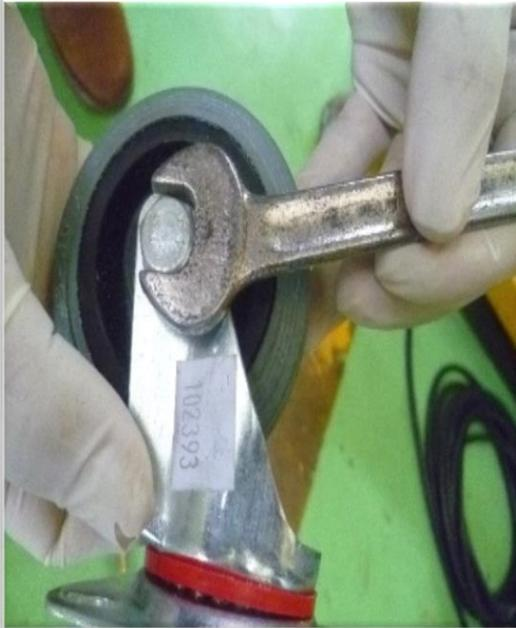
Se realizó una inspección visual y se pudo constatar el mal estado de las 4 llantas por lo que fue necesario cambiarlas mediante la utilización de un juego de llaves 7/16 pulgadas
