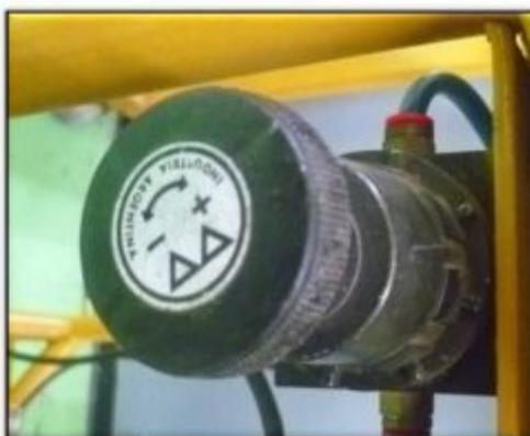
**Figura 41** Válvula reguladora de presión
