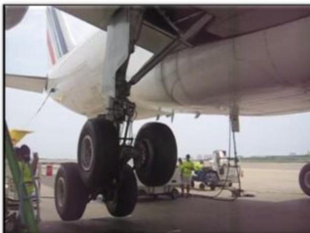
**Figura 29** Retracción del tren
