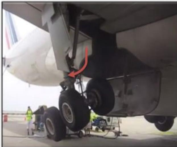
**Figura 28** Retracción del tren
