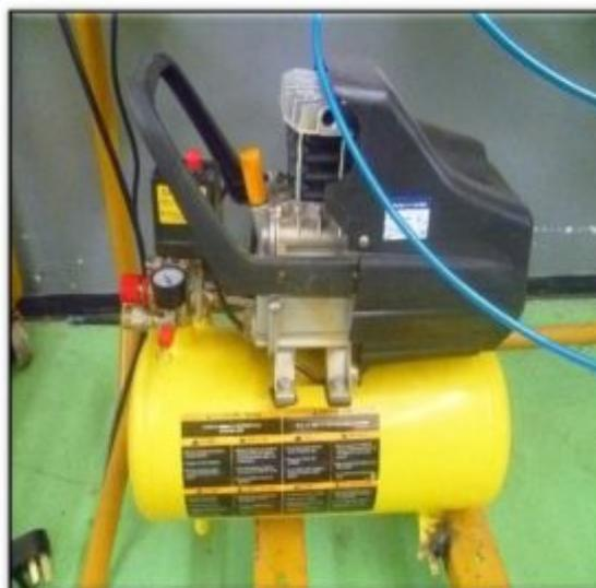
**Figura 56** Compresor soldado a la estructura
