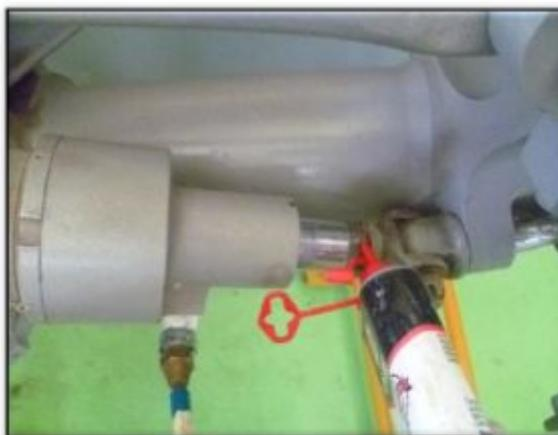
**Figura 47** Lubricación del actuador
