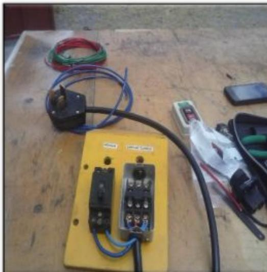
**Figura 65** Conexión braker al switch térmico
