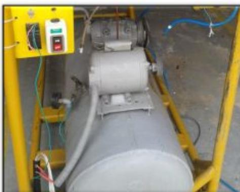
**Figura 40** Desmontaje del compresor
