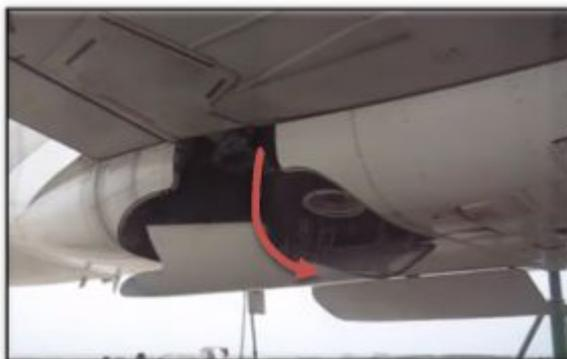
**Figura 27** Apertura de compuertas
