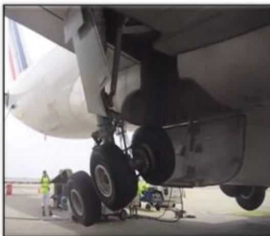
**Figura 25** Retracción del tren.
