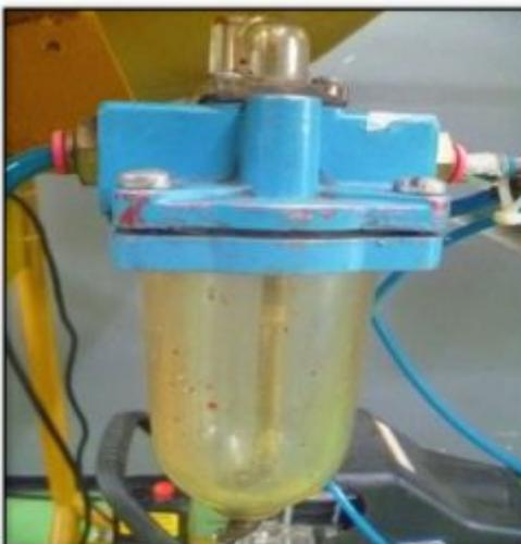
**Figura 58** Instalación del filtro de aire
