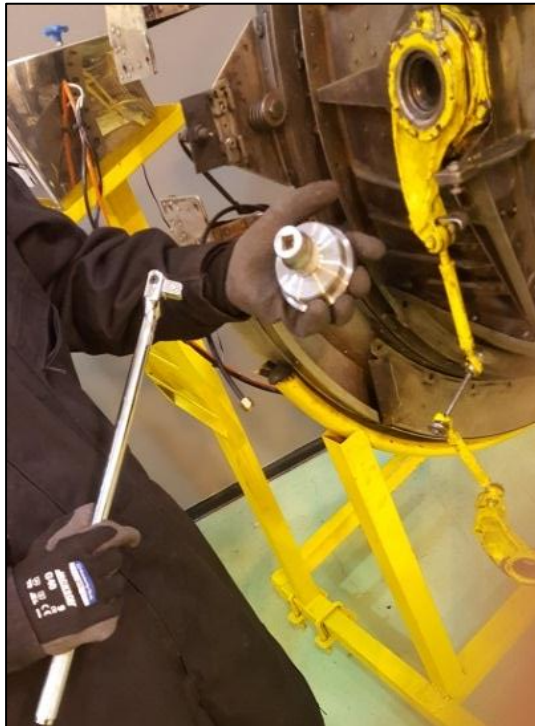
FIGURA 30 Utilización de la Herramienta Especial
