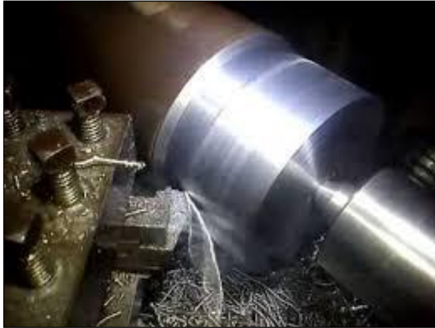
FIGURA 21 Eje siendo Trabajado en el torno.
