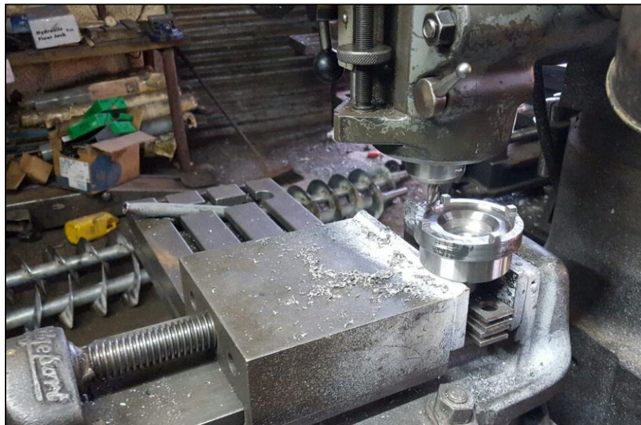
FIGURA 22 Herramienta Especial casi terminada en la fresadora.
