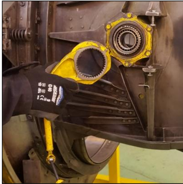
FIGURA 31 Remoción del Segundo Brazo
