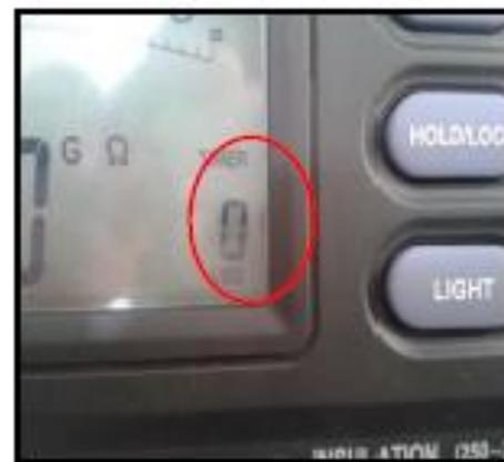
Y en el centro de la pantalla se expondrá la resistencia de aislamiento resultante del elemento que fue sometido a la prueba.
