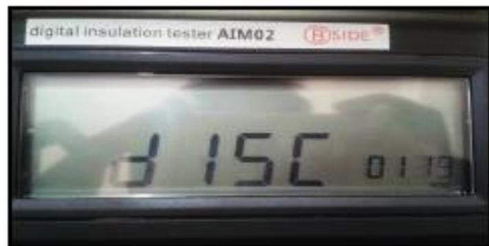
**Advertencia:** Cuando el equipo este descargando la tensión usada en la prueba, no gire el interruptor para evitar daños al medidor.
