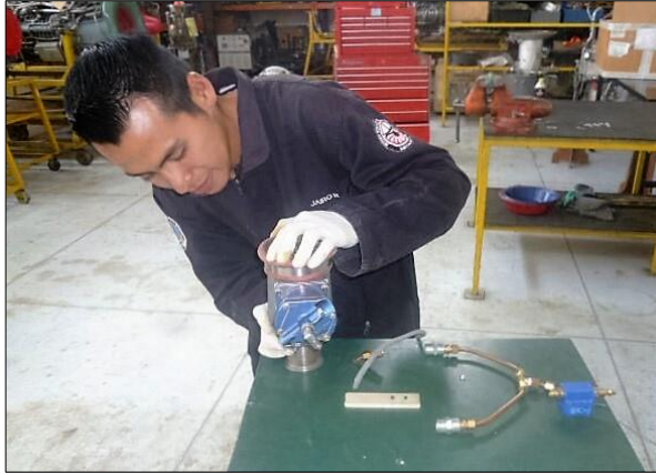
Figura 40 Instalación de la válvula de descarga
