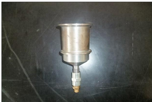
Figura 37 Toma de aire de descarga
