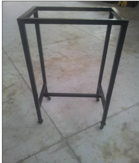
Figura 30 Estructura metálica del banco de pruebas
