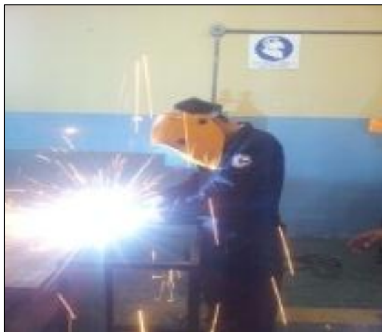
Figura 28 Soldadura de la estructura metálica del banco
