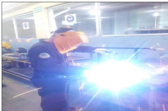
Figura 29 Soldadura de las ruedas del banco de pruebas
