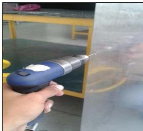
Figura 31 Perforación de la estructura metálica del banco de pruebas
