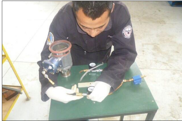
Figura 42 Instalación de la línea flexible al manómetro
