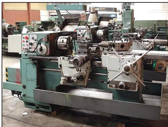
**Figura 42 Torno Revolver**
