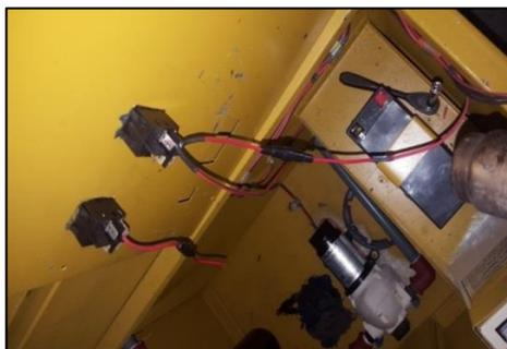
**Figura 92 Instalación de los push buttons**
