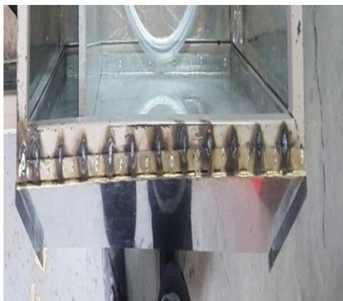
**Figura 78 Soldadura de las bisagras**
