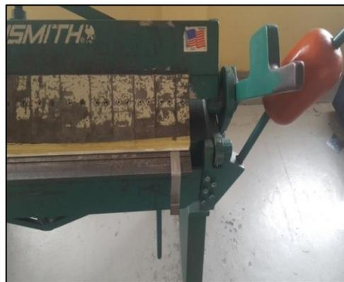
**Figura 63 Doblado de la plancha de tool**
