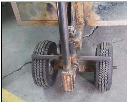
**Figura 74 Instalación del brazo y el soporte horizontal**
