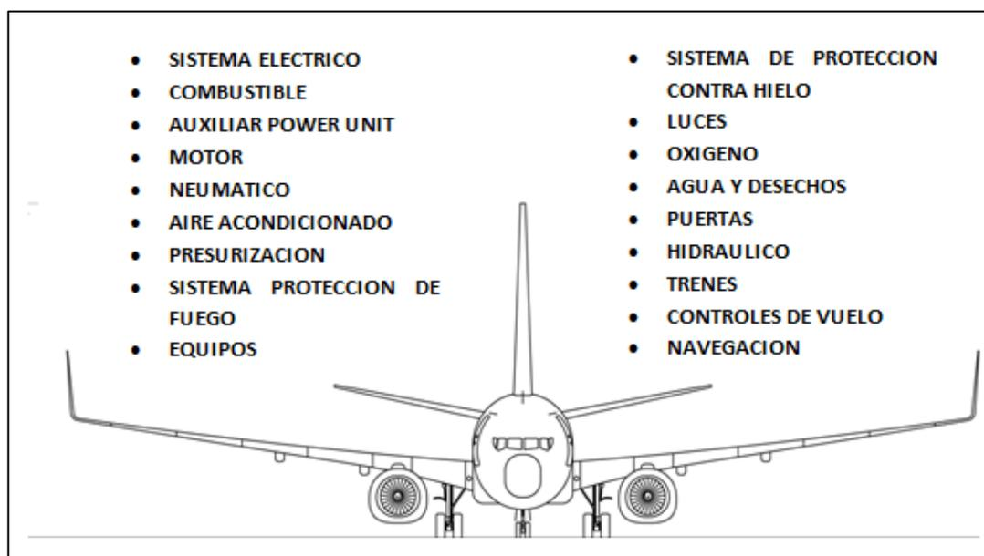
**Figura 5 Avión Boeing 737 Sistemas Principales**
