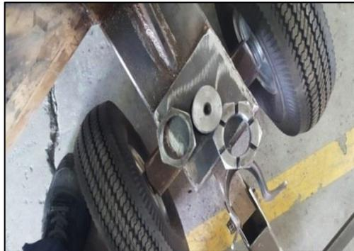
**Figura 73 Instalación de la tuerca de castilla**
