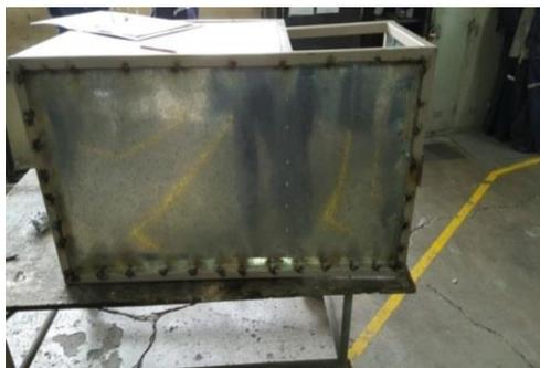
**Figura 64 Soldadura de la parte inferior de la estructura**
