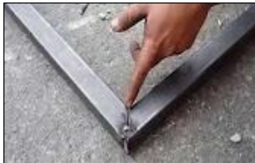
**Figura 58 Soldadura punteado de las piezas**
