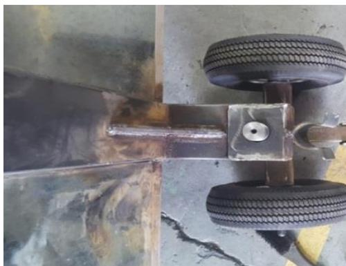
**Figura 72 Instalación del Soporte horizontal**
