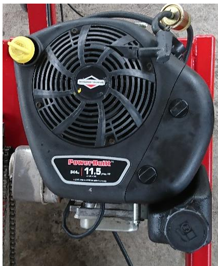
Figura 52 Instalación del Motor
