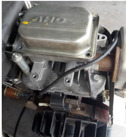
Figura 29 Remoción del Cobertor de Balancines
