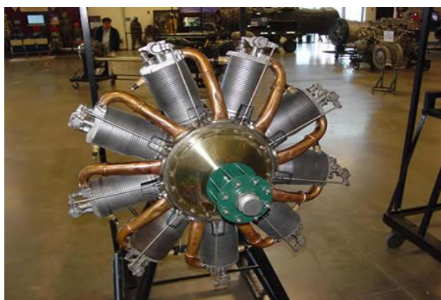
Figura 2 Motor Rotativo Le Rhone 9
