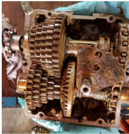
Figura 43 Estado Interno de la Transmisión
