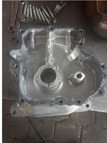
Figura 38 Reemplazo de Empaque del Cáster
