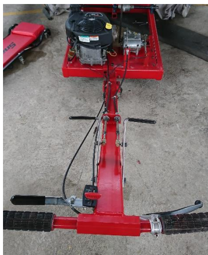
Figura 58 Instalación de Cables de Control
