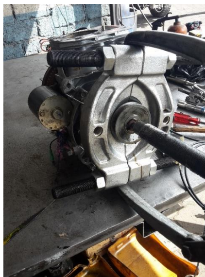
Figura 31 Remoción del Volante del eje del Motor
