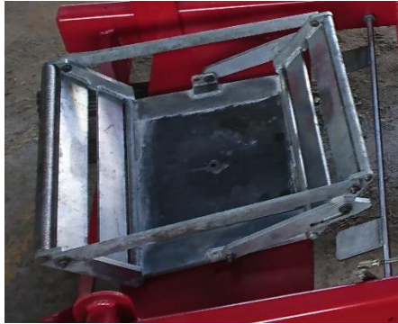
Figura 59 Instalación de Canasta de Transporte
