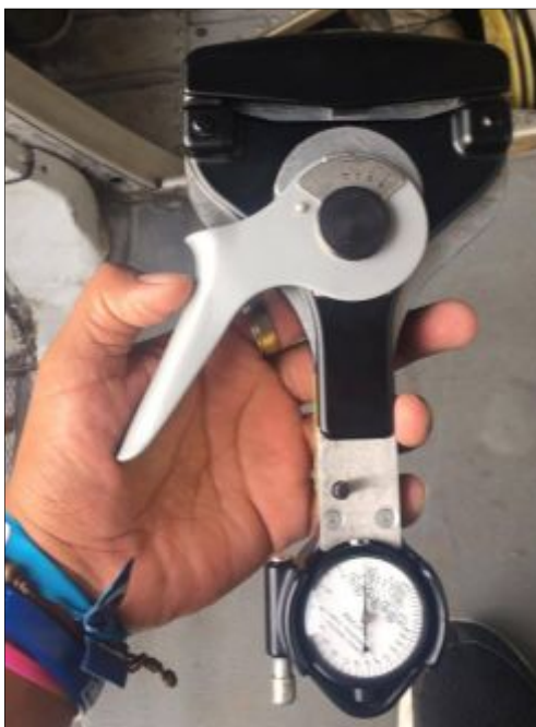
Figura 52 Ubicación del tensiómetro en los cables.
