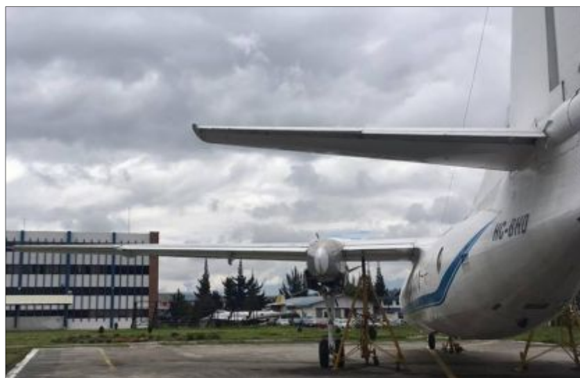
Figura 39 Superficie alar alineada.
