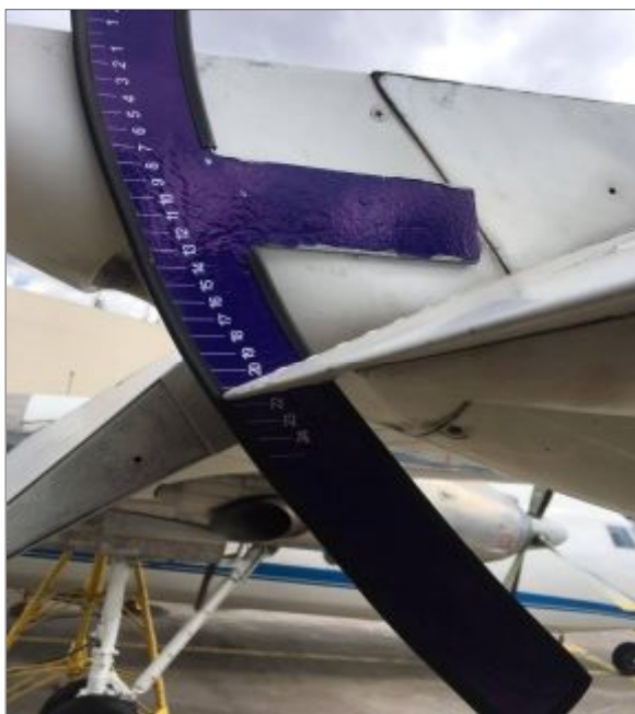
Figura 49 Medición de desplazamiento inferior.
