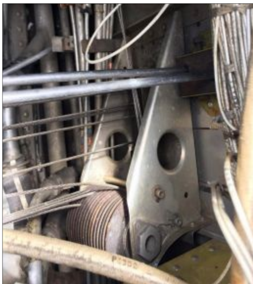
Figura 42 Cables y poleas.
