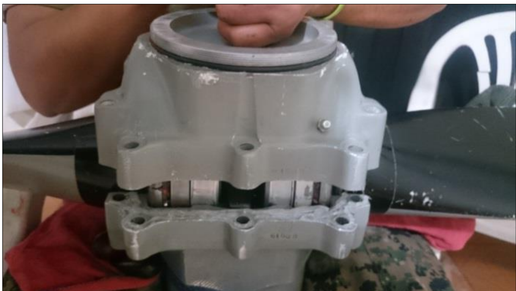
Figura 43 Montaje del cubo
