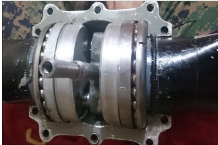
Figura 38 Montaje de las carreras y rodamientos de bolas
