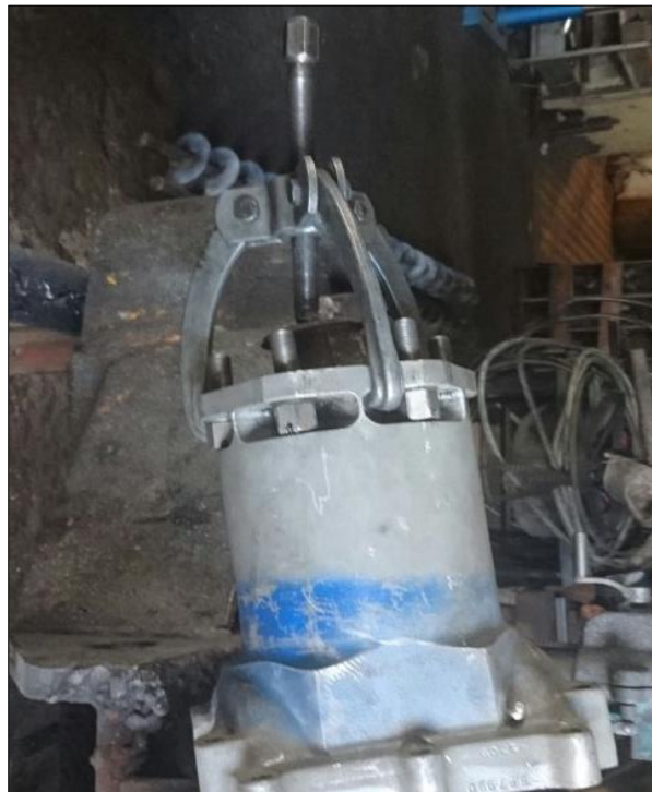
Figura 41 Montaje del seguro del resorte con el santiago
