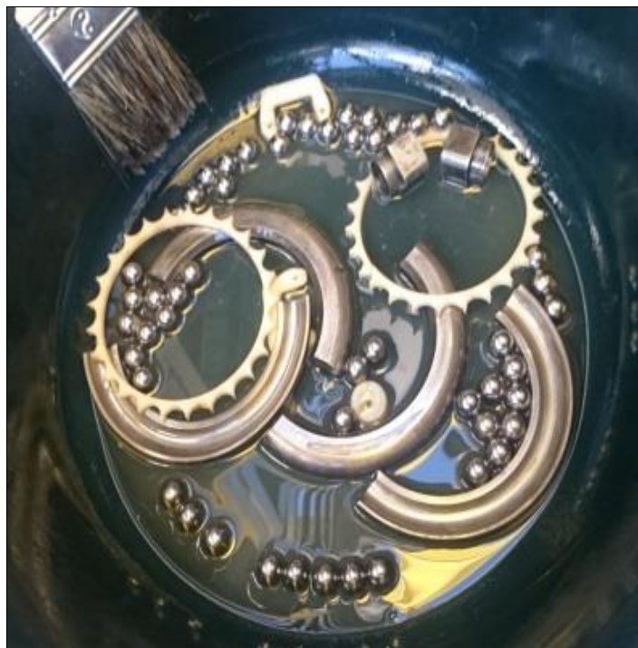
Figura 29 Limpieza de la carrera de rodamientos, rodamientos de bolas y separador de bolas
