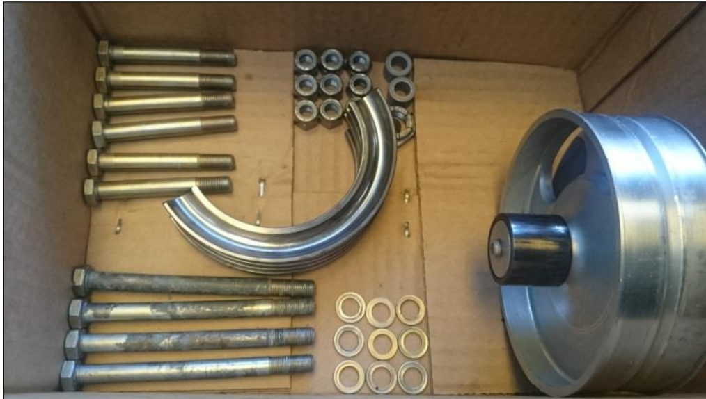
Figura 32 Ordenamiento de los componentes limpios
