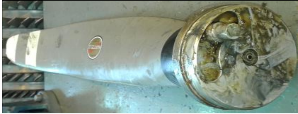
Figura 25 Desmontaje de la pala
