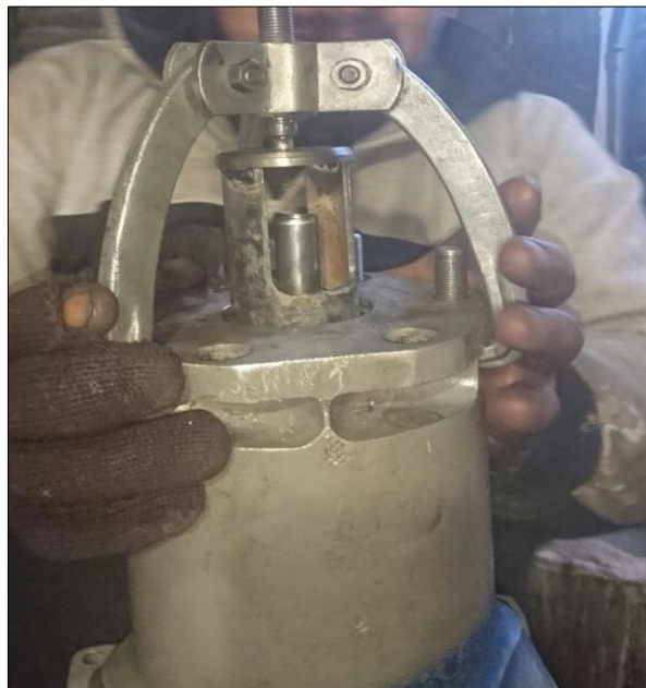
Figura 23 Remoción del seguro de los resortes con el santiago y su acople
