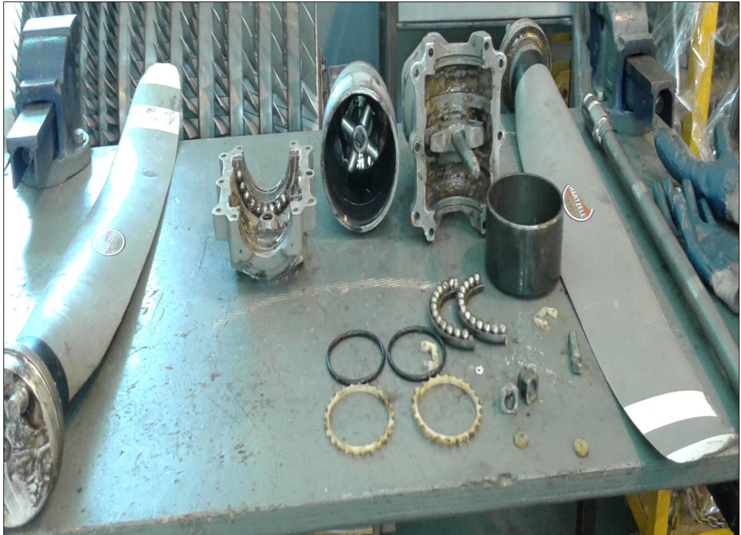
Figura 28 Desmontaje de la hélice con sus partes
