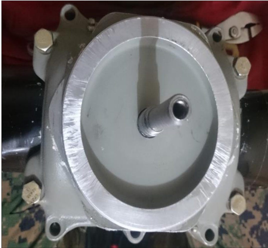
Figura 44 Montaje de los pernos largos, cortos, arandelas y pernos del cubo
