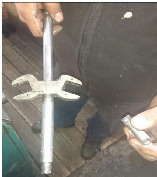
Figura 27 Desmontaje de la varilla de cambio de paso
