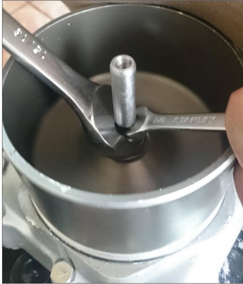
Figura 45 Montaje del pistón del cilindro
