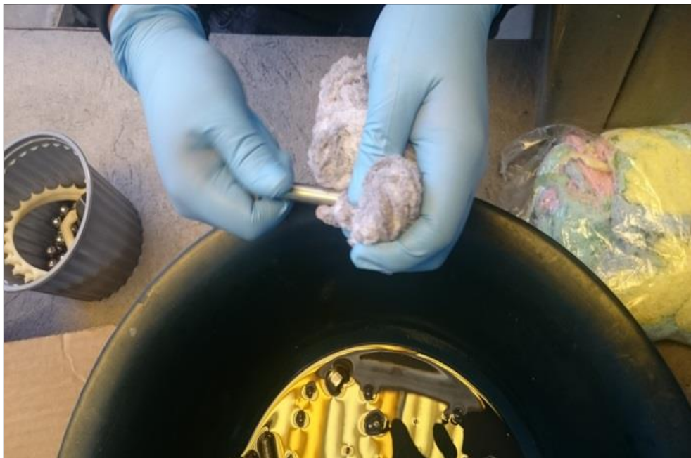
Figura 31 Limpieza de los pernos del cubo
