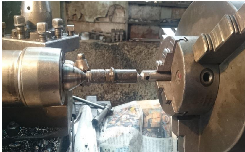
Figura 34 Varilla de cambio de paso soldada
