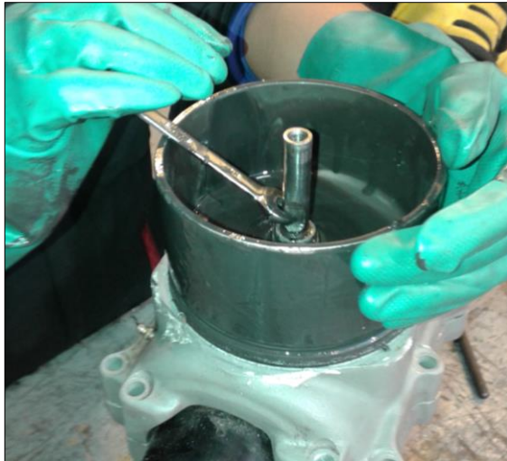
Figura 18 Remoción de la tuerca del pistón
