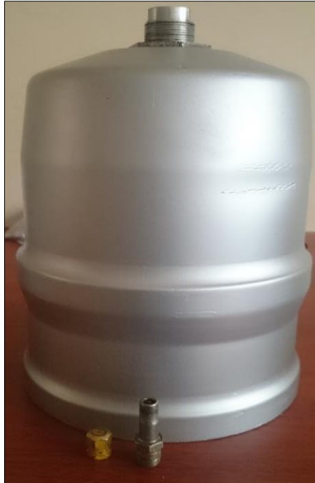
Figura 15 Desmontaje de la válvula de aire
