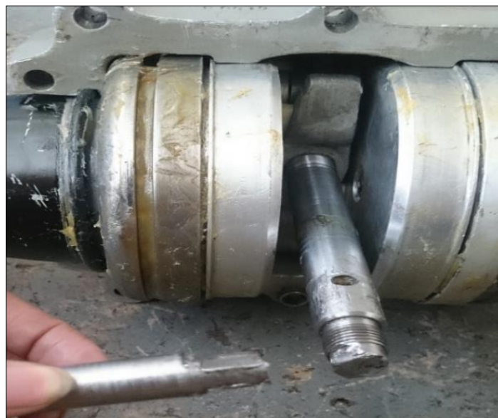
Figura 33 Varilla de cambio de paso rota
