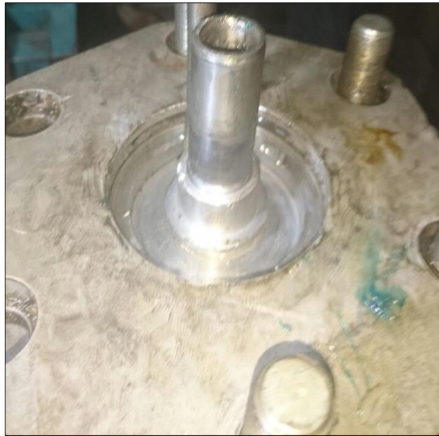
Figura 22 Tapa del retenedor de los resortes
