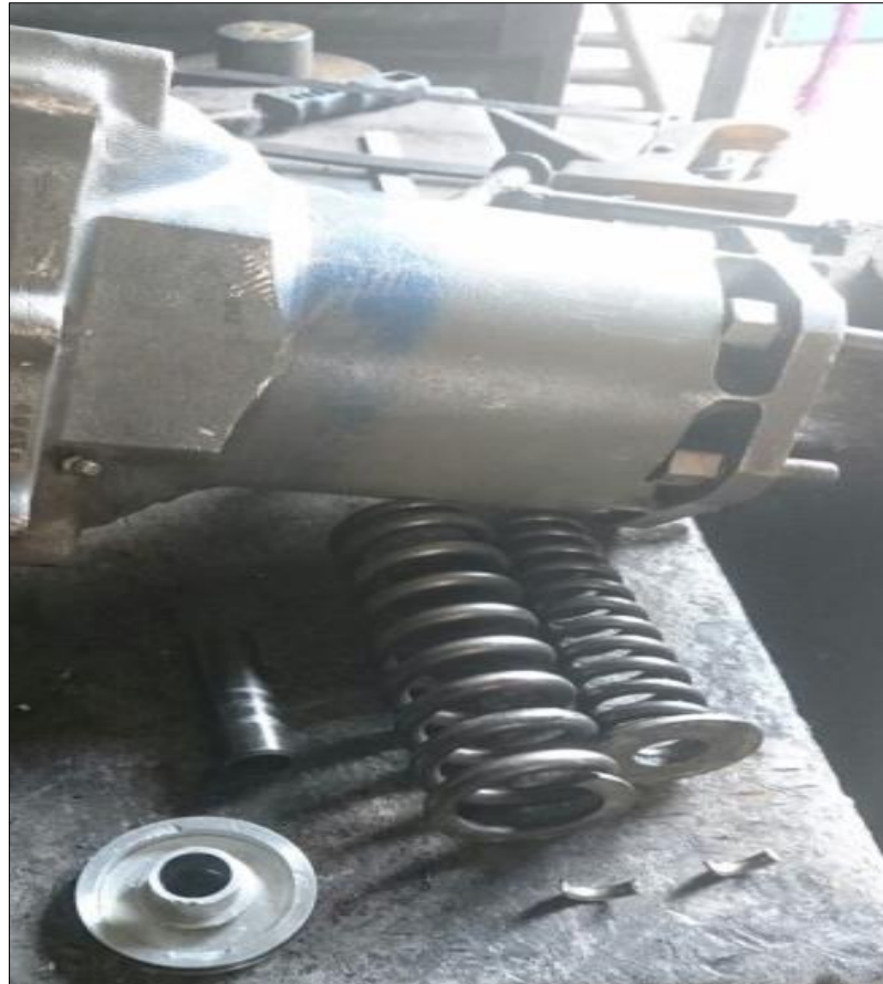
Figura 24 Desmontaje de los resortes
