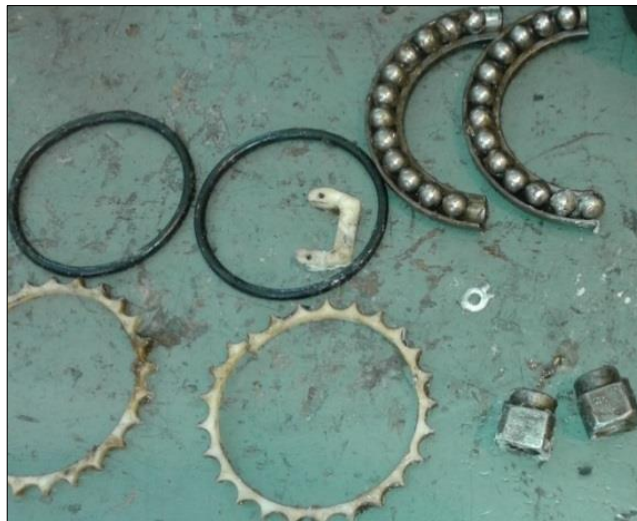
Figura 26 Desmontaje de rodamientos, separador de bola, horquillas, bloques de cambio de paso y o-ring.
