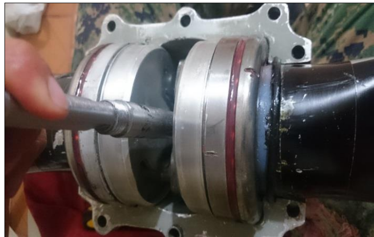
Figura 39 Colocación de grasa en los rodamientos de bola
