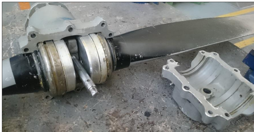
Figura 21 Desmontaje del cubo
