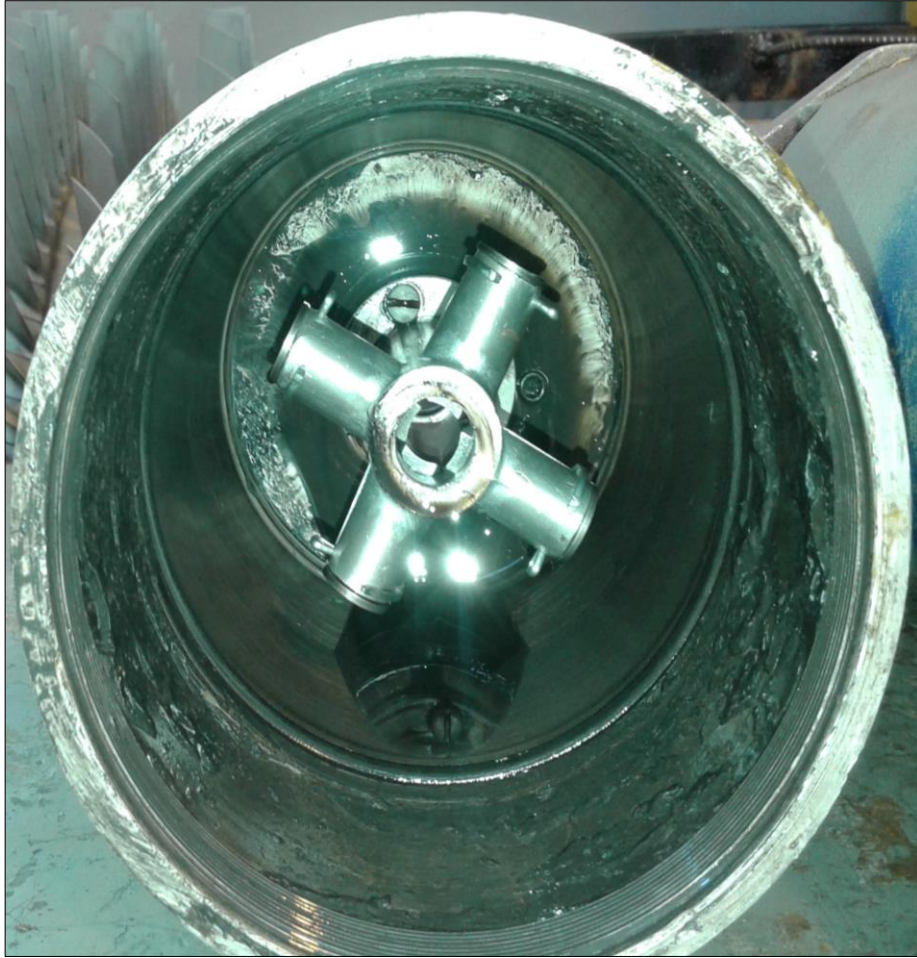
Figura 17 Desmontaje de la unidad de bloqueo de arranque del cilindro
