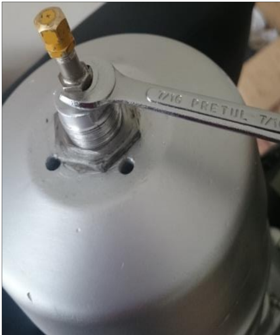
Figura 48 Montaje de la válvula de aire
