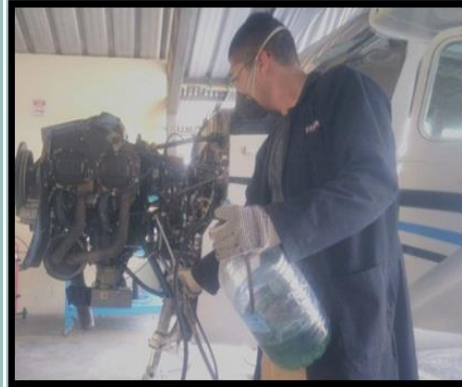
Limpieza del motor
