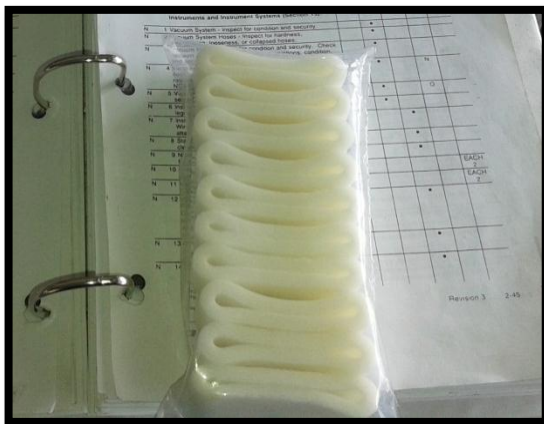
Figura 174 Filtro nuevo de vacío.
