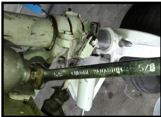
Figura 153 Desmontaje del filtro.
