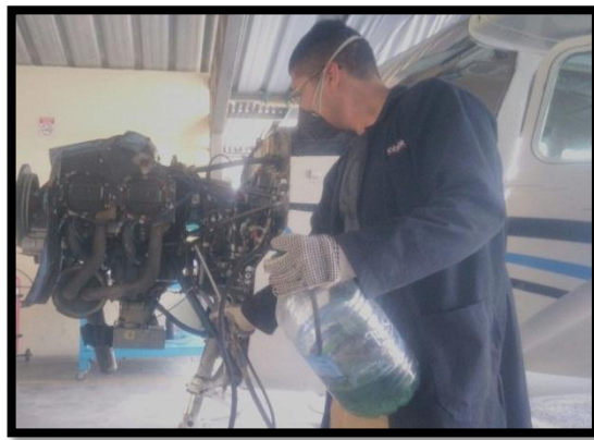
Figura 111 Limpieza del motor.
