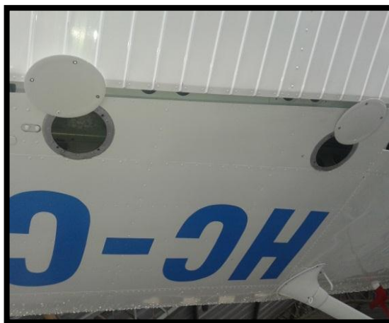
Figura 63 Tapas de inspección.
