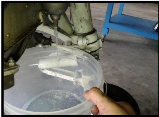
Figura 152 Drenaje de combustible.
