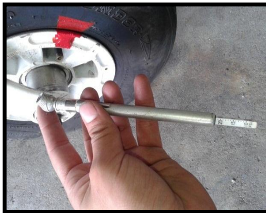
Figura 75 Verificación de presión.
