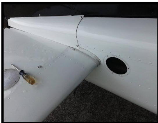
Figura 96 Puertas de inspección del elevador.
