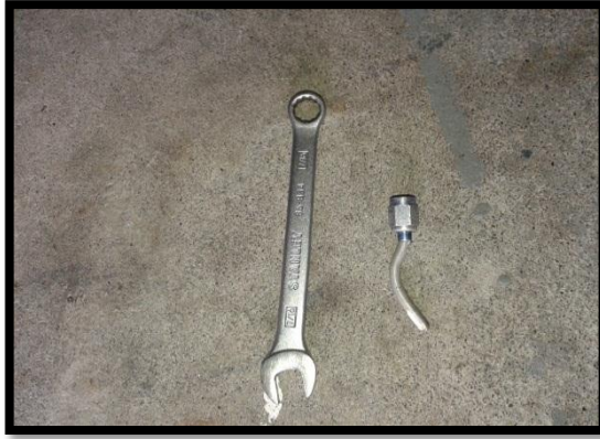
Figura 151 Tubo de drenaje del filtro.
