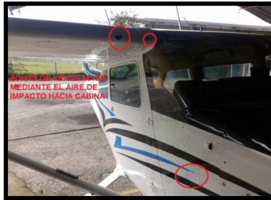
Figura 14 Entradas de ventilación.
