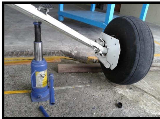
Figura 67 Levantamiento del puntal.
