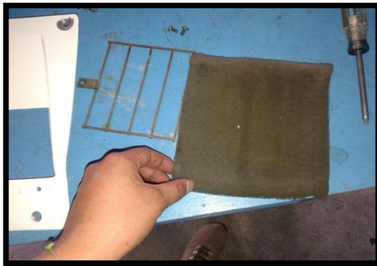
Figura 119 Filtro de aire.
