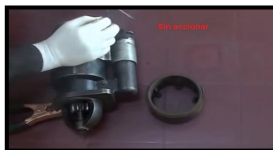
Figura 10 Motor de arranque apagado.
