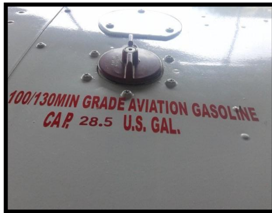
Figura 148 Etiquetas de tanques.
