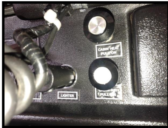
Figura 167 Controles de climatización.
