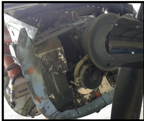
Figura 141 Deflectores y sellos del motor.
