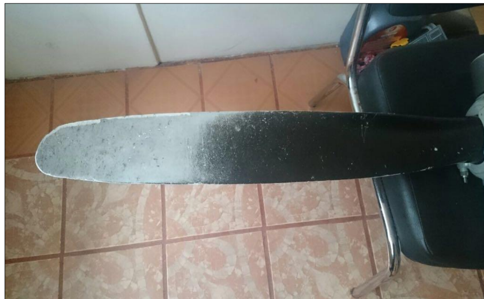
Figura 8 Pala con corrosión
