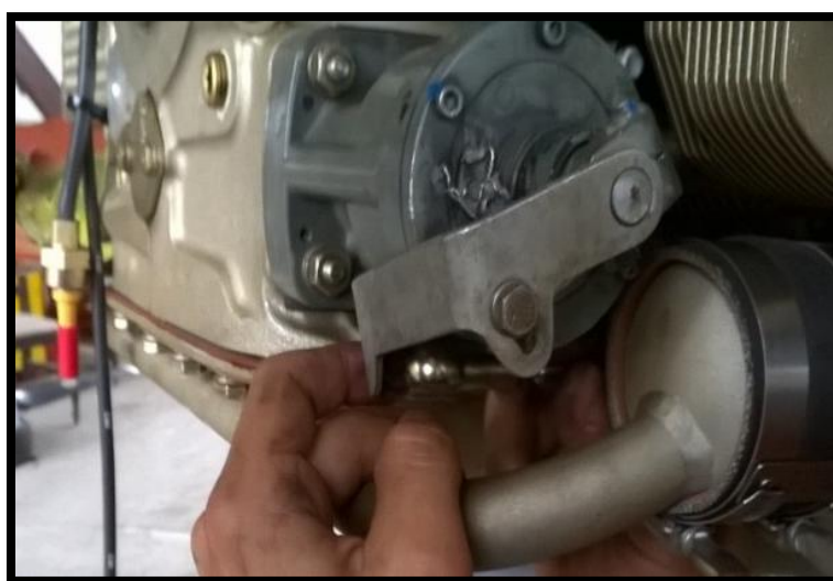
Figura 61. Instalación del gobernador de la hélice
