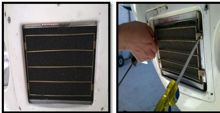
Figura 68. Cambio del filtro de aire
