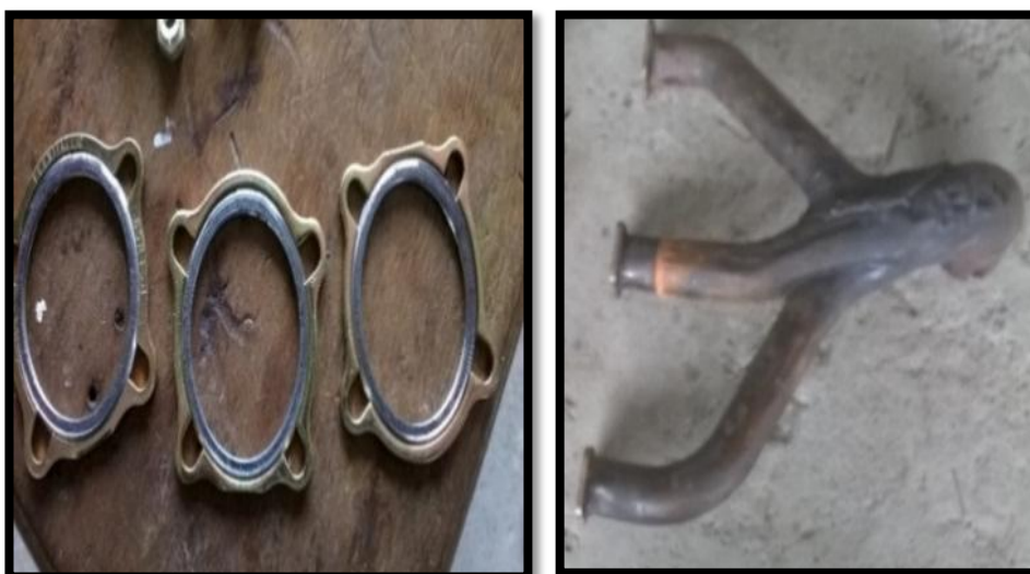
Figura 62. Instalación de los empaques y ductos de admisión
