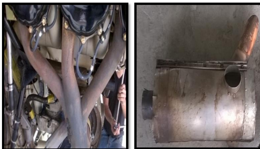
Figura 64. Instalación del silenciador (MUFFLER)
