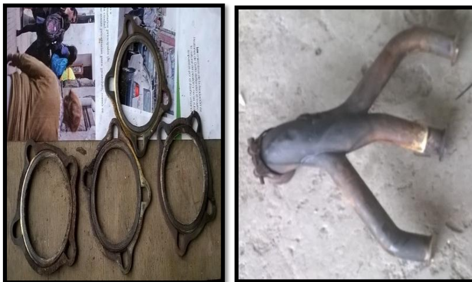
Figura 63. Instalación de los empaques y ductos de escape
