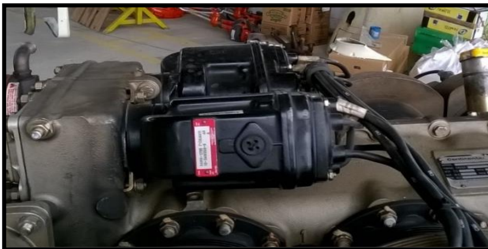
Figura 59. Instalación de las magnetos y calibración
