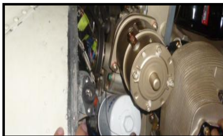
Figura 56. Instalación del motor de arranque
