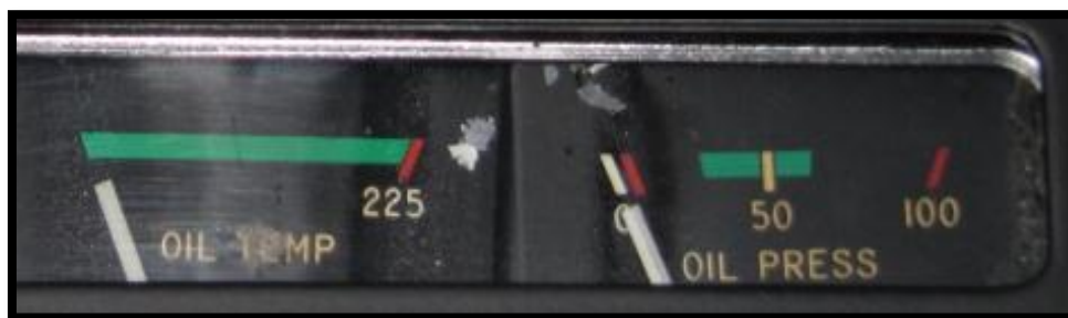
Figura 26. Instrumento medidor de temperatura y presión del aceite
