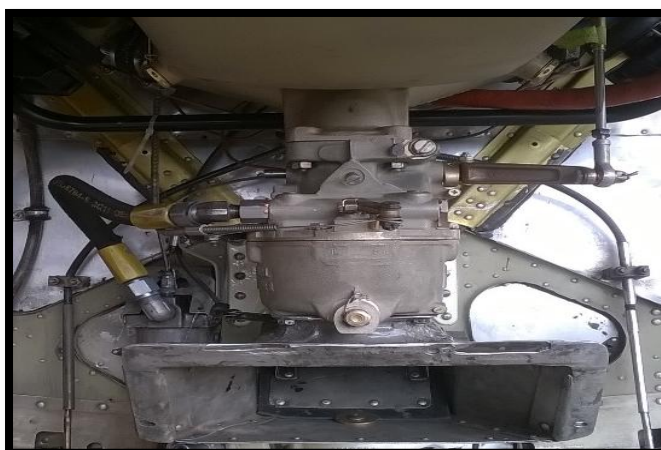
Figura 57. Instalación del carburador y la entrada de aire.
