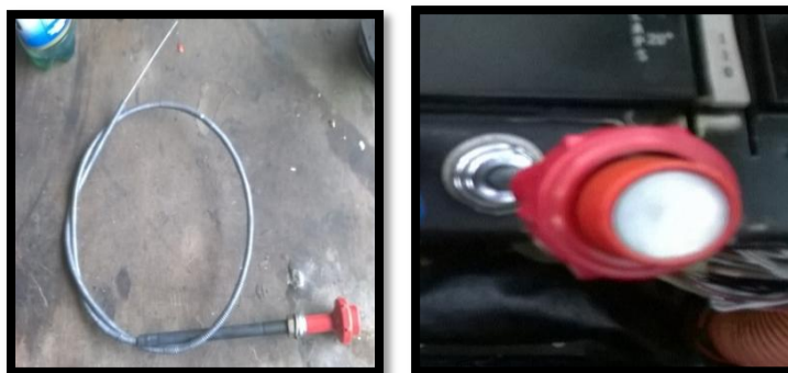
Figura 50. Instalación del cable del control de mezcla
