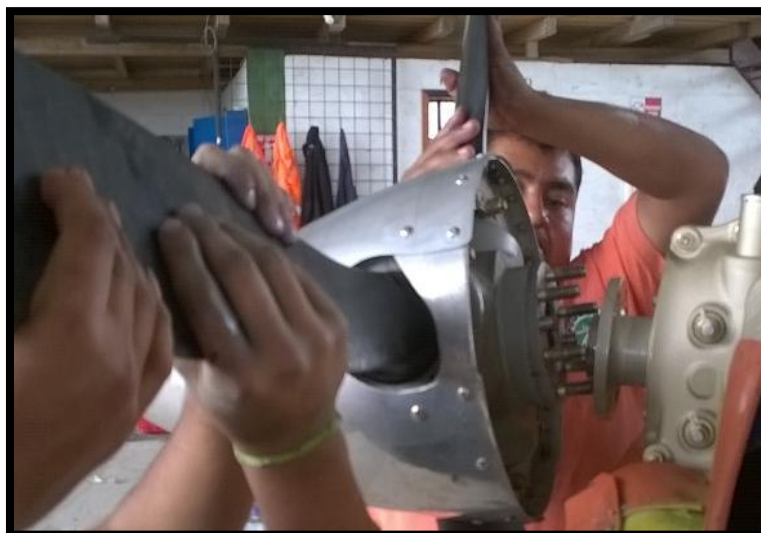
Figura 60. Instalación de la hélice
