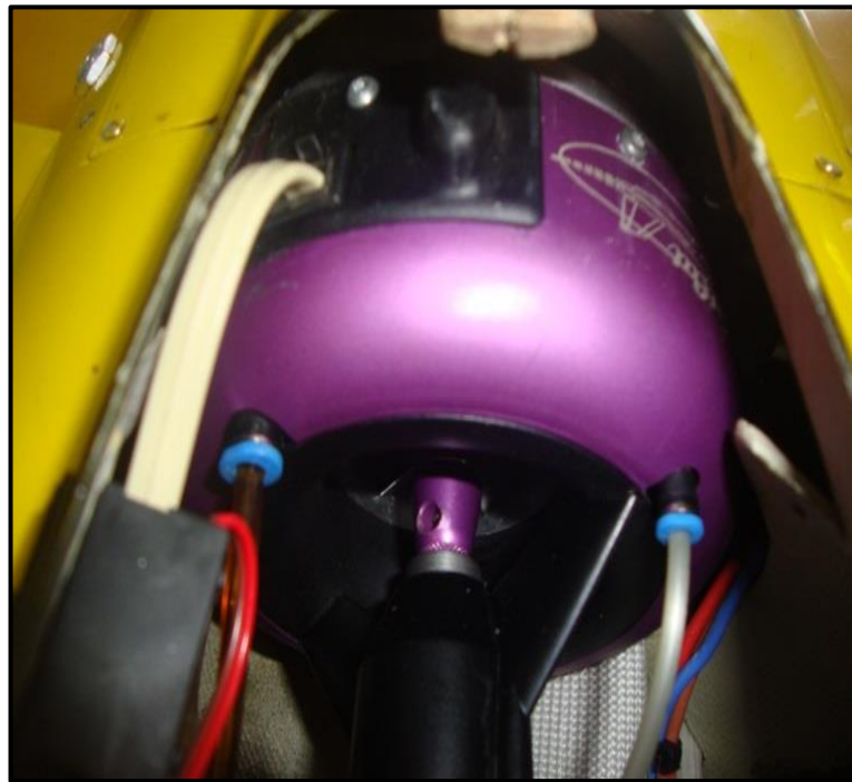
Figura 75 Conexiones de los cables al motor.
