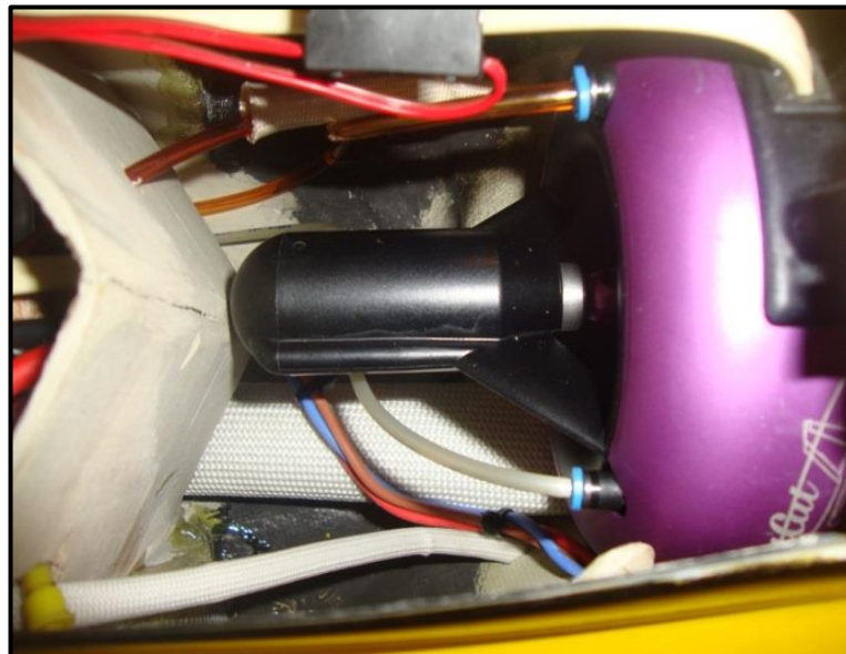
Figura 74 Líneas de propano y combustible.
