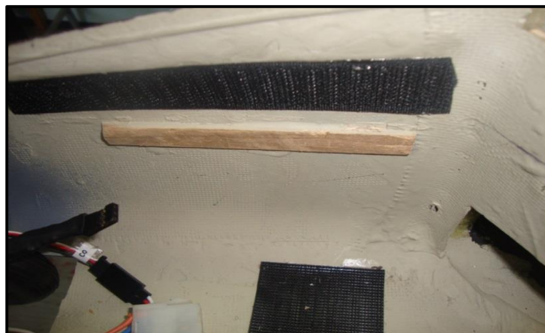
Figura 70 Velcro dentro del fuselaje.
