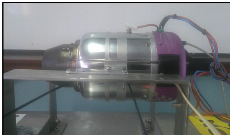
Figura 51 Motor en el banco de pruebas.
