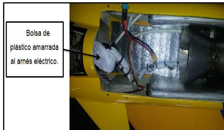
Figura 12 Envoltura del arnes eléctrico.
