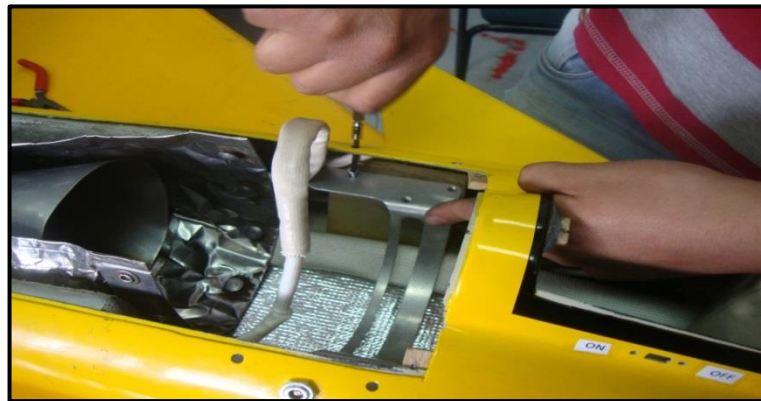
Figura 67 Instalación del montante del motor.
