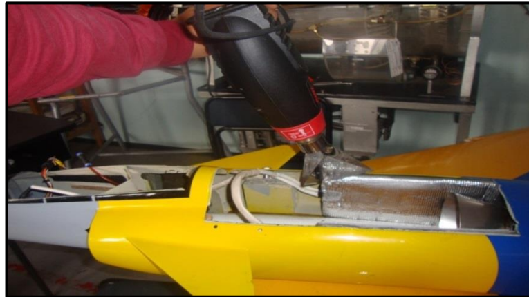
Figura 62 Remoción del protector térmico de los tanques.
