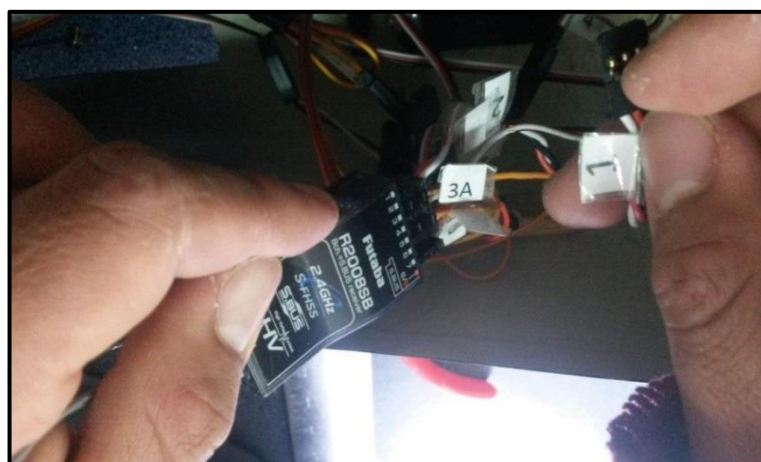
Figura 23 Desinstalación del canal número uno.
