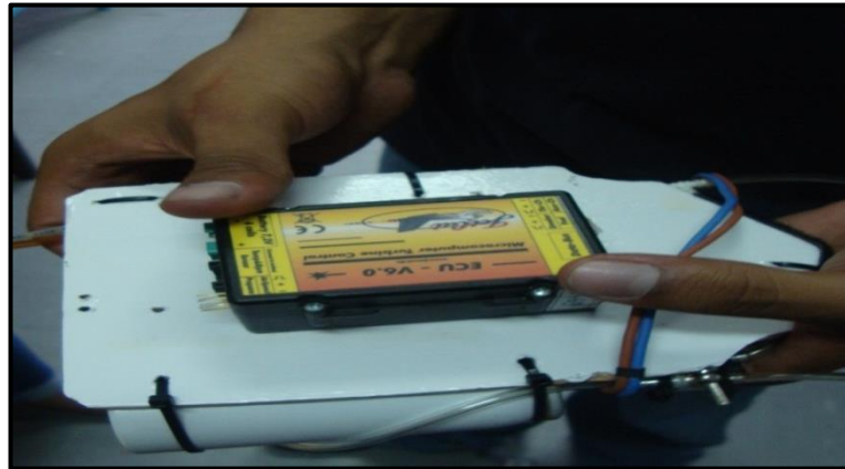
Figura 50 Sujeción de la EC V6.0
