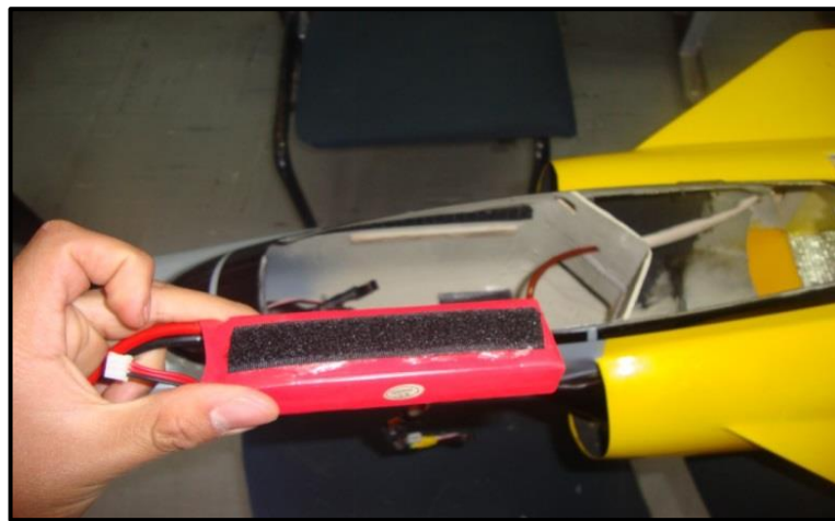
Figura 69 Batería con velcro.
