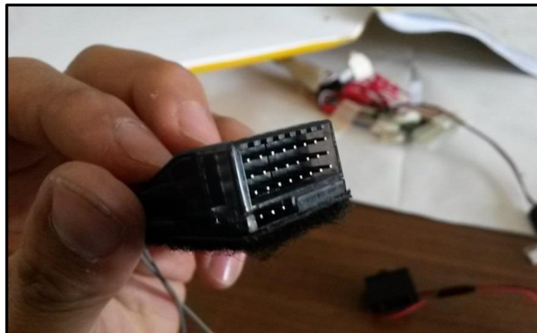
Figura 29 Control receptor desinstalado.
