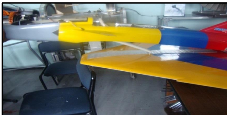
Figura 66 Unión de las alas con el fuselaje.
