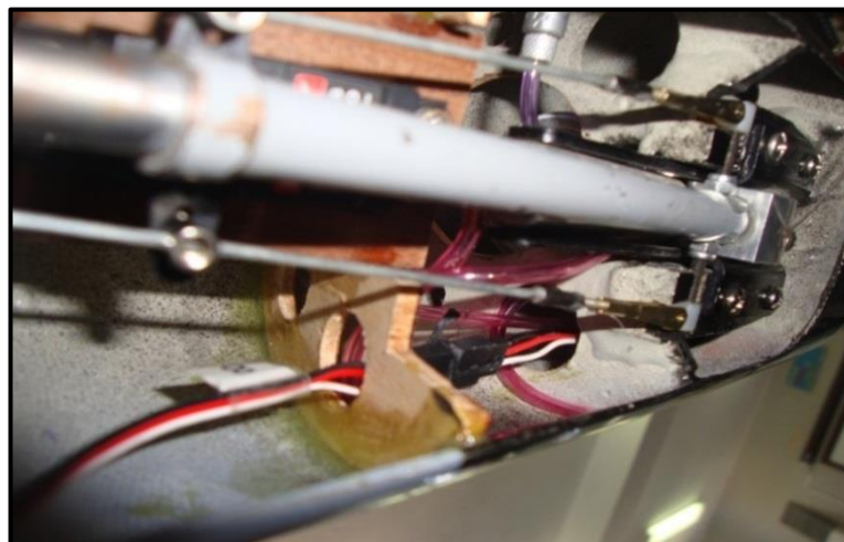
Figura 44 Union del cable del servo en el tren principal.
