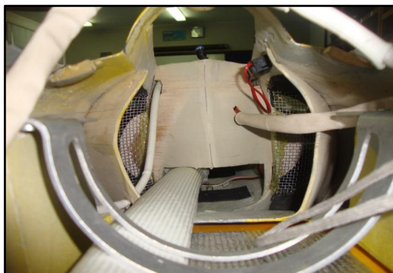
Figura 46 Compartimiento del motor cubierto con protector térmico.
