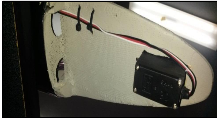
Figura 20 Cable del servo del tren de nariz.
