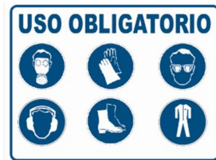
Figura 38: EPP's de uso obligatorio para el uso del equipo
