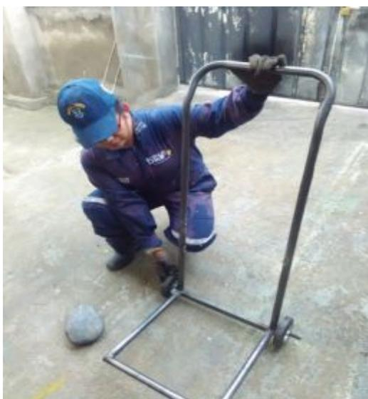
**Figura 20:** Instalación de los ejes y ruedas de transporte
