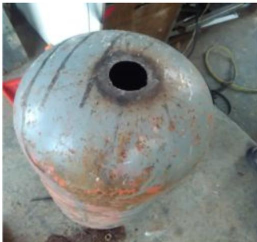
**Figura 15:** Perforación del cilindro reservorio
