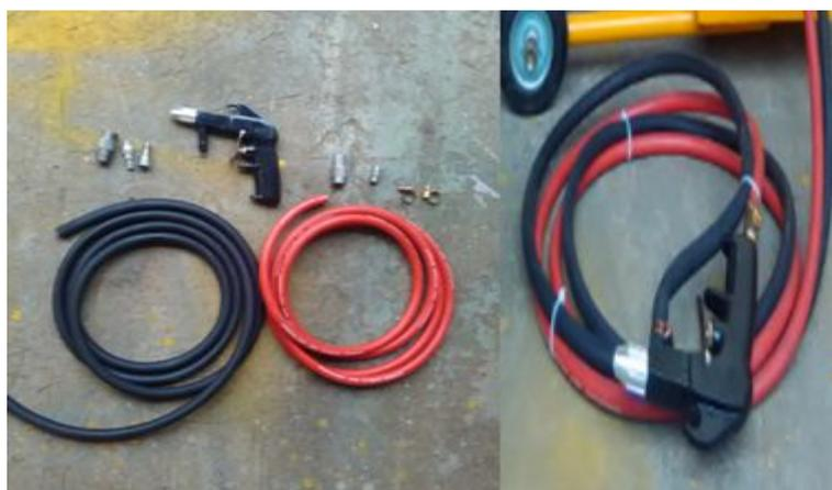
**Figura 34:** Conexión de la pistola de succión a sus respectivas cañerías
