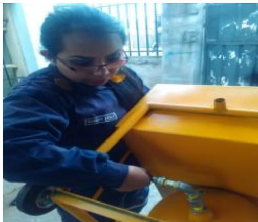
**Figura 33:** Montaje de accesorios inferiores del cilindro contenedor de arena
