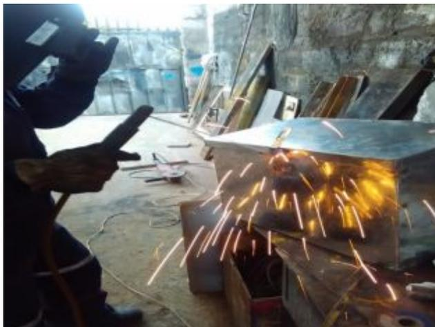
**Figura 25:** Instalación de la aldaba de seguridad
