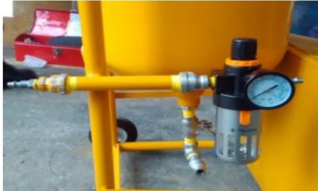
**Figura 31:** Instalación del filtro de aire en la estructura del equipo
