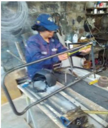
**Figura 19:** Construcción del soporte del equipo
