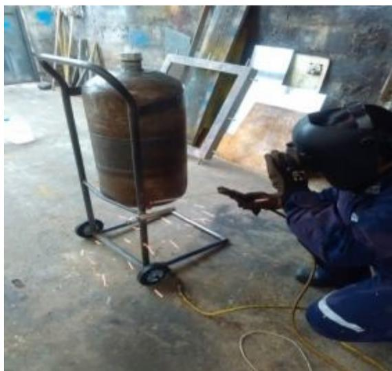
**Figura 22:** Acoplamiento del soporte para el filtro de aire
