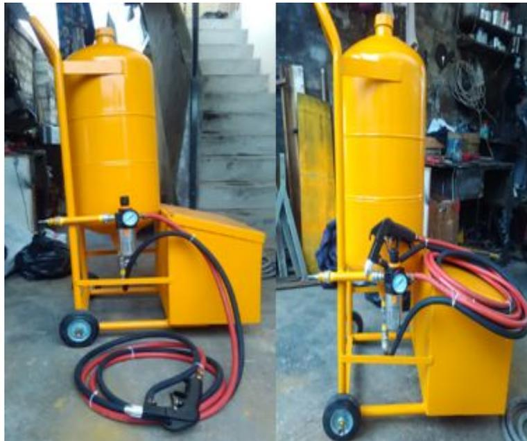
**Figura 36:** Vista del conjunto Mecánico y Neumático instalados
