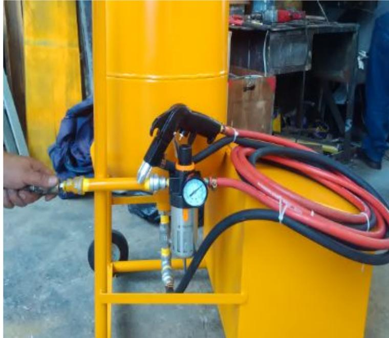
**Figura 35:** Acoplamiento del conjunto de la pistola y cañerías de succión al equipo
