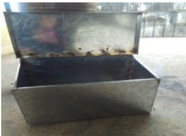
**Figura 24:** Elaboración de la tapa de caja de almacenamiento
