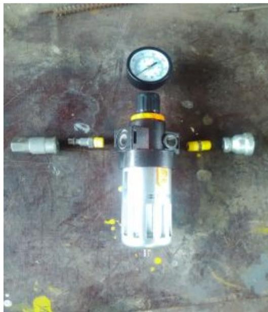
**Figura 29:** Ensamblaje del conjunto de filtrado de aire
