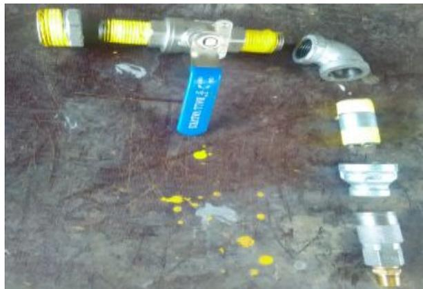
**Figura 32:** Ensamblaje de accesorios inferiores del cilindro contenedor de arena
