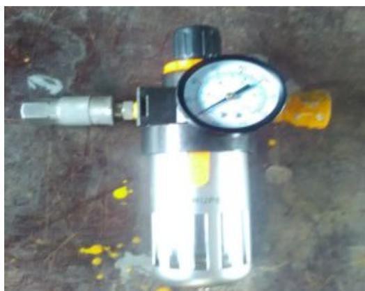
**Figura 30:** Verificación de ensamblaje del conjunto de filtrado de aire
