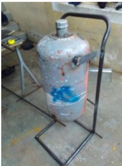
**Figura 21:** Sujeción del reservorio de arena a la estructura de soporte
