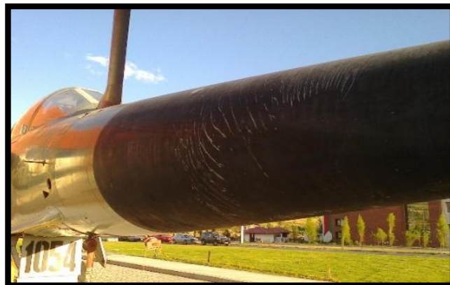
Figura 35 Radome del avión con impurezas
