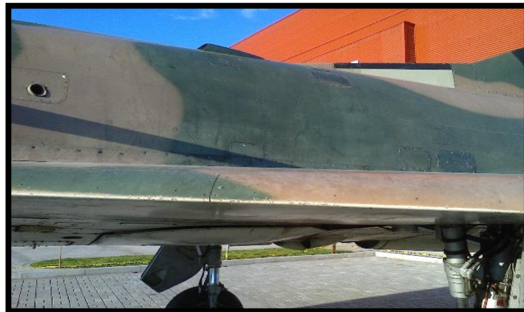
Figura 36 Fuselaje con contaminaciones
