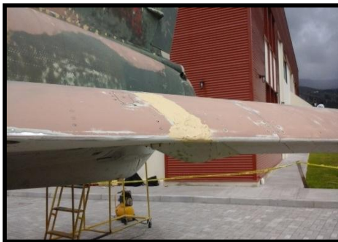
Figura 50 Área del ala izquierda masillada
