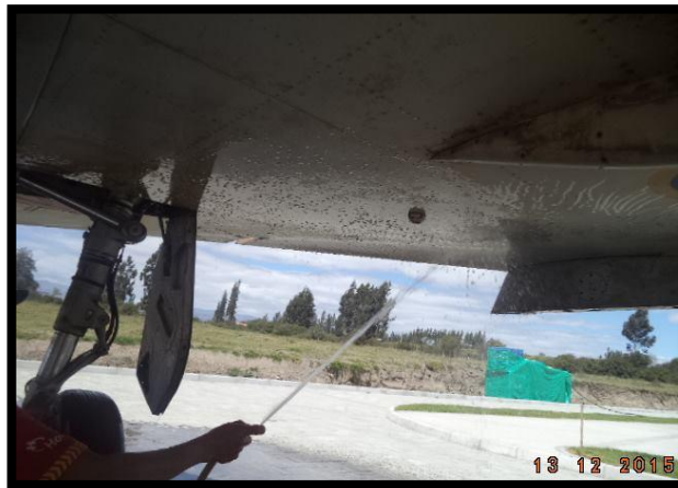
Figura 37 Lavado de la parte inferior del fuselaje
