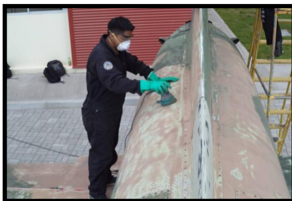
Figura 40 Decapado del lado derecho del fuselaje
