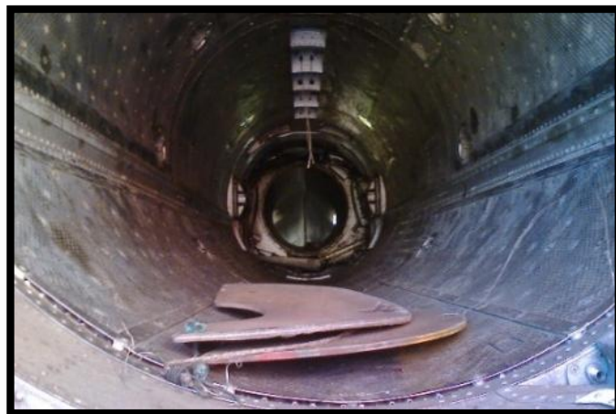
Figura 34 Compartimento del motor con elementos residuales
