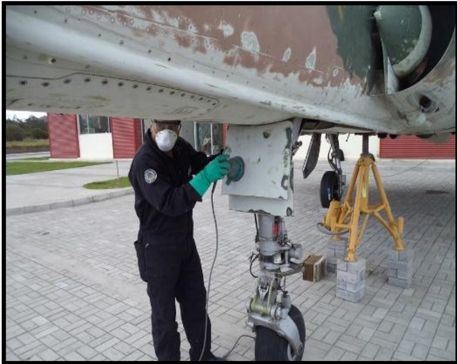
Figura 47 Decapado del tren de aterrizaje auxiliar
