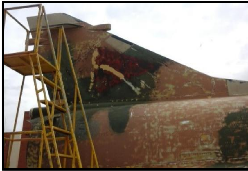
Figura 51 Área del empenaje masillada
