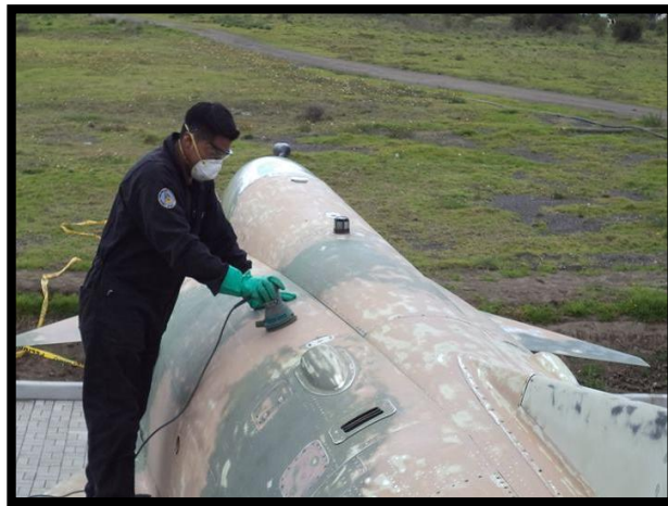
Figura 41 Decapado del lado izquierdo del fuselaje
