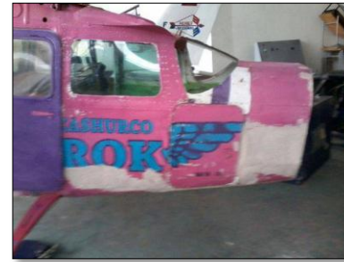
Aplicación de primer sobre el fuselaje
