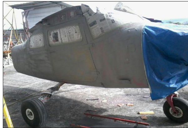
Aplicación de primer sobre el fuselaje
