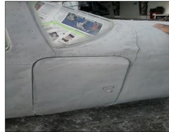
Aplicación de primer sobre el fuselaje
