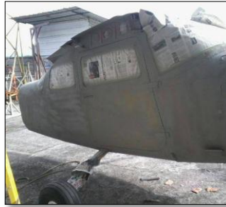
Aplicación de primer sobre el fuselaje
