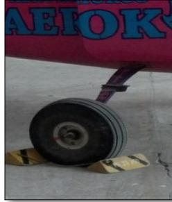
**Figura 14 Tipo de tren fijo del avión Cessna 182 HC-CDL**
