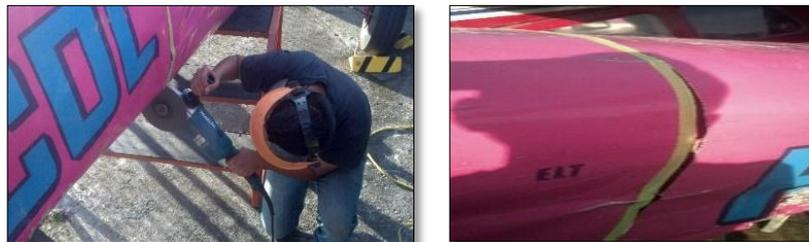
**Figura 26 Segmentación del fuselaje de la aeronave Cessna 182 HC-CDL**
