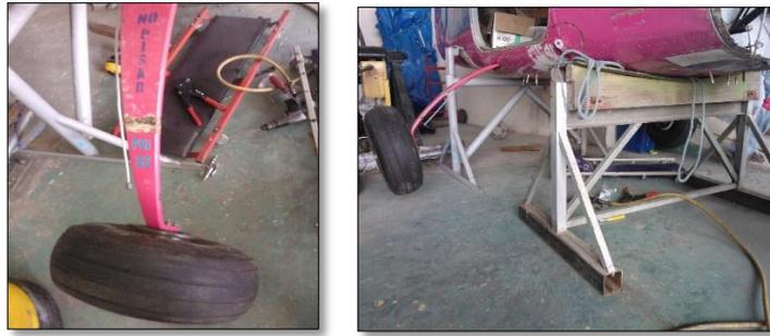
**Figura 48 Montaje del tren principal de la aeronave.**
