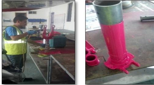
**Figura 35 Capado del tren de aterrizaje auxiliar**
