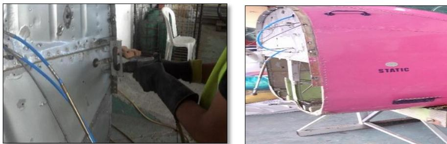
**Figura 28 Desmontaje de la lámina frontal inferior de la pared de fuego de la aeronave Cessna 182 HC-CDL**
