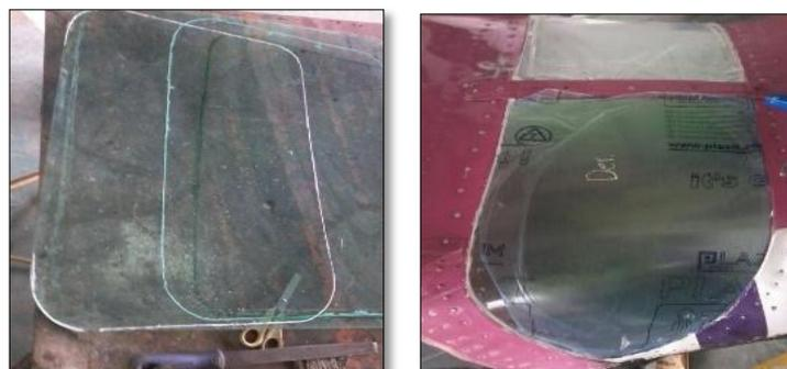
**Figura 61 Ubicación de las micas en las ventanas posteriores de la aeronave**
