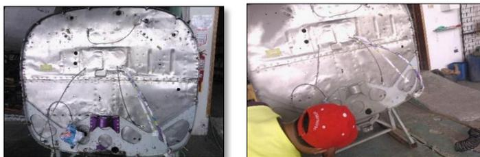
**Figura 31 Decapado de la parte frontal de la aeronave**
