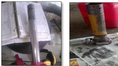
**Figura 34 Aplicación del primer sobre el tren de aterrizaje auxiliar**
