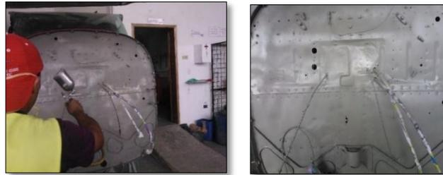
**Figura 32 Aplicación del primer en la pared de fuego**
