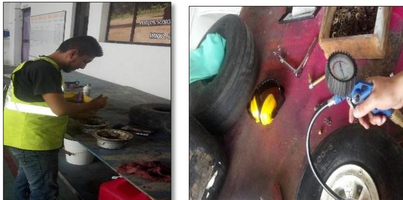
**Figura 37** Mantenimiento de la rueda y neumático del tren auxiliar
