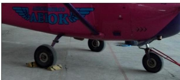
**Figura 4 Tipo de tren de aterrizaje del avión Cessna 182 HC-CDL**
