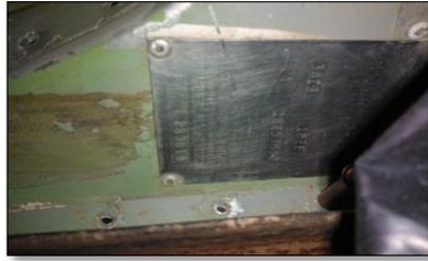
**Figura 24 Placa de identificación del fuselaje de la aeronave Cessna
